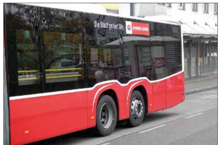
Bakre vagnsdelen har två axlar, som hos en treaxlig 15-metersbuss, vilket också konstruktionen hämtats från. Tredje axeln driver (tvillingmontage), fjärde är styrd (enkelhjul).
