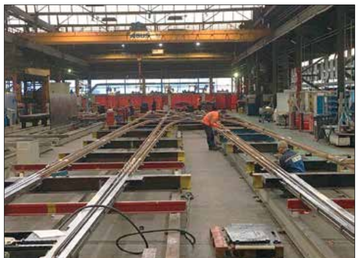
Innan kryssväxeln levererades i mindre delar till Sverige besiktigades komplett på plats i Luxemburg. Foto: Faegh Adel Pour
