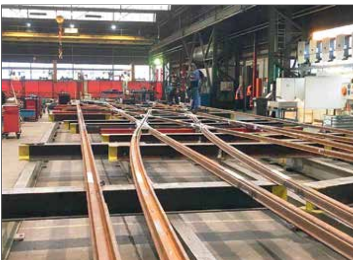
Kryssväxeln byggdes upp komplett hos tillverkaren Vossloh Cogifer i Luxemburg. Foto: Faegh Adel Pour
