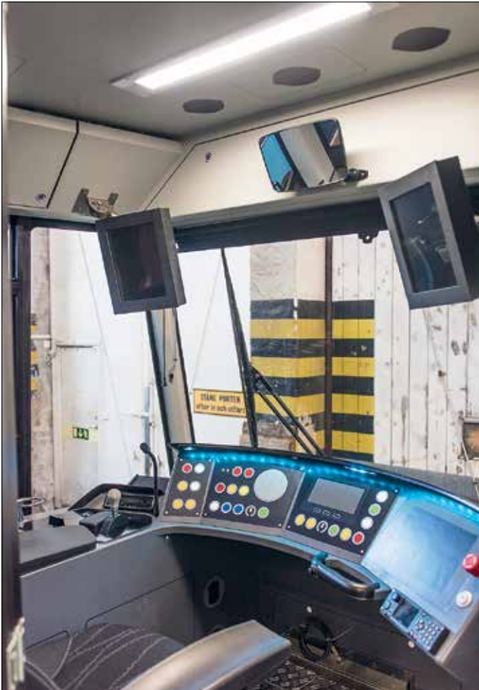
Förarplatsen har utvecklats med stor omsorg. Notera placeringen av bildskärmarna för videobackspeglarna. Samma blickriktning eftersträvas som vid konventionella backspeglar. Bild från fullskalemodellen.
