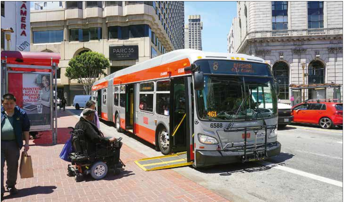
Buss med motoriserad rullstolsramp i funktion på Market Street.
