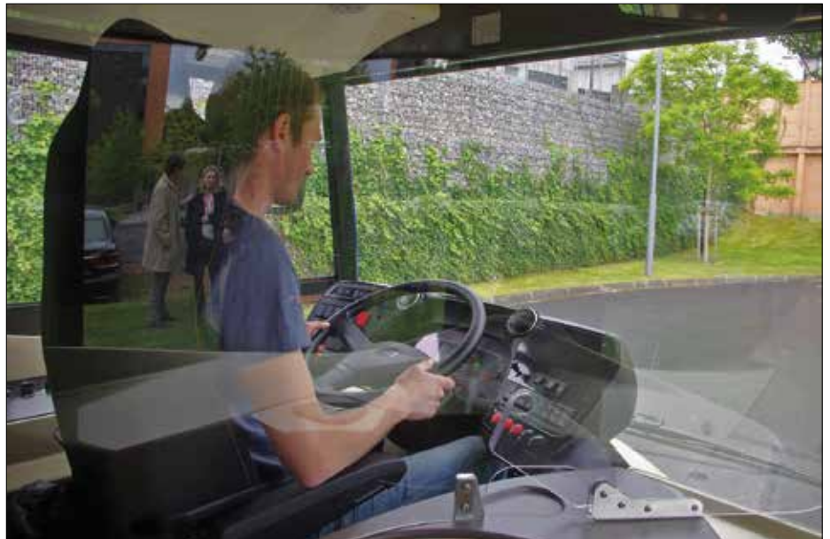
Förarplatsen i den nya batteribussen Aptis. Man noterar, med viss förvåning, myntbordet vid förarplatsen. Betalning till föraren är möjlig, utan att blockera ingångsfilen.
