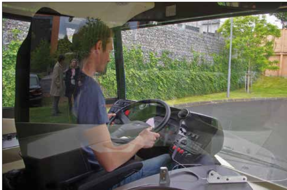
Förarplatsen i den nya batteribussen Aptis. Man noterar, med viss förvåning, myntbordet vid förarplatsen. Betalning till föraren är möjlig, utan att blockera ingångsfilen.
