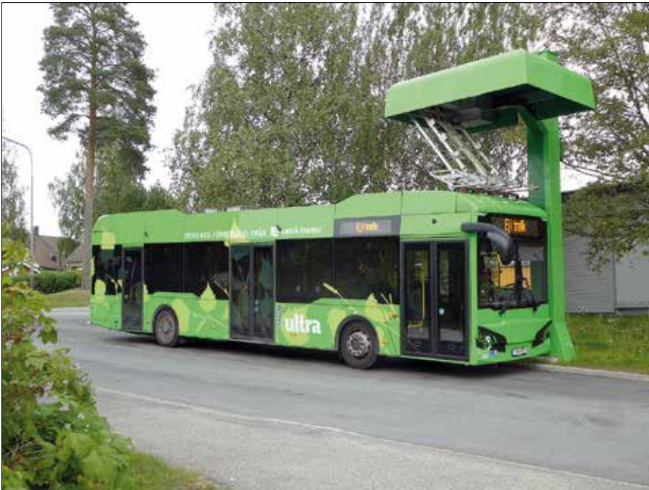
Transdev 8005 laddar batterierna på ändstationen i Carlshöjd. Observera att laddning inte sker på hållplats för påstigande utan mellan avstignings- och påstigningshållplatserna.
