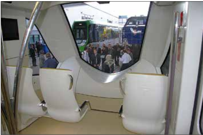
En avdelning i metrotåget för Riyad har säten i bredd – mycket lyxigt med bara 2 + 1 sittplatser om man betänker att korgen är 2,74 meter bred! Alstom och Bombardier kommer att leverera tunnelbanetåg som baseras på samma design till Riyads linjer 3 till 6.
