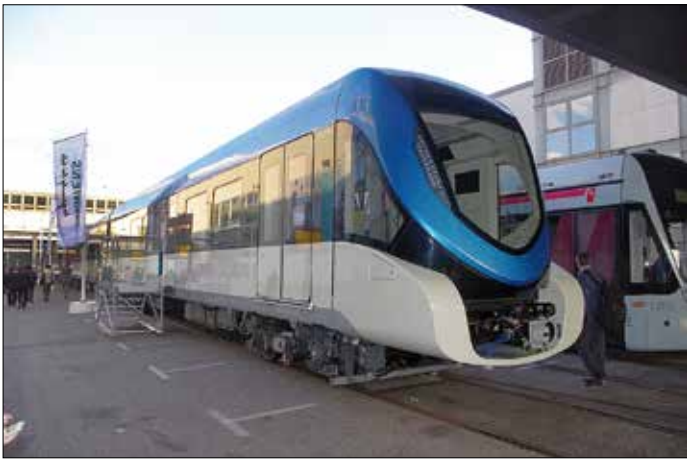
Det förarlösa metrotåget som Siemens levererar till Riyad, med topphastighet på 80 km/h gick inte att missa. Inspiro-tågen till Saudiarabiens huvudstad kommer att finnas i både två- och fyrvagnsversioner.
