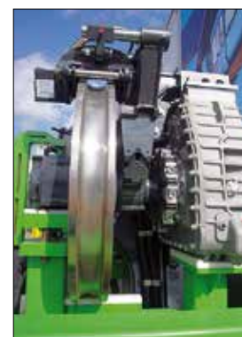
Del av motorboggi avsedd för nya vagnstypen till Wuppertals Schwebebahn. Hjulen har två flänsar, en följd av att spåret består av en enda räl.
