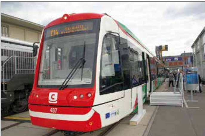
Stadlers (före detta Vosslohs) Citylink-duospårvagnar för Chemnitz. De tredelade tvåriktningsfordonen är 37,2 meter långa, vilar på fyra boggiar, varav två under mittdelen. De kan köras under kontaktledning med 600/750V, och dieselelektriskt med två 390 kW power-packs.
