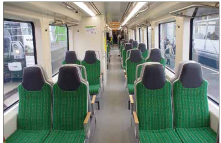
Citylink för Chemnitz är 2,65 meter bred med 2+2-sittning, luftkonditionering, toalett och bagagehyllor. Olika plattformshöjder hanteras (405 mm och 570 mm), men läggolvet är inte helt plant och trappsteg finns över motorboggierna vid vagnsändarna.
