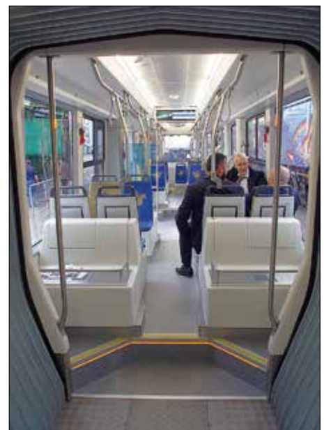
Över varje boggi i nya Twist för Krakow måste man gå ett trappsteg upp och sedan ned eftersom låggolvsdelarna är riktigt låga (300 mm vid dörrarna). Trappstegen, med små inbyggda ljus, syns i alla fall tydligt!
