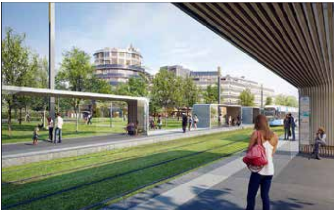
Hållplatsutformning enligt förslag från Systra, med originellt utformade väderskydd och grässpår. Notera frånvaro av staket mellan spåren.
