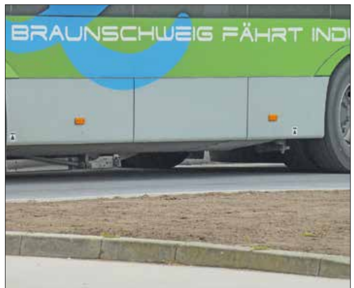
Laddningsutrustningen i nedfällt läge under bussen.
