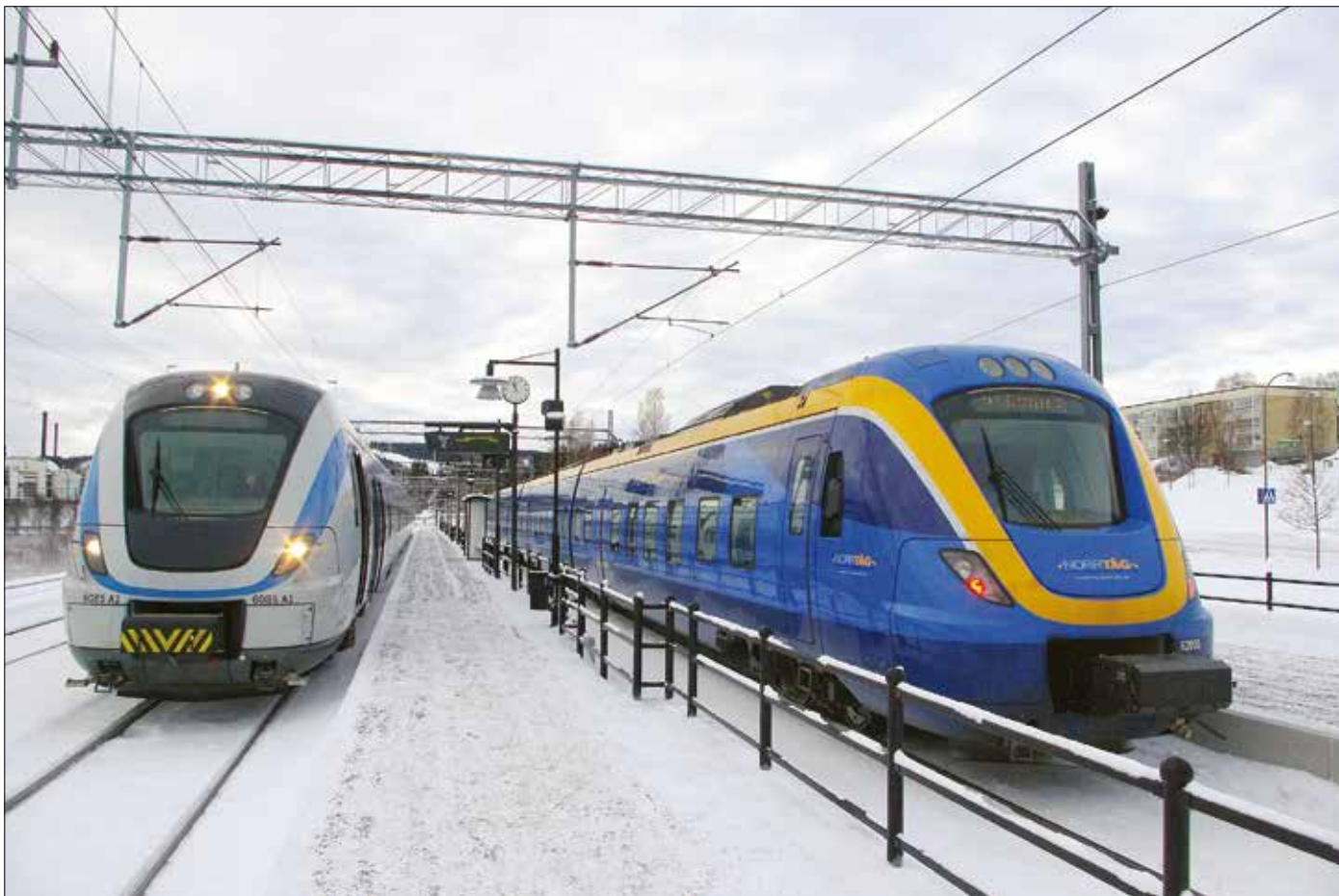
Tågmöte i Timrå. Till vänster det X60B-tåg – 6085 – som användes vid pressresan som ägde rum under provkörningarnas sista dag, den 26 januari, mellan Sundsvall och Härnösand, tur och retur. Till höger en nära släkting hos Norrtåg, X62 - 62010, båda tågen är av typ Coradia Nordic, som tillverkas av Alstom i Salzgitter.
