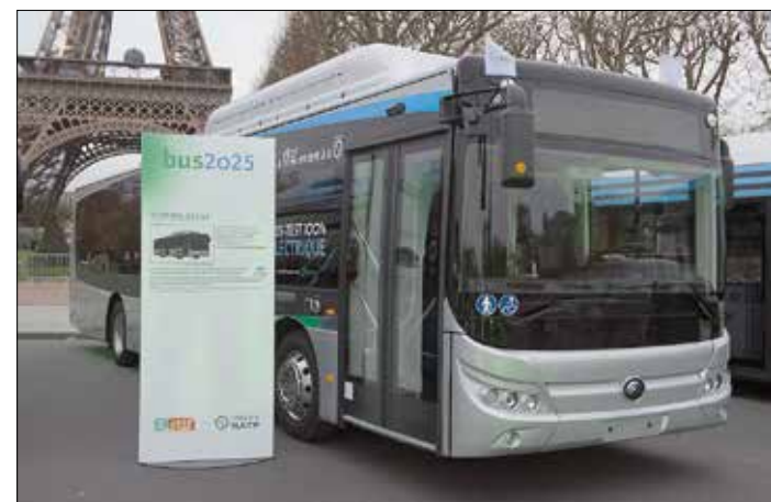
En tolv meters elbuss med litiumjonbatterier är denna E12 LF från kinesiska Yutong och franska Dietrich Carebus, som under januari testas på förortslinjen 147. Foto: RATP, Jean François Mauboussin
