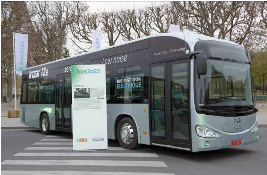
Den spanska busstillverkaren Irizar ses av många nog främst som en leverantör av turistbussar, men har även bussar för stadstrafik på programmet. Exempelvis denna I2e, en batteribuss i tolv metersutförande. Foto: RATP, Jean François Mauboussin
