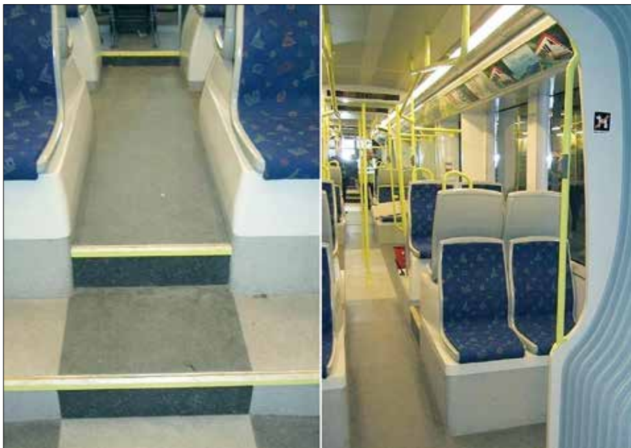
A35-attrapp: Mittgång med två steg över ändboggi + steg till förarhytt. Stolsplacering, hållstöd och golvlutningar över mittboggi. Foto: Ragnar Thörnblom
