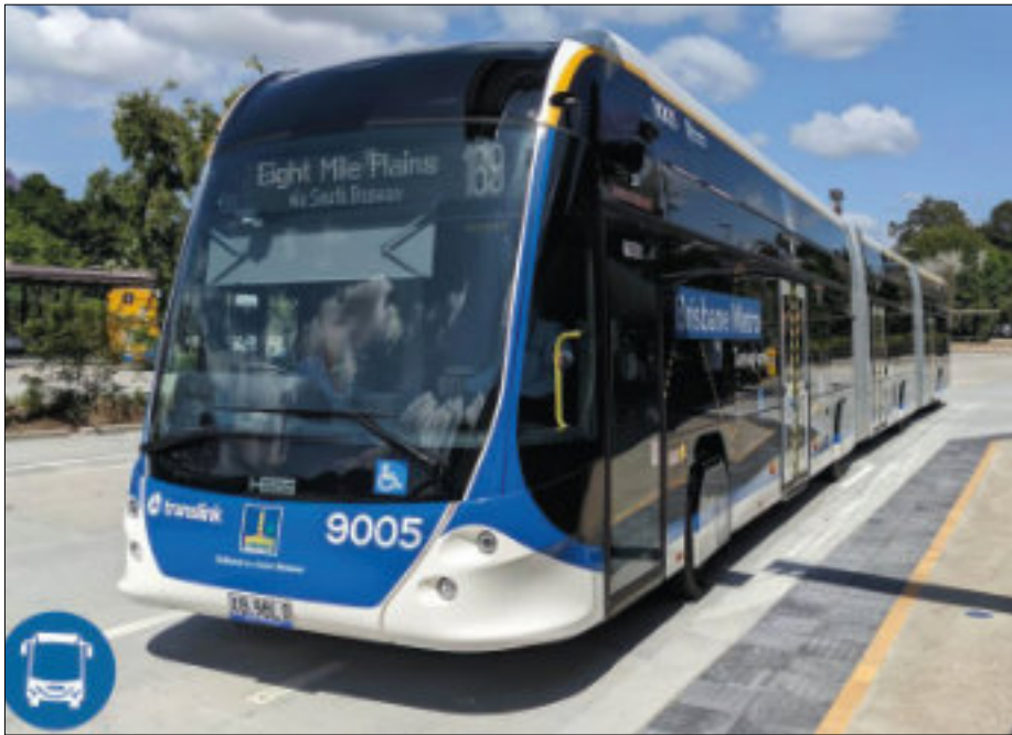
Dubbelledad batteribuss med laddsystemet Tosa, byggd för Brisbane Metro, ett busstrafiksystem i Brisbane, Australien, där det råder vänstertrafik. Foto: Carrosserie Hess AG
