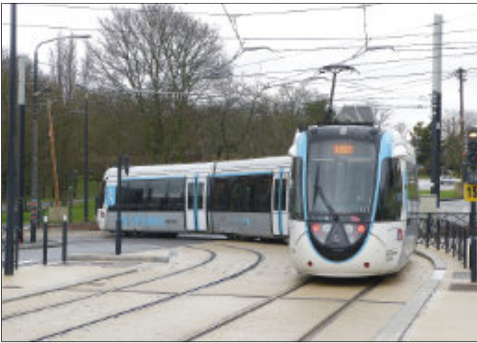
Dualis förmåga att klara riktigt skarpa kurvor, som här i Clichy-sous-Bois, är begränsad eftersom boggierna har begränsad vridbarhet, till skillnad mot Avanto.
