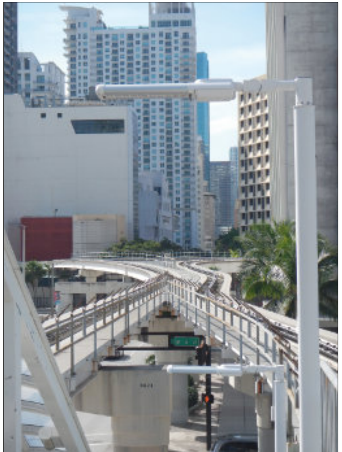
Också här kan man ifrågasätta integrationen i stadsmiljön. Vagnarna rullar på gummihjul och styrs av en centralt placerad räl.
