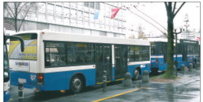
Låggolvssläpbuss efter en trådbuss med högt golv i Luzern. Släpbuss-ekipagen i Luzern har successivt ersatts av dubbelledtrådbussar.
