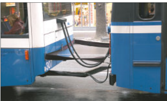
Till vänster: Kopp- lingsanordning mellan buss och släpbuss. De flexibla banden hind- rar passage mellan fordonen. De tre nedre bilderna: Thomas Johansson
