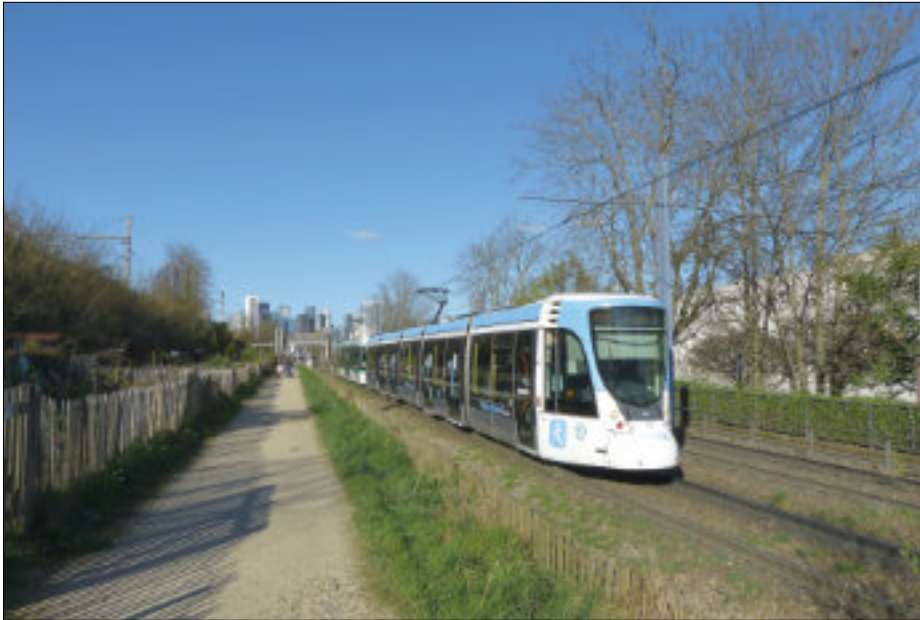
Linje T2 i Île-de-France utnyttjar den tidigare banvallen på järnvägen Puteaux-Issy-Plaine, här i Suresnes. Den kan betraktas som tram-train, i likhet med motsvarande lösningar som finns i Karlsruhe.
