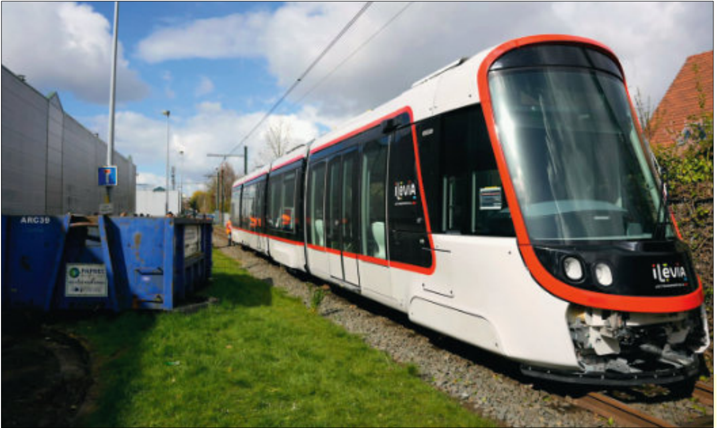
Den första av de 27 beställda Alstom Citadis har i mars 2026 just ankommit till operatören Ilevia i Lille. Denna modell av Citadis har i vagnsändarna under respektive förarplats fullt vridbara boggier. Därmed har vagnstypen bättre gångegenskaper i kurvor än konventionella multiled-spårvagnar. Foto: Métropole Européenne de Lille (MEL)
