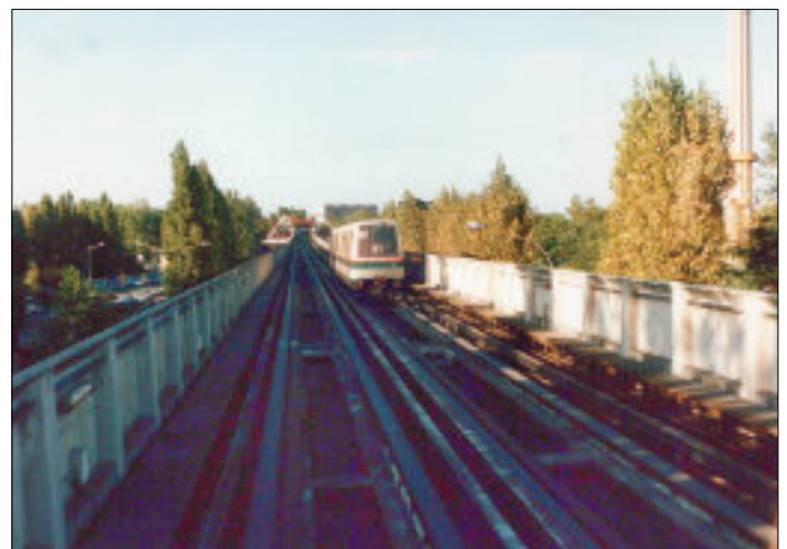
Klassisk vy från automatunnelbanan VAL i Lille, Frankrike. Den går delvis på viadukter. Vagnarna är mycket små, men trafiken mycket tät så kapaciteten är hög. Vagnarna rullar på gummihjul och styrs av sidomonterade horisontella styrullar. Foto: Thomas Johansson
