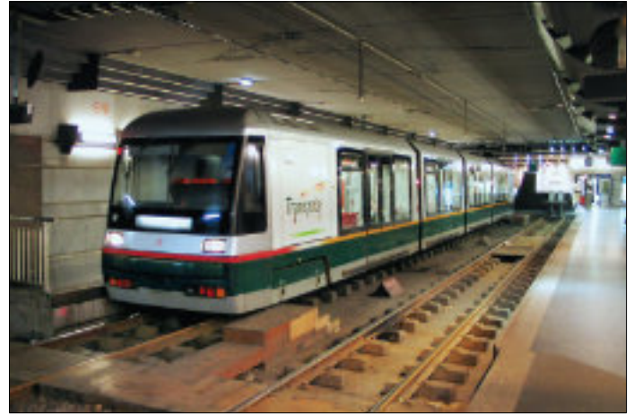
De tyska spårvagnarna ersattes 1994 av 24 stycken nya låggolvsvagnar tillverkade av Breda i Italien. Eftersom det inte fanns plats för elektrisk utrustning under golvet inrättades verkliga apparatrum bakom respektive förarhytt. Att utnyttja vagnstaken var ännu inte aktuellt. Bilden är tagen i den underjordiska ändhållplatsen i centrum av Lille, med ett spår för respektive linje.
