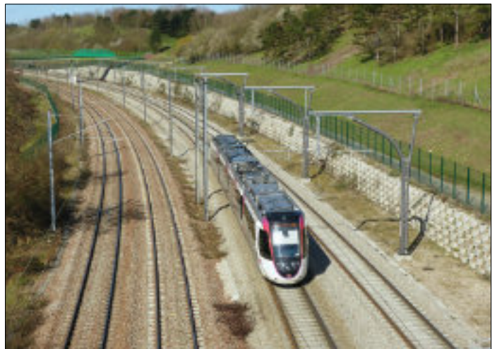
La Courneuve den 11 mars 2018. Till vänster syns spår för godstrafiken på Grande Ceinture. Till höger spår för T11, med egen lastprofil, särskilt signalsystem och trafik enligt reglemente för stadsspårvagnar.
