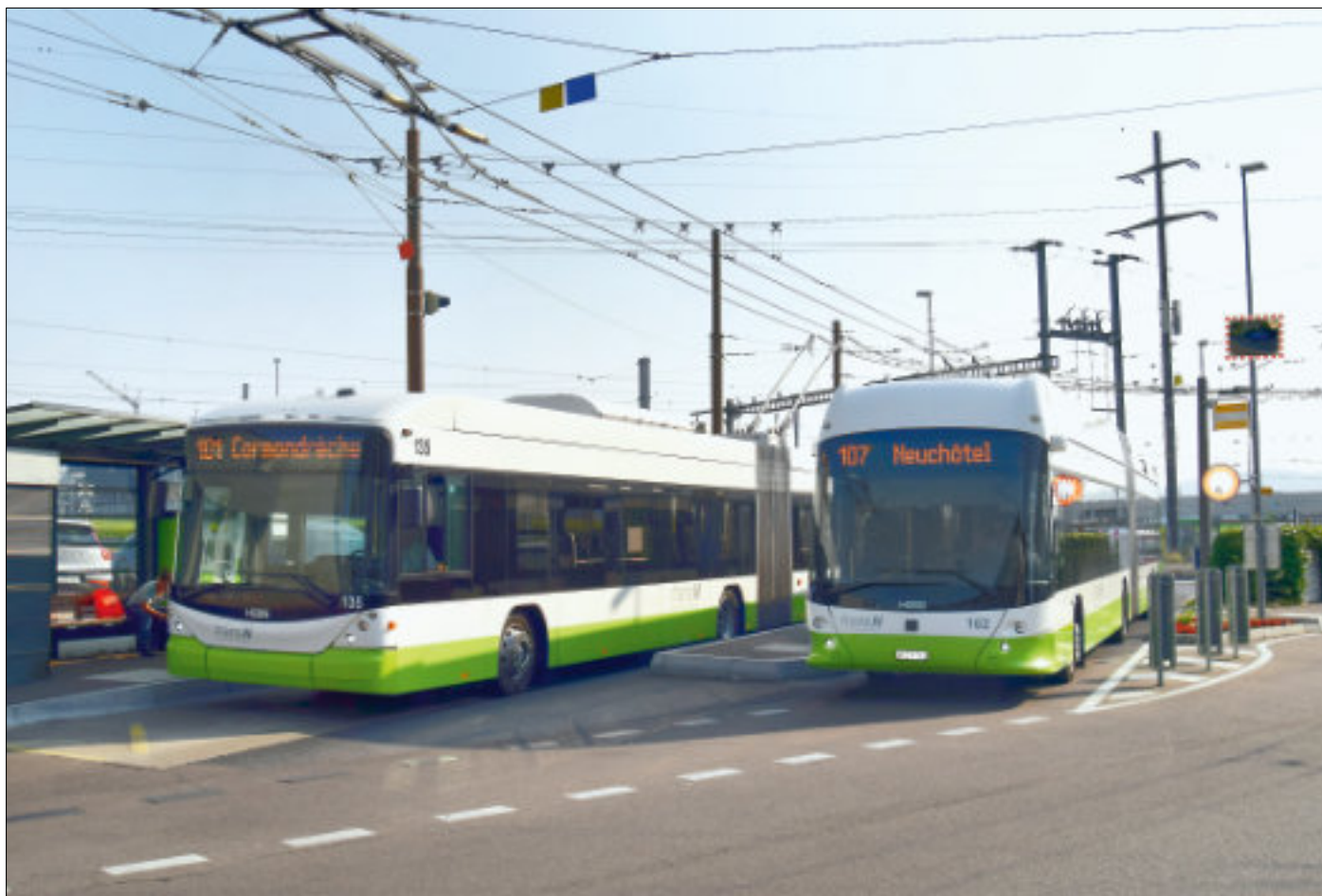
Vid ändhållplatsen Marin Epagnier, Gare, i Neuchâtel står två trådbussar, båda tillverkade av Carrosserie Hess, den vänstra en Swisstrolley ur en serie levererad 2009–2011 och den högra en Lightram 19 DC från 2023. Foto, samtliga där ej annat anges: Nils Zimmermann
