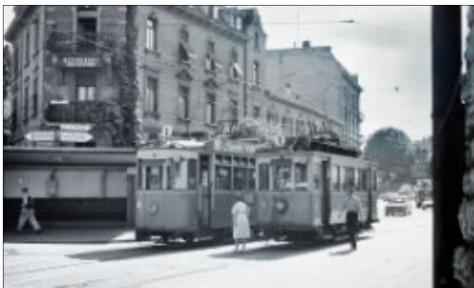
Den 12 augusti 1966 rullade alltjämt de älderdomliga spårvagnarna i Schaffhausen, men den nya tiden är påtaglig, ty ovanför spårvägens kontaktledning har bärträdor för de kommande trådbussarnas kontaktledning just dragits. Foto: Thomas Johansson
