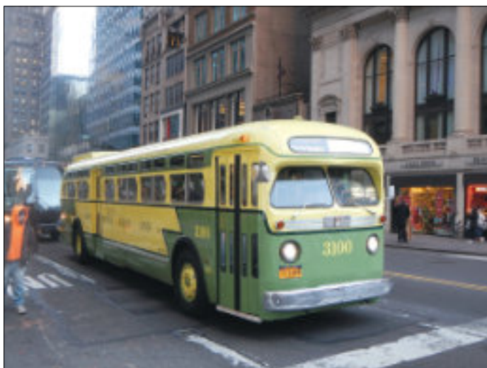
Museibuss nr 3100 i New York är från 1956 och byggd av General Motors. Det sägs vara den första stadsbussen i USA med air condition. Den kördes av Fifth Avenue Coach Company. Likheter med den svenska Metropolbussen noteras, som dock hade Mack som anafader.
