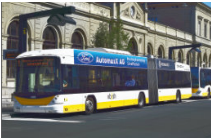
En modern Swisstrolley 3 står här utanför järnvägsstationen i Bahnhofstrasse. Kontaktledningen är nedtagen, istället har massiva laddstolpar för batteribussarna rests. Notera hur väl underhållen trådbussen är.
