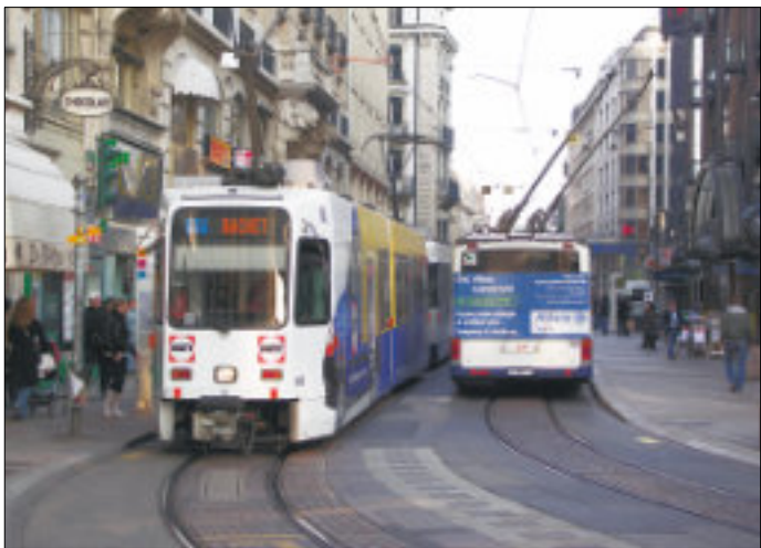
På några stråk i Genève insattes dubbelledtrådbussar när trafiken ökade så att konventionella bussar blev otillräckliga. När belastningen i trådbusstrafiken ökade och började nå kapacitetstaket ersattes bussarna av spårvagnar.
