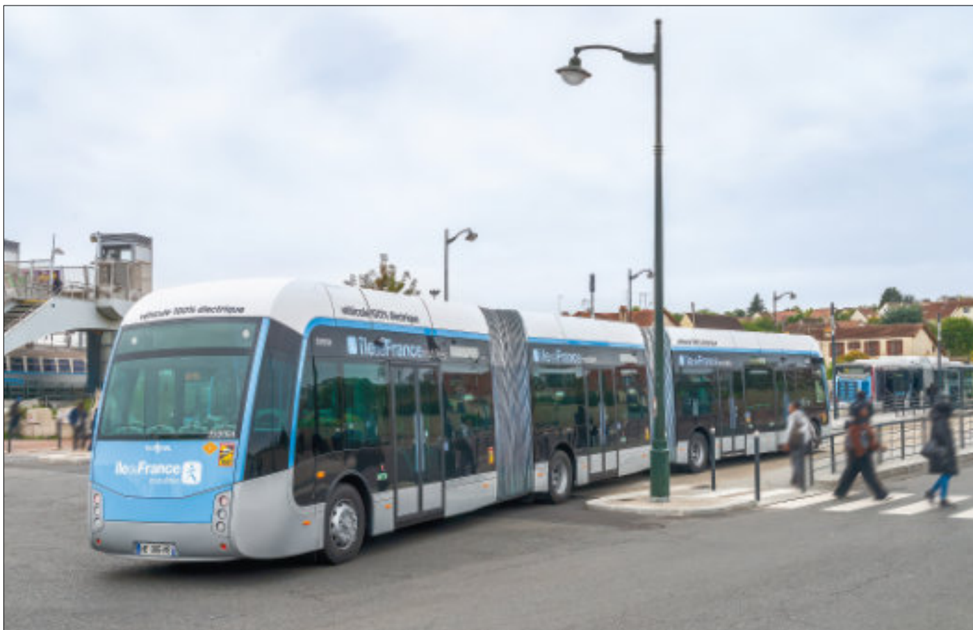
Bussarna kan ta upp till 140 passagerare. De är luftkonditionerade, ljusa, rymliga och har breda svängskjuddörrar för korta hållplatsuppehåll med snabb på- och avstigning.
