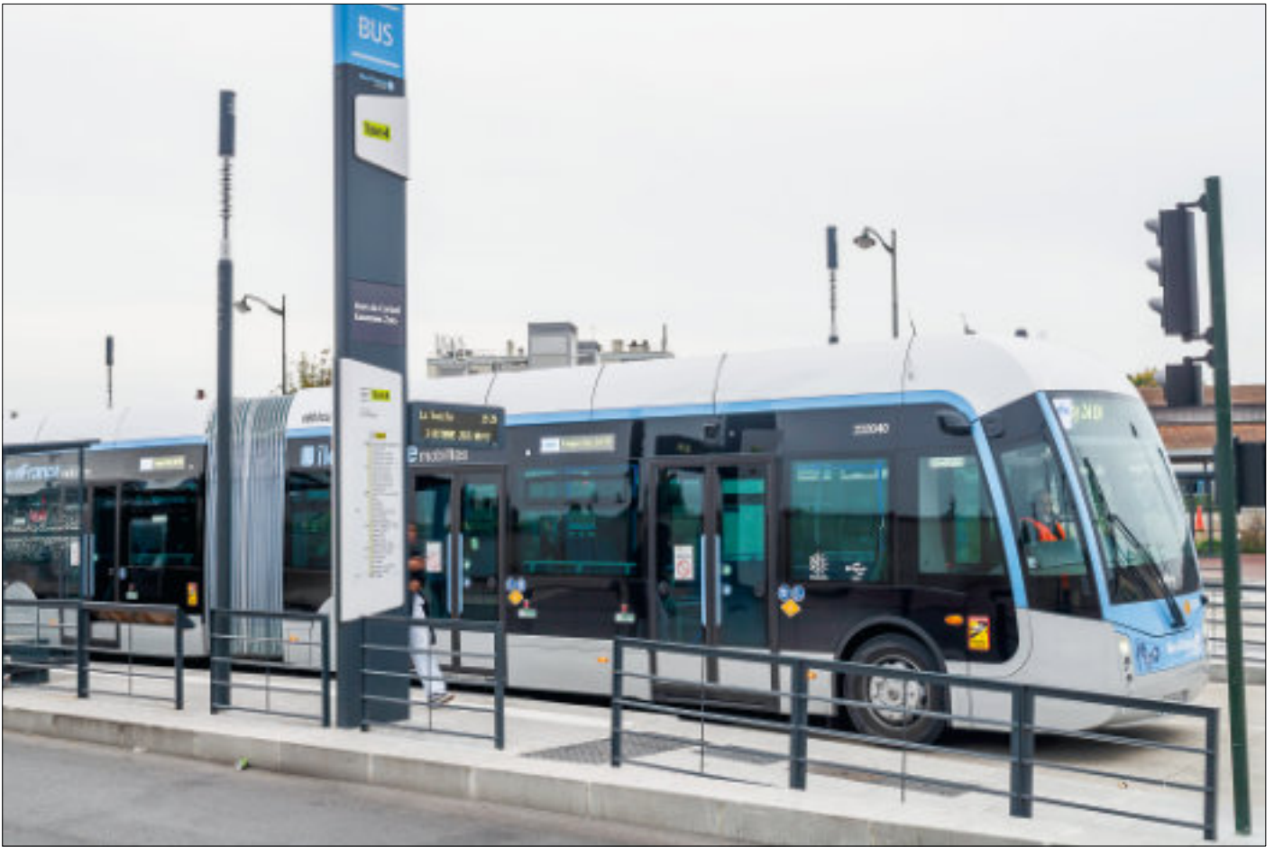
Den nya bussförbindelsen i södra Parisregionen, linje Tzen 4, har den ena ändhållplatsen vid Gare de Corbeil-Essonnes Zola vid närliggande RER-stationen (pendeltåg) där bilden är tagen. Hållplatserna är välutrustade, som vid en modern spårväg. För trafiken finns 30 dubbelledbussar med batteridrift. Foto, samtliga: Sylvain Cambon, Île-de-France Mobilités
