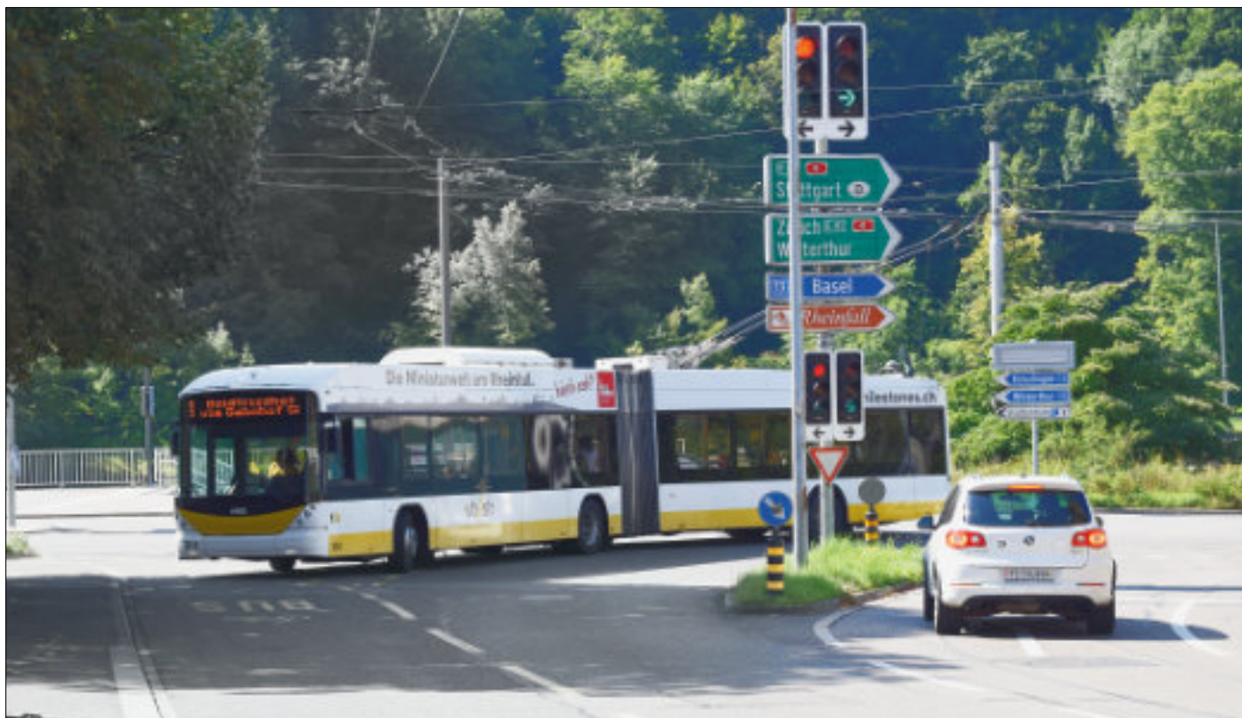
En av de sju låggolvsledtrådbussarna från 2011 svänger i Schaffhausen in på Grabenstrasse, med Rhen i sänkan bakom. Längre in mot centrum bakom fotografen slutar kontaktledningen, strömvagnarna faller ned och färderna går vidare på batteri genom centrum.
