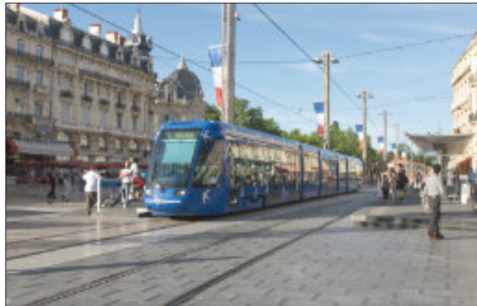
Den sydfranska staden Montpellier återfick spårvagnar den 30 juni 2000, inledningsvis trafik med 29 stycken Citadis 401 (med fullt vridbara ändboggier). Vagnslängd 40,9 meter, vagnsbredden är i Frankrike mycket ovanliga 2,65 meter.
