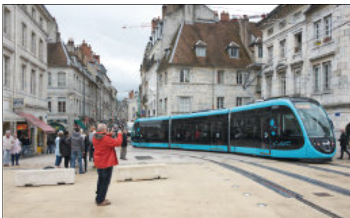
Den 30 augusti 2014 invigdes spårvägssystemet i Besançon, till en blygsam budget. För trafiken levererade CAF 19 stycken Urbos 3 i 23 meters längd, en så kallad kompaktspårvagn. I förgrunden i vägbanan: en dilatationsskarv i kurva för gaturäl; spårbyggarnas överkurs!
