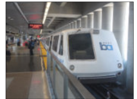
Från internationella flygplatsen på bilden, under centrala San Francisco, därefter på bro över bukten till närläggna Oakland och andra orter, löper lokaltågssystemet BART (Bay Area Rapid Transit). Spårvidden är udda 1 676 mm och elkraft tillförs med tredje skena (1 000 V DC).
