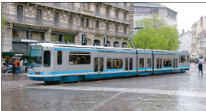
Den franska standardspårvagnen, Tramway français standard , TFS, från GEC-Alsthom. I Grenoble sattes TFS 2 i trafik den 5 september 1987 när den nya spårvägen invigdes. Åren 1986–1997 levererades 53 vagnar. TFS 2 har lågt golv i mittsektionen, men rejält högt golv över ändboggierna. Vagnslängd 29,4 meter, bredd 2,3 meter.
