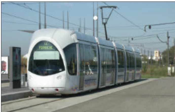
Den 2 januari 2001 återkom spårvägen i Lyon, inledningsvis med 47 stycken Citadis 302. Längd 32,4 meter, bredd 2,4 meter. Idag finns totalt 73 vagnar av denna typ i trafik, jämte 34 stycken av den längre modellen 402, ca 40 meter långa.
