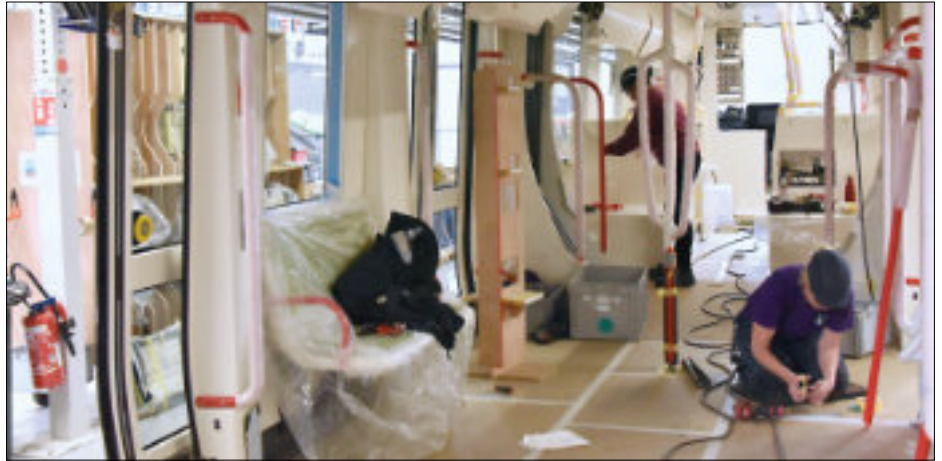
Montering av interiördetaljer i spårvagn för Montpellier.
