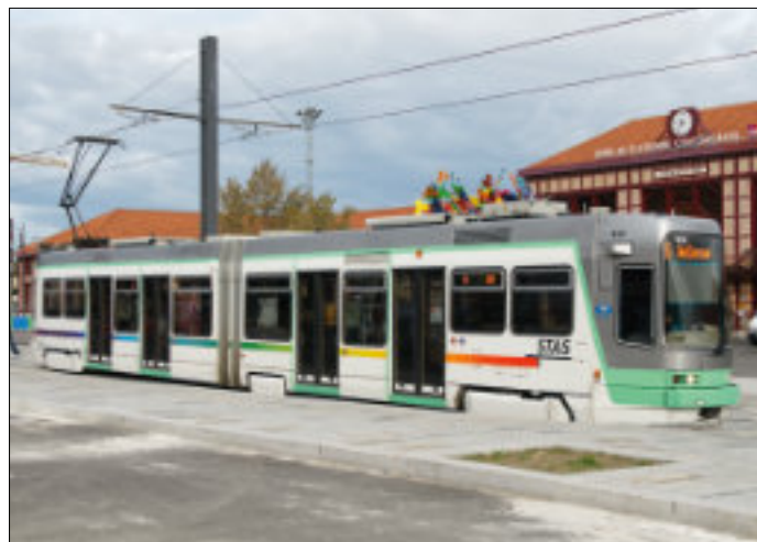
Enriktnings meterspåravn i Saint-Étienne, tillverkad av Vevey-Alsthom-Düweg i två serier, 1991–92 och 1998. Idag finns 27 vagnar i trafik. Längd 22,24 meter, bredd 2,10 meter! Spårvägen invigdes ursprungligen 1881 och har aldrig varit nedlagd.
