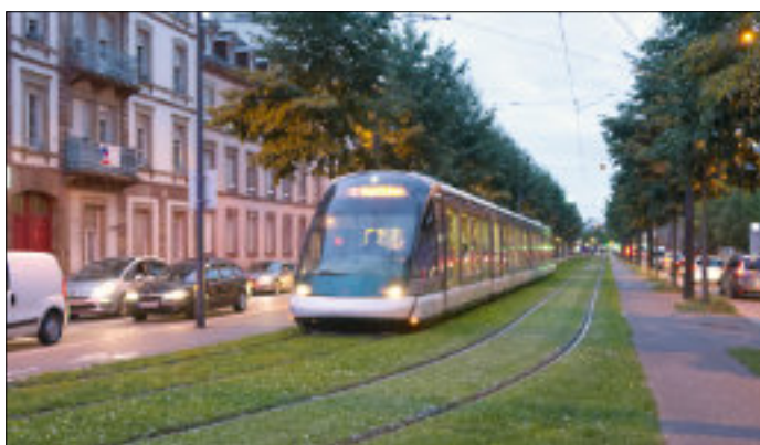
ABB:s ( Adtranz ) Eurotram i Strasbourg sattes i trafik från 1994. Under åren 1994–2000 levererades sammanlagt 53 vagnar, 36 stycken i längden 33 meter och 17 med 43 meters längd. Vagnsbredd alla 2,4 meter. De äldsta 26 har nu skrotats.
