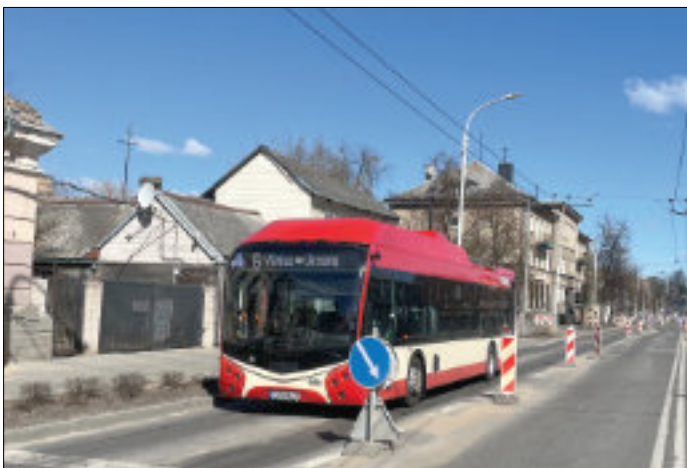
Trådbuss från SOR, Škoda 32Tr, på Kalvariju-gatan med spröten nere. Anledningen var att det pågick omfattande gatuarbeten och att kontaktledningarna delvis hade tagits ned. Linje 6 kördes med nya 32Tr som klarar längre sträckor i batteridrift.
