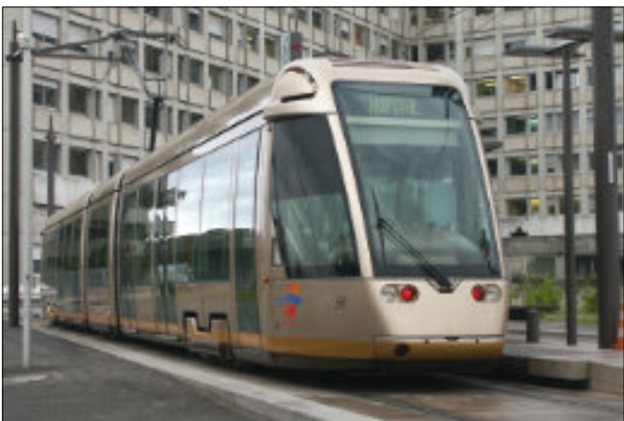
Den 20 november 2000 återkom spårvägen till Orléans. För trafiken fanns då 22 Citadis 301 (med fullt vridbara ändboggier). Längd 30 meter, vagnsbredd udda 2,32 meter. Första nya vagnen fick vagnsnummer 39 eftersom högsta vagnsnumret vid den ursprungliga spårvägen, nedlagd 1938, hade varit 38. Roligt med respekt för det historiska arvet!
