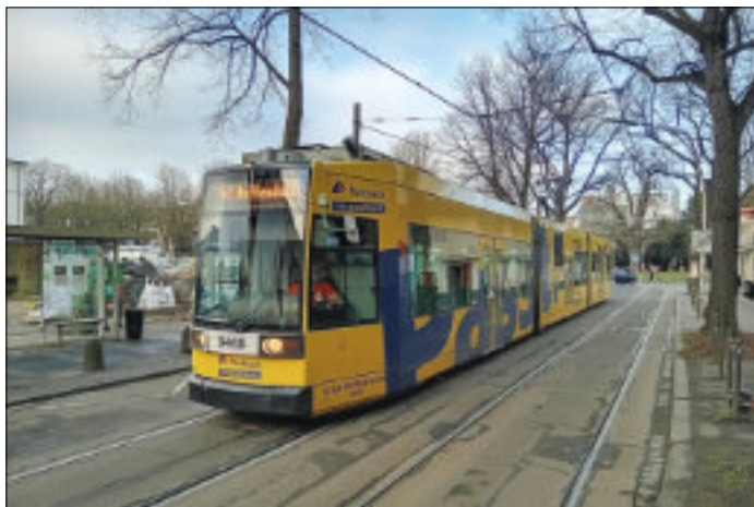
Düwag-vagnen 9468 i Bonn, från 1994, är en av 24 vagnar som flyttas till Poznan i Polen under 2025. Det är en 70-procentig låggolvsvagn. Foto: H Müller
