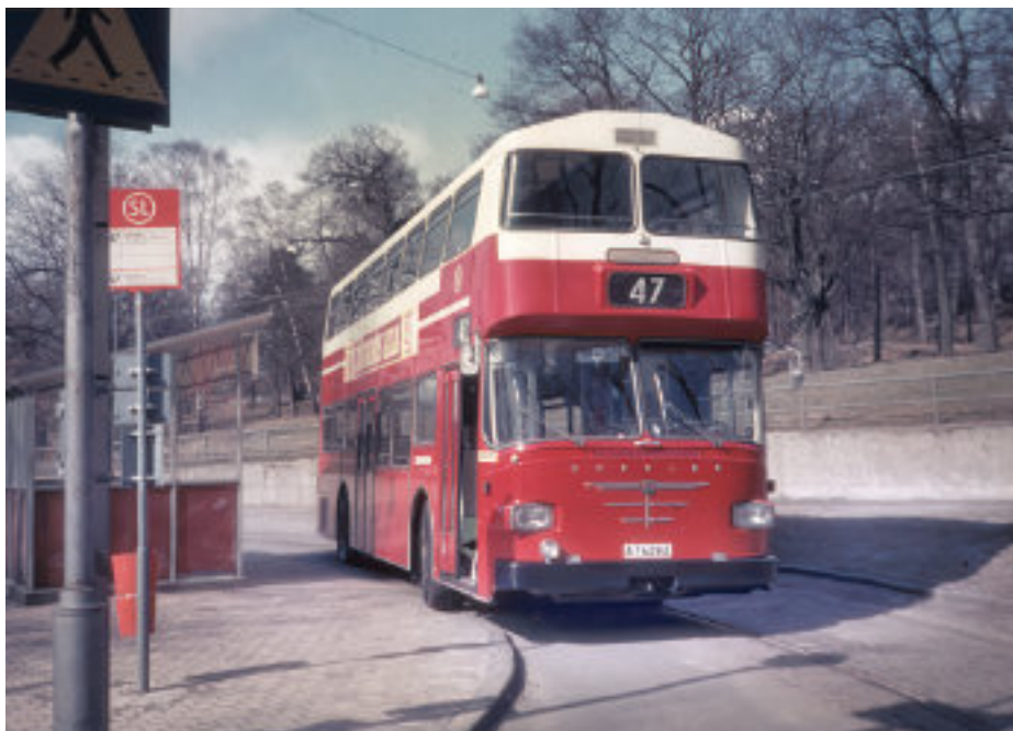
Artikelförfattaren uppskattade att köra dubbeldäckare på linje 54 i Stockholm. På bilden två bussar av märket Büssing, den främre har byggts om från ursprungligt vänstertrafikutförande.
