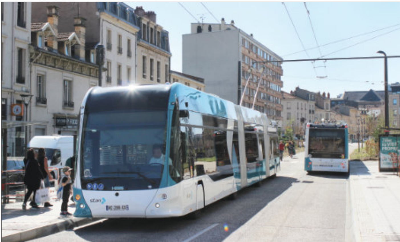
Vid hållplatsen Division de Fer sker växling mellan tråd- och batteridrift. Bussen närmast är i tråddrift snart på väg mot ändhållplatsen Essey Mouzimpré medan bussen till höger i batteridrift just har avgått mot centrum och vidare mot Vandœuvre Brabois-Hôpitaux.
