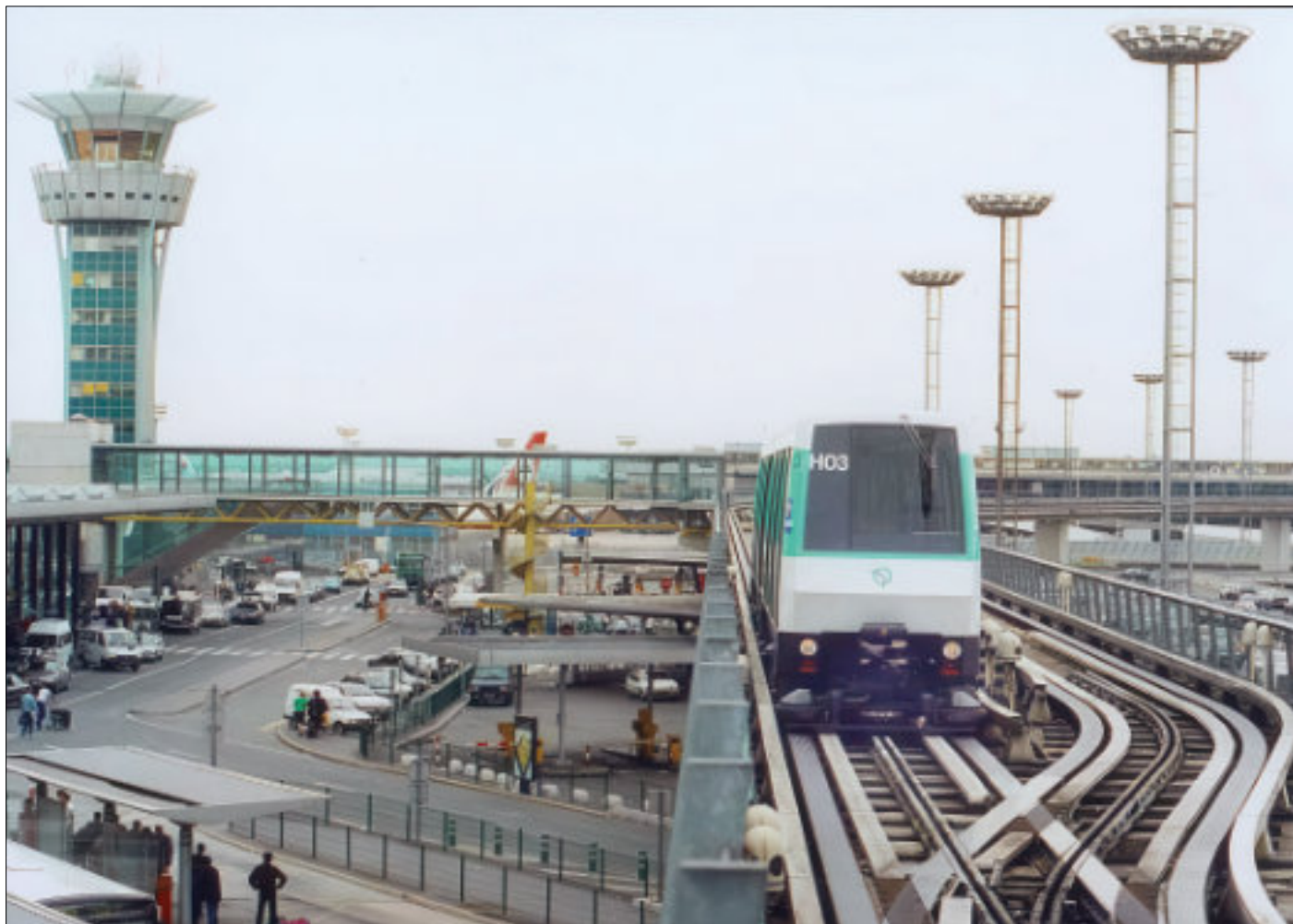
Automatiskt VAL-tåg på flygplatsskytteln Orlyval den 16 maj 1994. Vagnarna rullar på gummihjul och styrs normalt av horisontella styrhjul mot ledplankor. I växlar finns central styrrel. Foto: Bruno Marguerite, RATP
