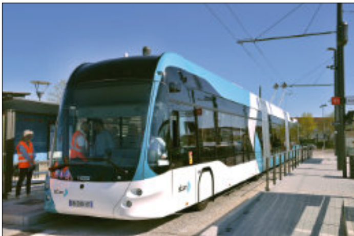
Vid ändhållplatserna finns två alternativt tre avgångs-”spår” i kontaktledningen. Vändningen sker i batteridrift. Strömvagnarna återförs till kontaktledningen med hjälp av ”trattarna”. Manövrering sker från förarplatsen. Foto: Philippe-Enrico Attal
