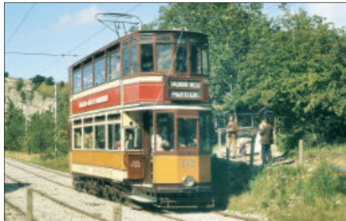
Åren 1927–1929 levererades 50 stycken "Kilmarnock Bogie"-spårvagnar med Maximum Traction-boggier till Glasgow. Spårvägstrafiken utvecklades där 1962. Denna dubbeldäckare är bevarad vid spårvägs museet i Crich.
