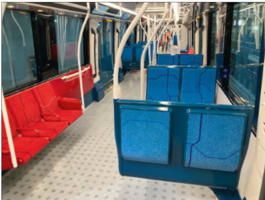
Vagnskorgens bredd på 2,8 meter medger varierande sittplatsarrangemang, med både längs- och tvärgående säten, de i rött avsedda för personer med nedsatt rörlighet. Dessutom erbjuds breda passager genom tåget. Alla säten är utformade för att underlätta säkerhetsinspektion av golvet under, såväl som rengöring av detta.
