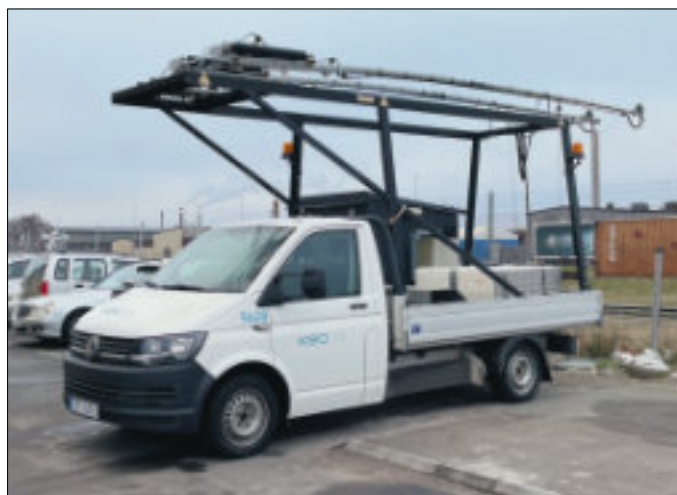
Den "nya" avisningsbilen som avlöst den blå som levererades 2004 är inte helt ny. Det är en pickup av samma typ som den ursprungliga men byggd 2018. Ställningen är den samma som använts tidigare, dock med nya trolleystänger.
