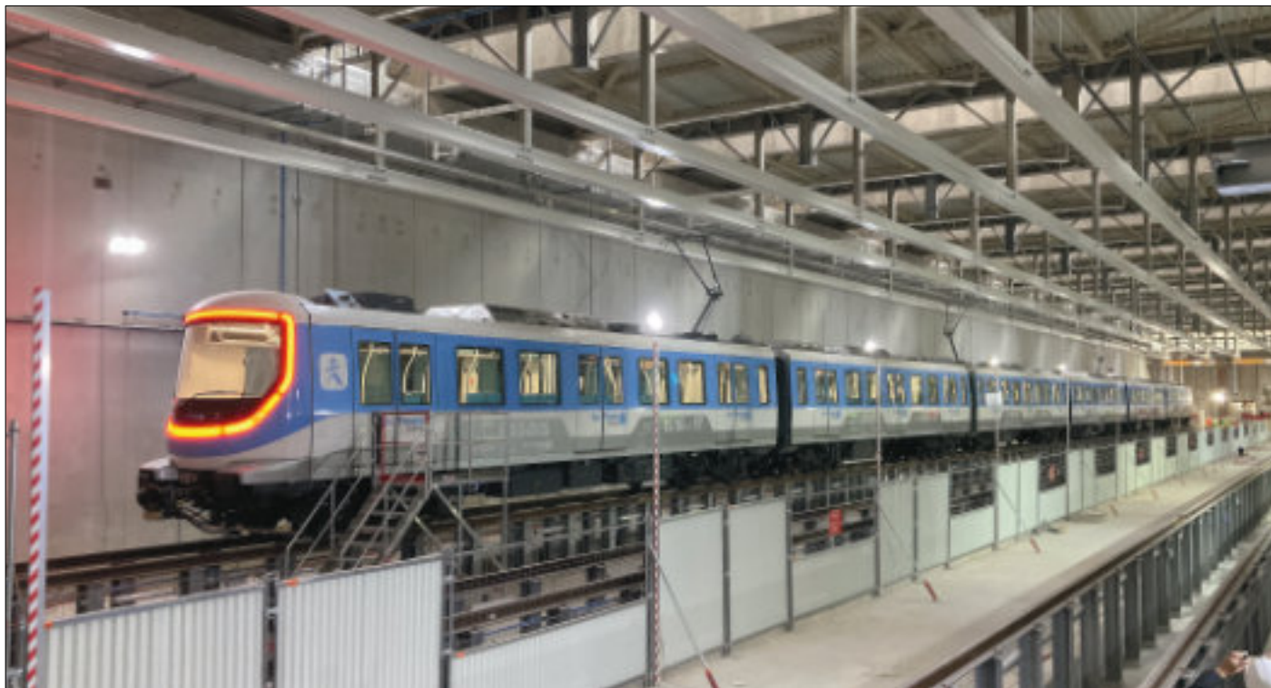
Nytt tunnelbanetåg för Grand Paris Express bestående av sex vagnar i depån i Champigny-sur-Marne. Tåget är avsett för nya tunnelbanelinje 15. Notera takströmvagnarna. Foto, samtliga, där ej annat anges: Patrick Laval
