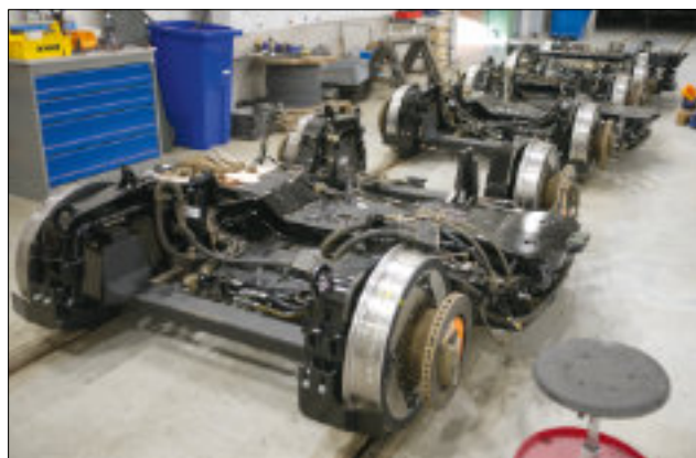
Renoverade boggiar klara för återmontering.
