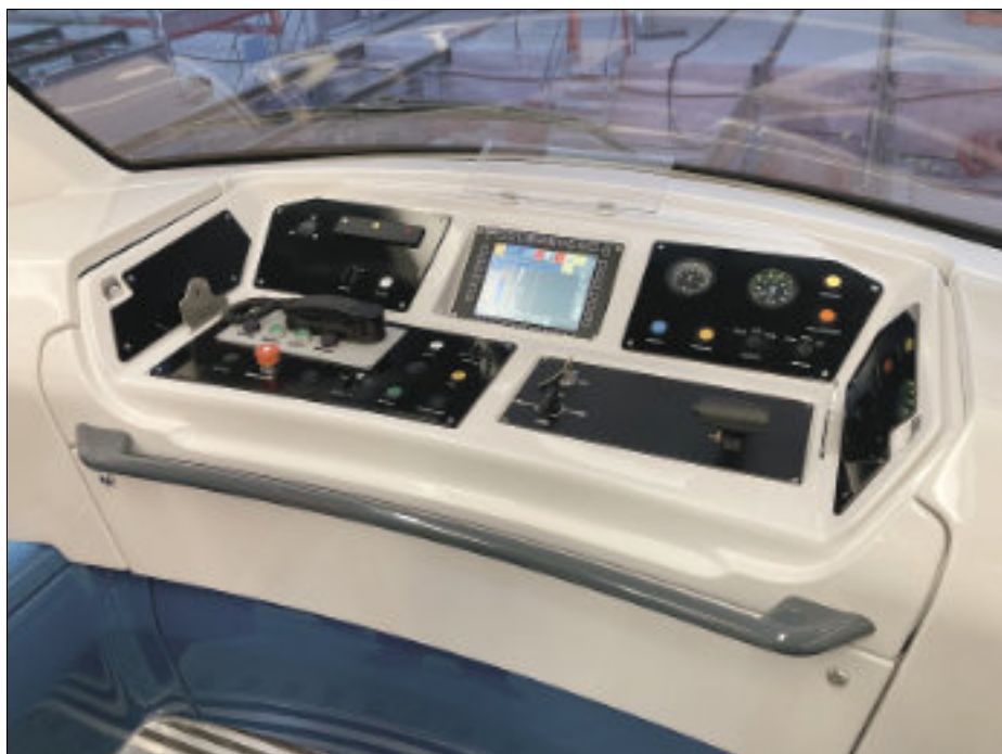
Tågen har inga förarhytter, men ett förarbord är dolt i vagnsändarna. Därmed kan körning tas över av personal vid behov av icke automatisk trafik.
