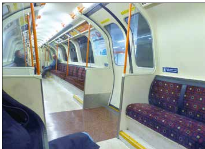
Skjuddörrarna är väl anpassade efter den rundade vagnskorgen och sträcker sig en bit in i takpartiet.
