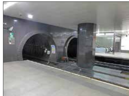
Cirkulärtunnlarna är i begränsat format, diameter endast 11 fot, 3,4 meter.
