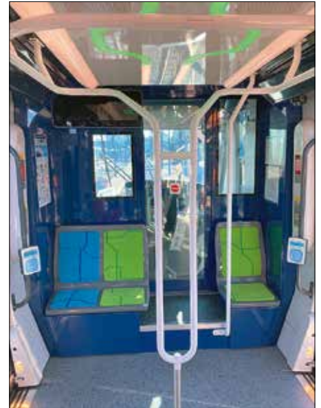
Förarplatsen är på en högre golvnivå och nås från passagerarutrymmet. Under vardera förarplatsen finns fullt vridbara löpboggier.
