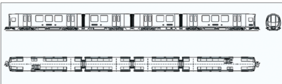
Under det senaste året har 17 nya tunneltåg levererats från Stadler Rail. Vagnskorgarna är av strängspresad aluminium och boggierna är luftfjädrade. Ett komplett tåg har knappt 40 meters längd och blygsamma 2,30 meters bredd. De båda ändvagnarna är motoriserade, löpboggier under mittvagnarna. Sammanlagt motoreffekt är 520 kW och högsta hastighet 58 km/h.
