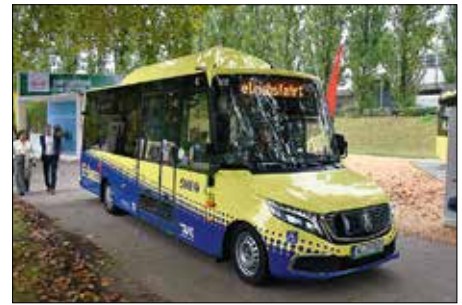
K-Bus från Österrike, också känt som Kutsenis, bygger bussar bland annat baserade på Mercedes-Benz Vito, som denna. Det är en mini-batteribuss som tar 25 passagerare, väger fyra ton och normalt går hos trafikbolaget Regionalverkehr Köln, RVK,
