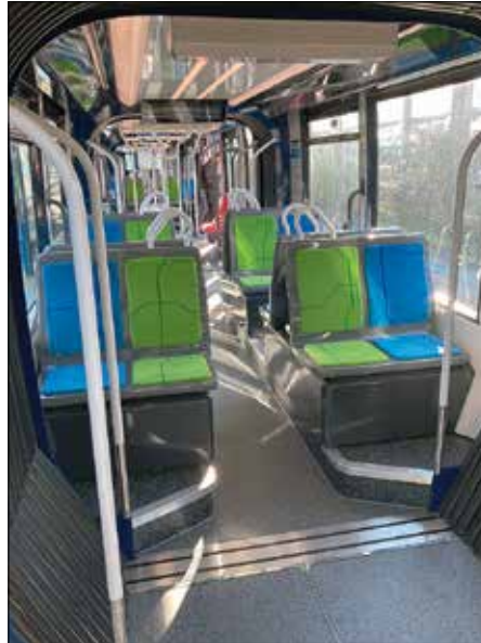
I mittmodulerna finns på konventionellt manner sittgrupper på hjulhusen. Mittboggierna är motoriserade.
