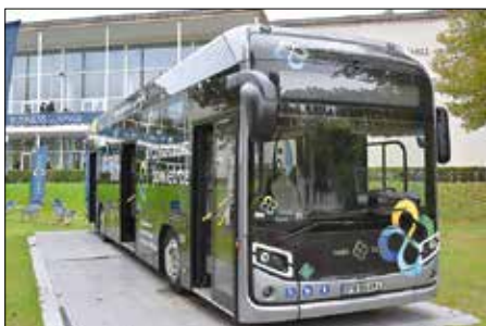
I Polen tillverkas denna bränslecellsbus, Neso-Bus, som uppges ha en räckvidd på 45 mil efter en fulltankning av vätgas. Den i bränslecellen alstrade elektriciteten driver navmotorer i bakhjulen.
