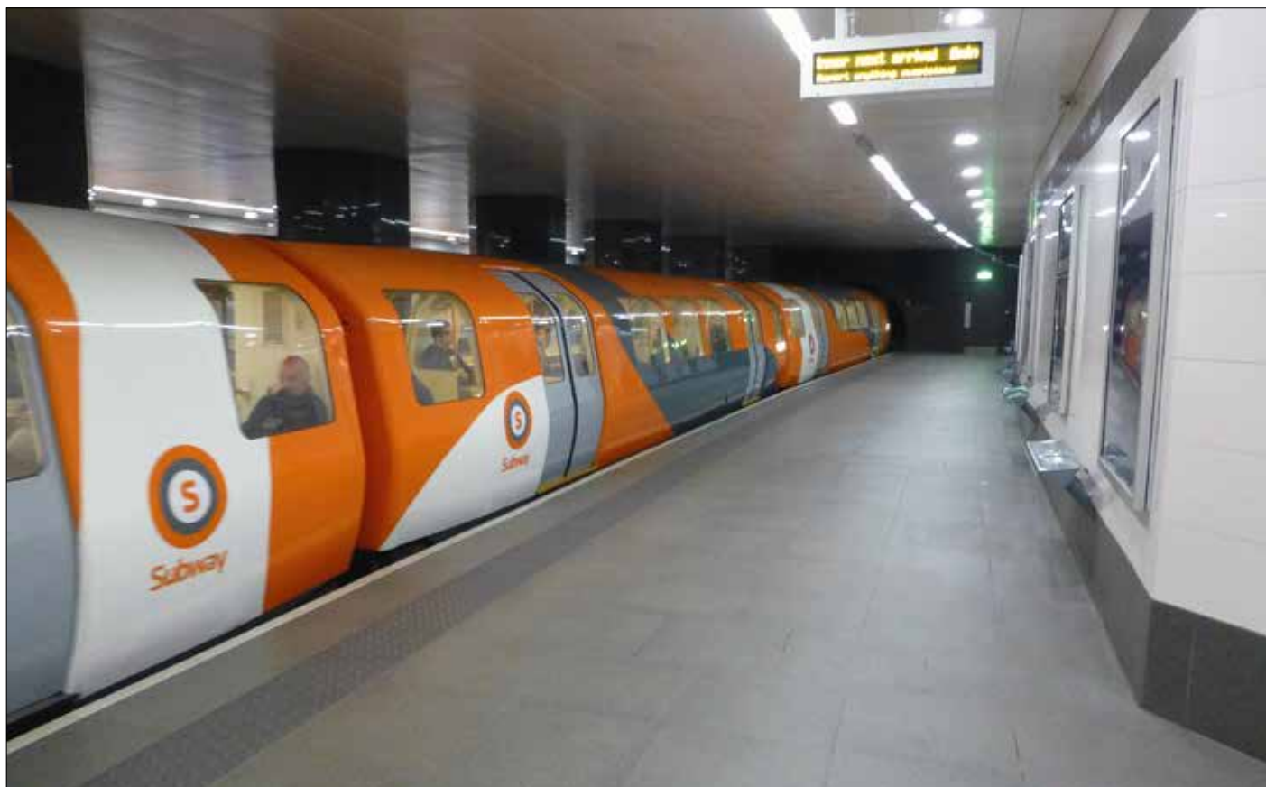
Tunnelbanan i Glasgow är småskalig, med vagnsbredd på runt 2,3 meter. Nu har vagnarna på bilden, tillverkade av Metro-Cammell 1977–1979, från juni i år ersatts av nya från Stadler Rail, bild på nästa uppslag. Foto, där ej annat anges: Leif Stolt
