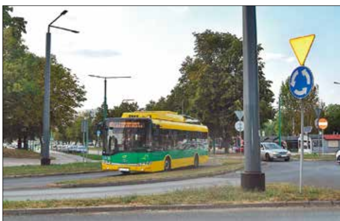
I cirkulationsplatsen "Rondo Cassino", som låg precis utanför författarens hotell, gick trådbussarna i batteridrift, eftersom stolparna byttes ut på platsen. Kontaktledningsnätet var demonterat enbart i själva cirkulationen.
