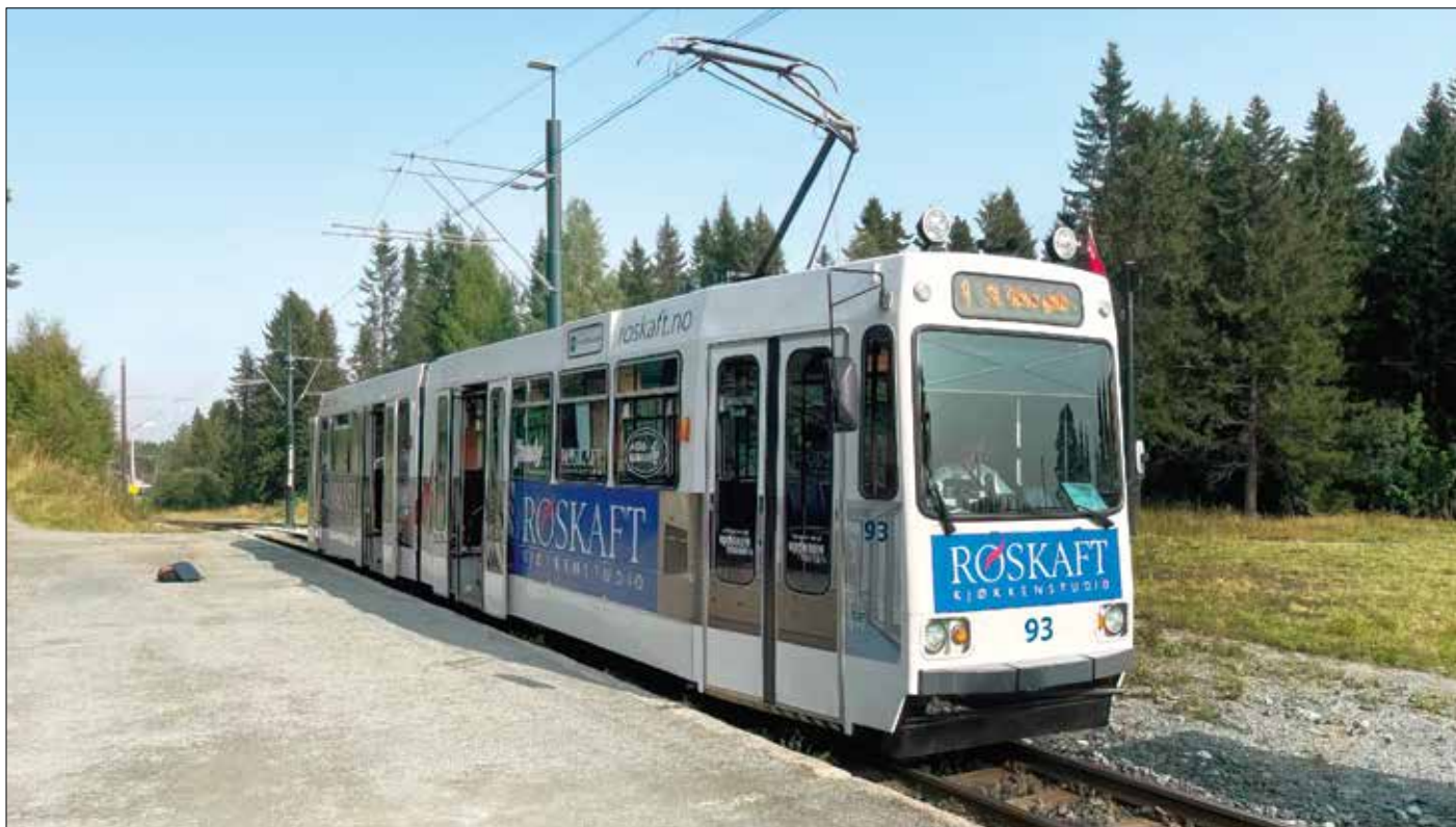
Nuvarande höggolvsvagnar levererades av Linke-Hofmann-Busch, LHB, åren 1984-1985. Golvhöjden är runt 90 cm.
