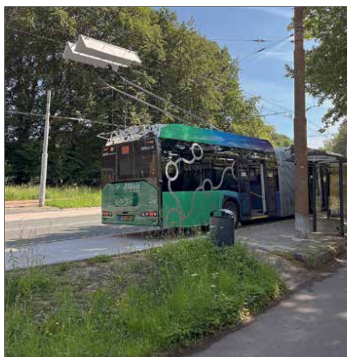
Vid cirkulationsplatsen De Oude Herbergh ansluter trådbussarna från Wageningen till kontaktledningsnätet.
