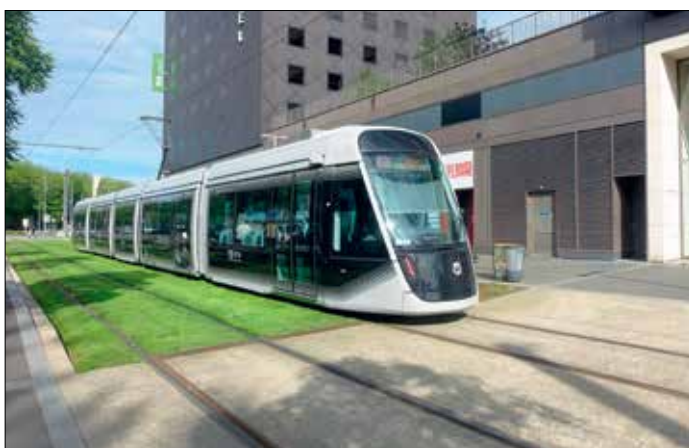
För trafiken i Caen finns 26 stycken spårvagnar av typ Alstom Citadis 305, således femte generationens utförande, i omkring 32 meters längd. Vagnarna har givetvis en design som är unik för just denna stad.
