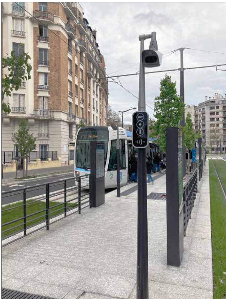
Vid hållplatsen Square Sainte-Odile är det ont om plats. Här finns en ganska smal – men lång – mittplattform, med skilda stopplägen för respektive riktning. Finurlig lösning för hållplatser vid begränsat utrymme.
