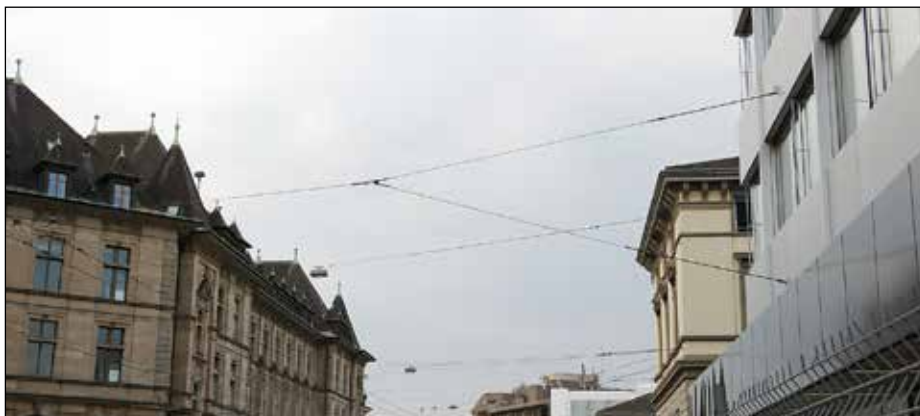
Principen för så kallad hanfot: Begreppet härstammar från den maritima miljön och innebär att bärnan delas i två komponenter vilka fästs ovanför respektive nedanför exempelvis en fönsterrad. Horisontell hanfot är vanligare, exempelvis mellan två stolpar eller väggefästen på skilda hus.
