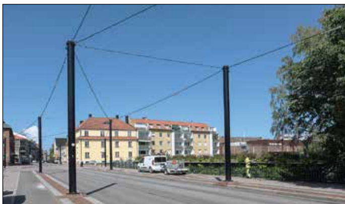
Modern gatubelysning med led-ljus på trådar i Ängelholm. Här tycks inte finnas någon rädsla för att "förfula" gatumiljön med abnormt kraftiga stolpar (svarta) och en mängd trådar kors och tvärs över gatan.
