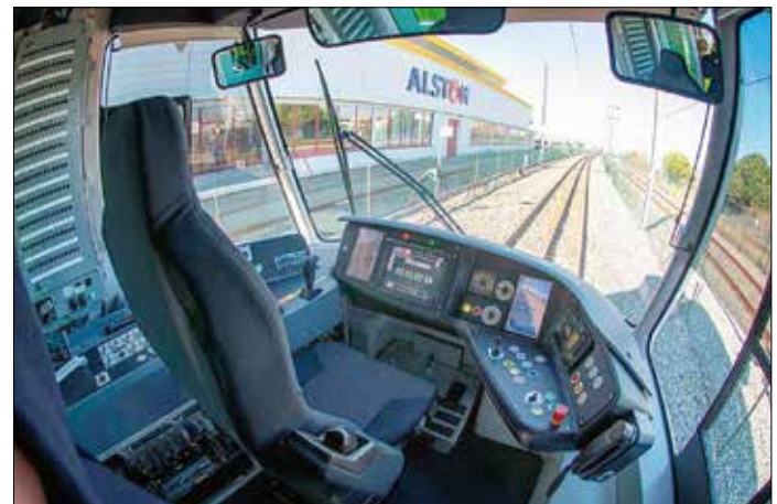
Förarplatsen är utformad i nära samarbete med förarpersonalen i Nantes och ergonomer. Videobackspeglar och en central bildskärm noteras, men därtill ett antal konventionella tryckknappar.
