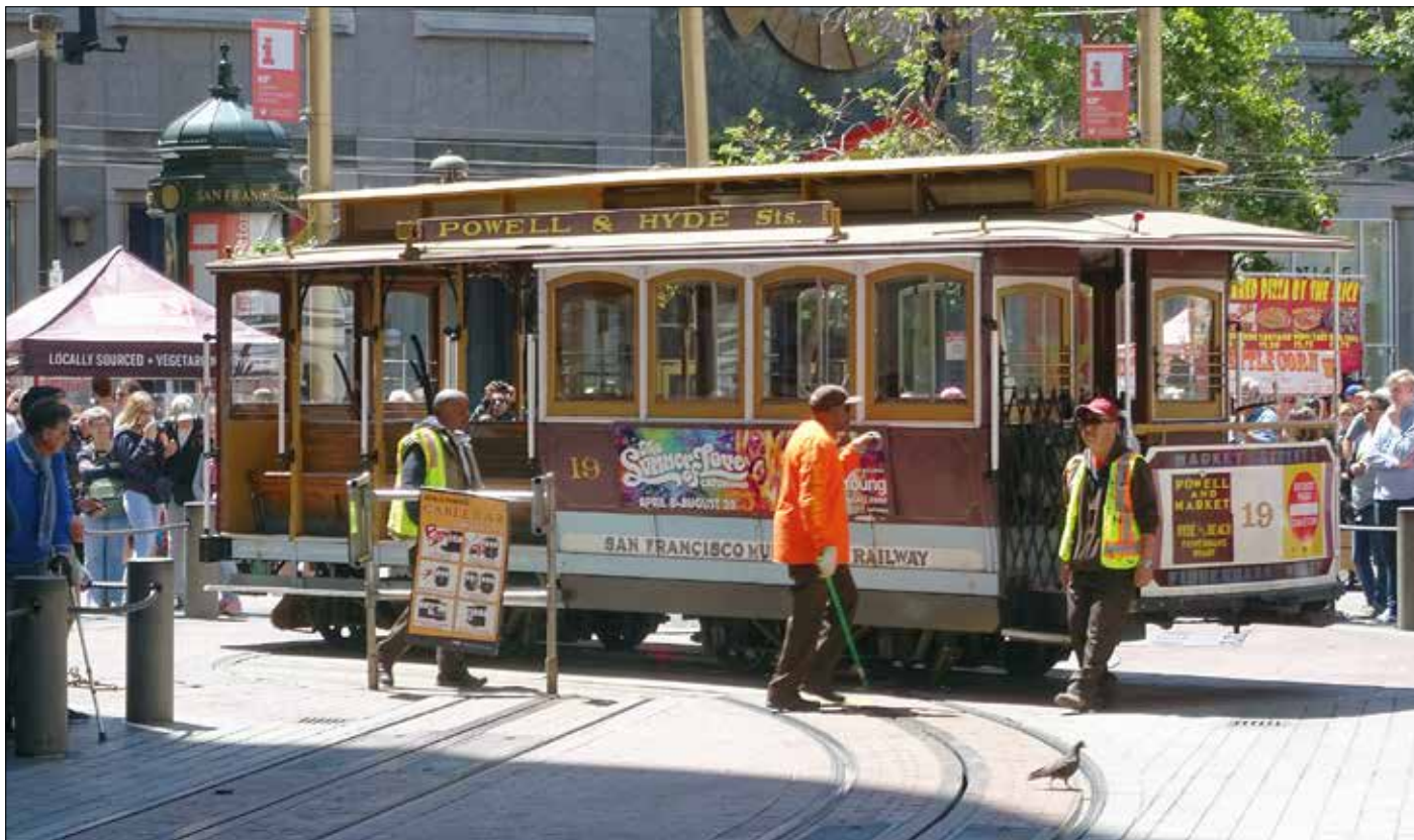
I San Francisco rullar de berömda kabelspårvagnarna på tre linjer. Vagnarna dras av en kabel som löper med konstant hastighet i en ränna mellan rälererna. Här vänds en vagn på vändskiva, medelst handkraft.
