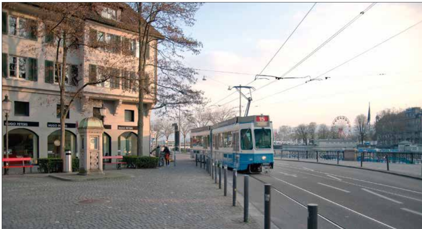
Spärrvagn på Limmatquai i centrala Zürich. Kontaktledning med enkel körtråd, därtill dubbel förstärkningsledning mellan de båda färdriktningarna.
