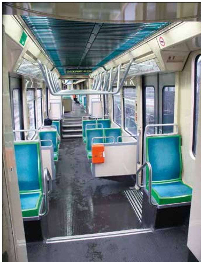
Interiör i den lågbyggda mittsektionen i en TFS 1. Golvhöjderna överbryggas med två trappsteg. Här nere finns plats för barnvagnar och rullstolar.
