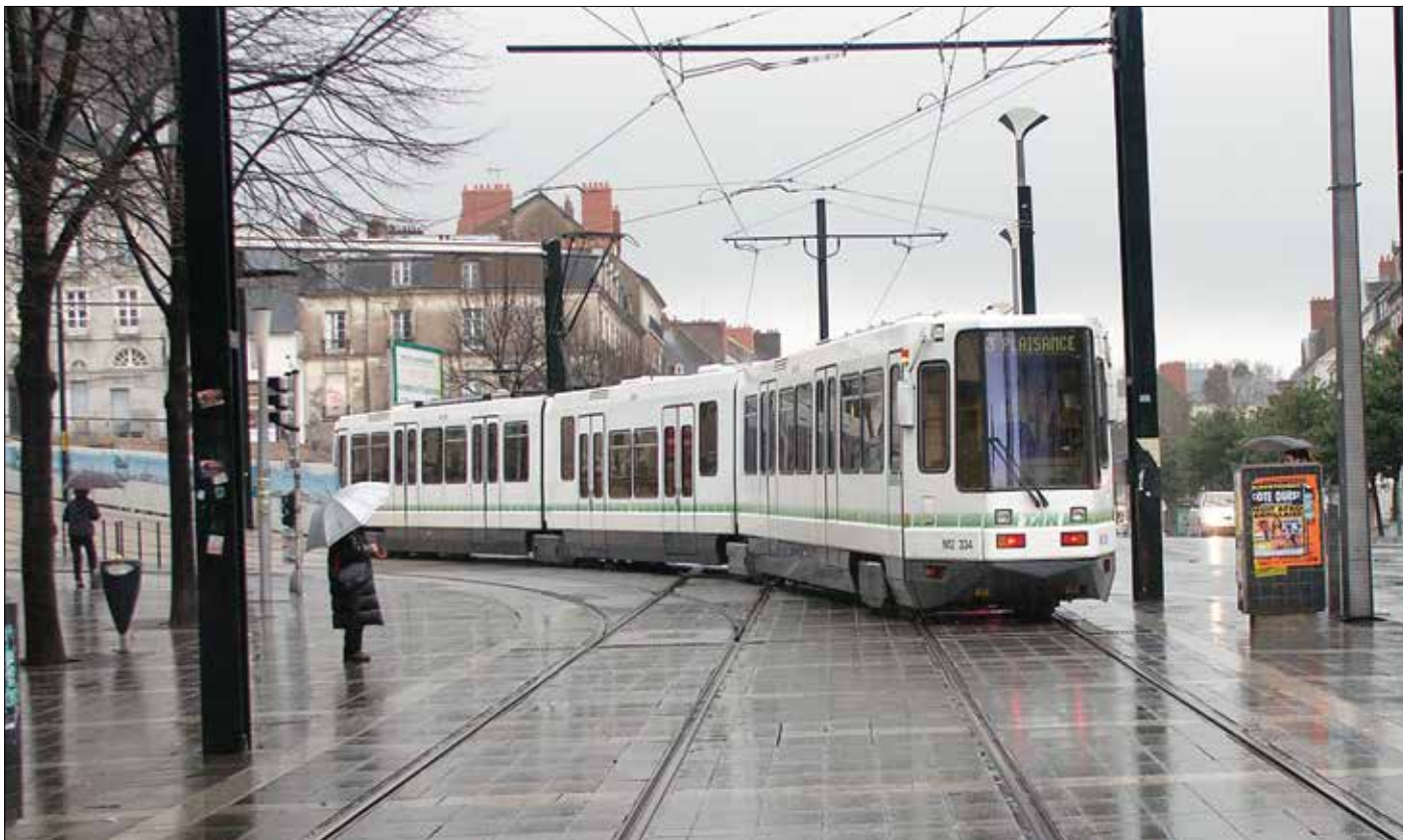
De första 46 spårvagnarna i Nantes fick nya mittvagnar med lågt golv 1992, med lågt insteg. Vagnslängden ökade från 28,5 meter till dagens 39,2. Mellan de tre vagnsdelarna finns så kallade Jakobsboggier.
