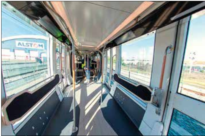
Interiör i den nya spårvagnsmodellen i Nantes, stora ytor för stående och barnvagnar. Notera ståndstöd utmed sidoväggarna.
