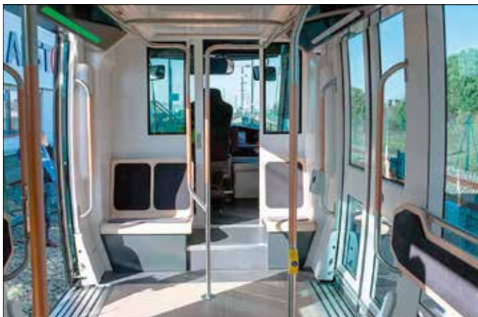
Förarplatsen är tydligt upphöjd. Därunder finns en fullt vridbar boggi, samma princip som hos spårvagnarna av typ Citadis 403 i Strasbourg. Intill förarplatsväggen finns 1+2-sittning.
