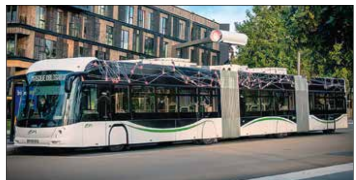
Förutom tre spårvägslinjer finns i Nantes två stombusslinjer enligt konceptet Busway. På bilden en elektrisk dubbelbuss från Carrosserie Hess (Schweiz), med flashladdning enligt system Tosa.
