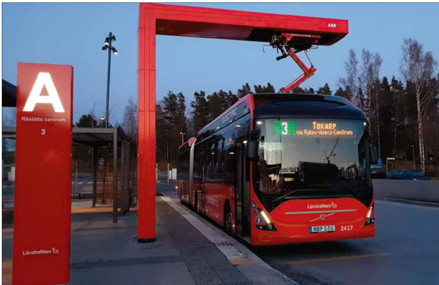
Vid Råslätts centrum står i kvällsskymningen en batteriledbuss på stomlinje 3 under laddning. Det finns sammanlagt elva laddstolpar av denna typ på Jönköpings nät för batteribusslinjer. Foto, samtliga: Ted Selander
