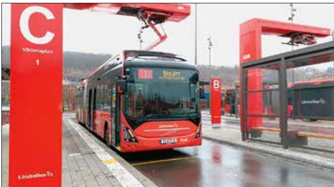
Viktoriaiplan i Huskvarna med batteriledbuss på stomlinje 1, laddning pågår inför avgång mot Råslätt.
