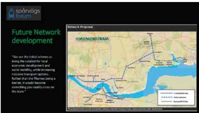
Ken Ex Tram är ett projekt för en ny spårväg mellan norra Kent och södra Essex, i tunnel under Themsens mynning. Det finns planer på fler spårvägssträckor i regionen. Heldragna linjer visar sådant som nu detaljprojekteras, streckade det som kan komma i ett senare skede.
