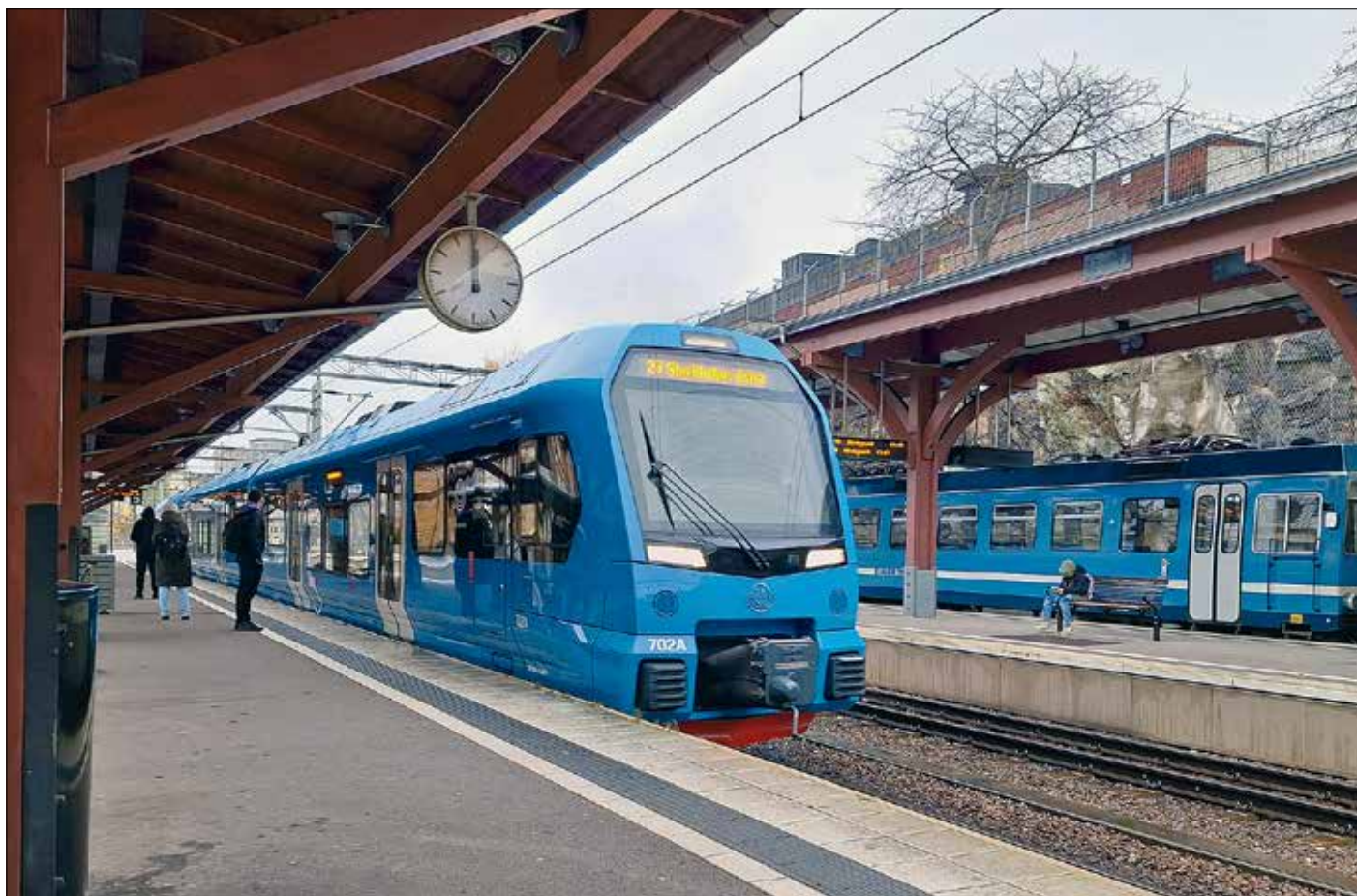
Nytt X15p-tåg på Stockholms östra station. Här syns tydligt den breda vagnskorgen som är något indragen vid plattformskanten. Korgbredd är 2,75 meter, mot 2,60 meter för de äldre tågen. Foto, där ej annat anges: Leif Stolt
