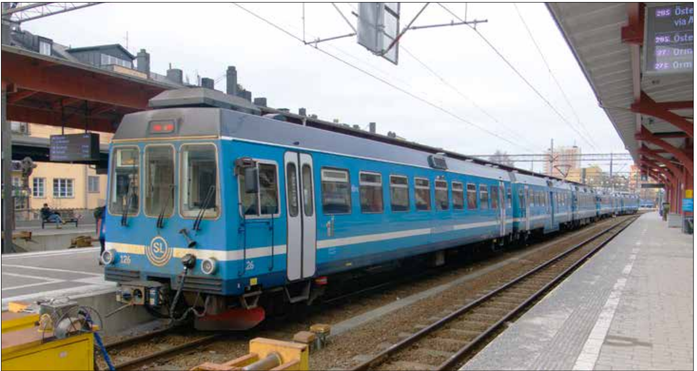
Ett typiskt "X10p"-tåg på Roslagsbanan, bildas av manövern (närmast) mellanvagn och motorvagn (som har littera X10p).
