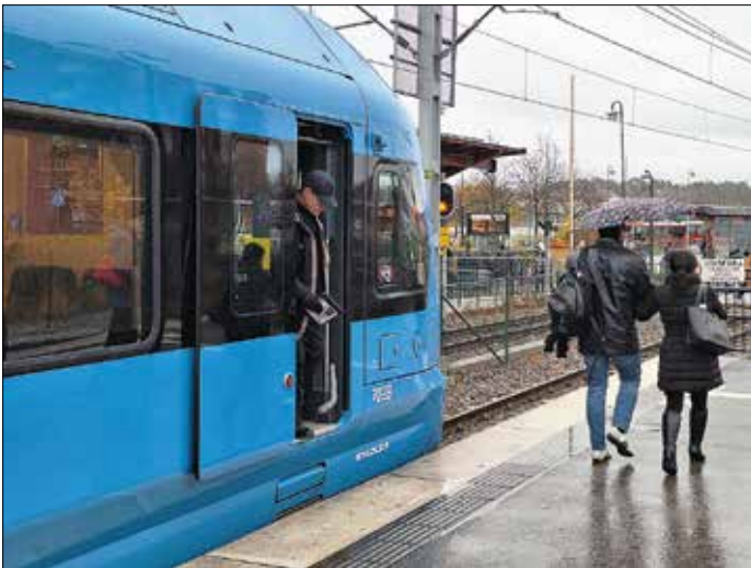
Förarutrymmet tar upp en rätt stor del av vagnens längd, speciellt i jämförelse med de äldre tågen av typ X10p.
