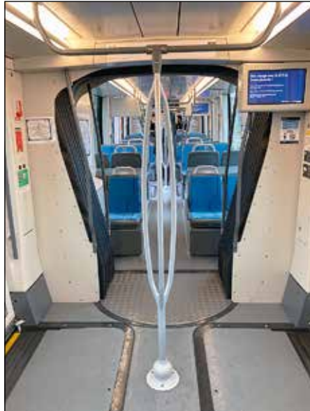
Golvet i vagnarna är förhållandevis plant med måttliga lutningar över boggier.
