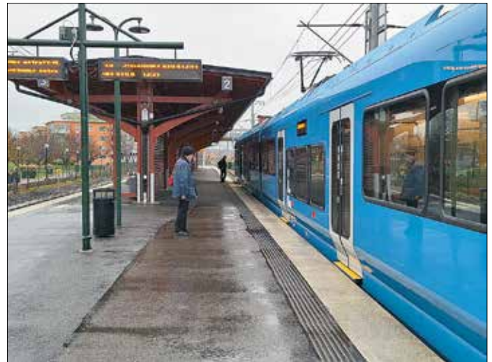
Utfällbara fotsteg (gula) sluter spalten mellan dörrtröskel och plattformskant.
