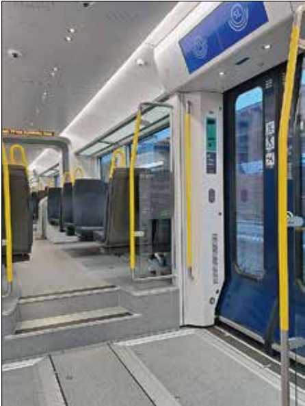
Varje dörr har plant insteg till plattformen.
