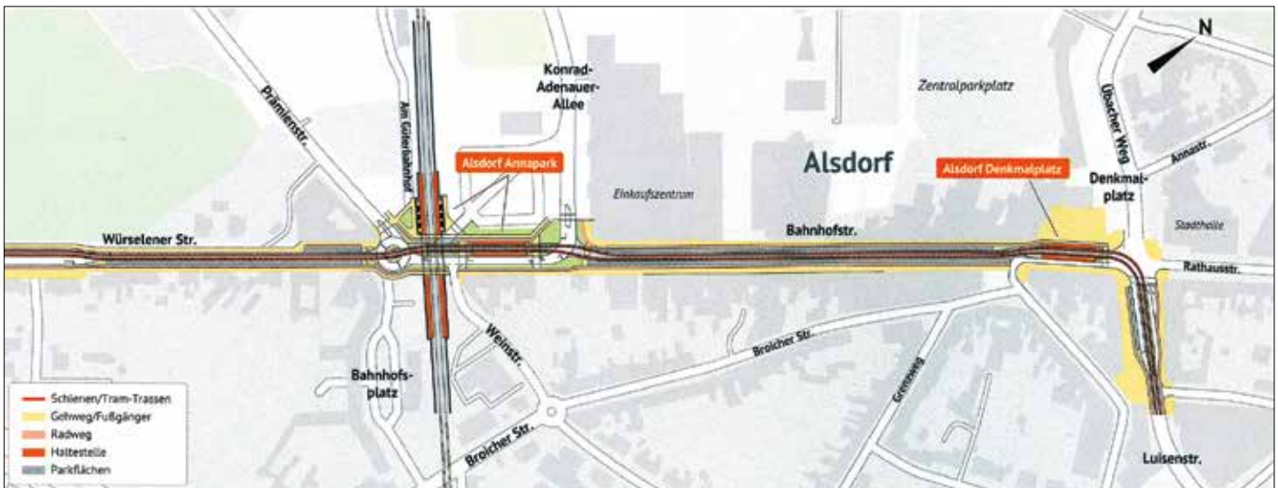
I stället för gruva och koksverk intill järnvägsstationen i Alsdorf finns nu ett stort ett grönområde, Annapark. Här ska nya spårvägen korsa järnvägslinjen Stolberg–Herzogenrath och därefter fortsätta genom stadskärnan. Vid korsningen anläggs en hållplats som ger goda bytesmöjligheter till Euregiobahn som sedan 2005 trafikerar Alsdorf. Första linjen i Euregiobahn-systemet öppnades 2001 till Stolberg öster om Aachen. Illustration:AVV
