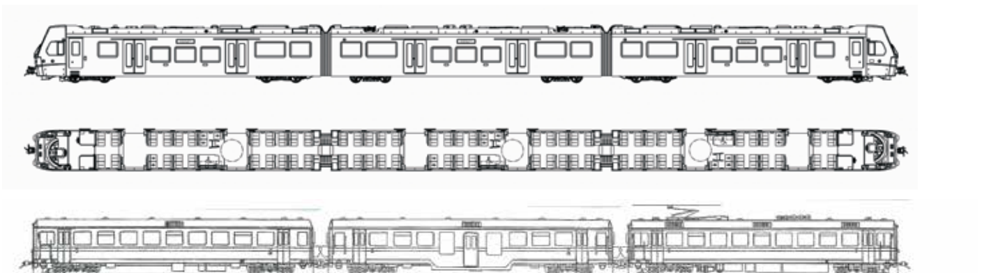
Det nya och det gamla tåget i jämförelse. Båda är runt 60 meter långa. Korgbredd på det äldre tåget är 2,60 meter och på det nya 2,75 meter.
