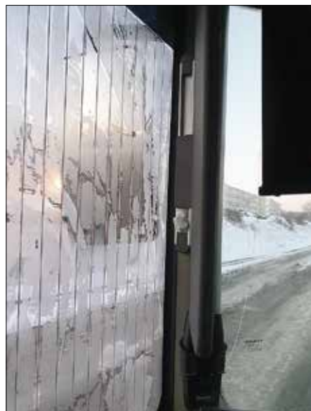
Värmetrådarna i sidofönstret på förarplatsen klarar inte minus 18 grader.
