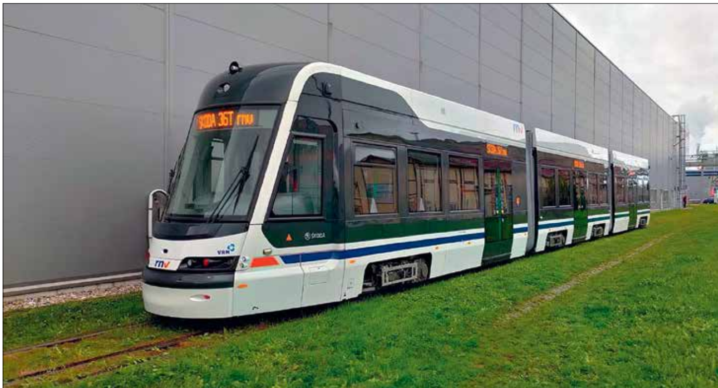
En ny Škoda 36T för RNV (Rhein-Neckar Verkehr) i Tyskland, gemensamt trafikbolag för städerna Mannheim, Ludwigshafen och Heidelberg, inklusive banorna OEG och RHB. Vagnen är 30,5 meter lång och 2,4 meter bred. Ordern omfattar sammanlagt 80 spårvagnar, även i längderna 40,65 meter och 58,7 meter. Foto: Škoda
