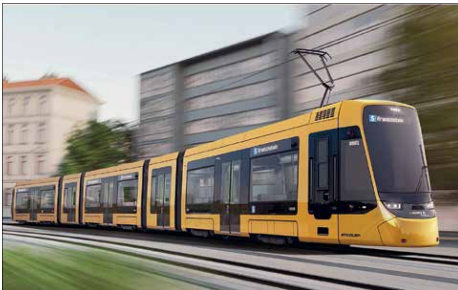
Trafikbolaget Heag Mobilio i Darmstadt beställde inledningsvis 14 stycken låggolvsspårvagnar av typ Stadler Tina, därefter ytterligare 11, sammanlagt 25. Vagnarna är 44 meter långa och 2,4 meter breda, har plats för 97 sittande och 171 stående passagerare. Högsta hastighet är 70 km/h. Bild: Stadler
