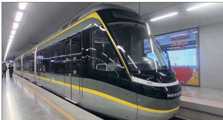
Den första av de sammanlagt 18 från kinesiska CRRC beställda låggolvsvagnarna för Metro do Porto ställdes ut på stationen Trindade tidigt i februari 2023. Vagnarna är 35 meter långa. De planerades kunna vara i trafik från maj i år.
