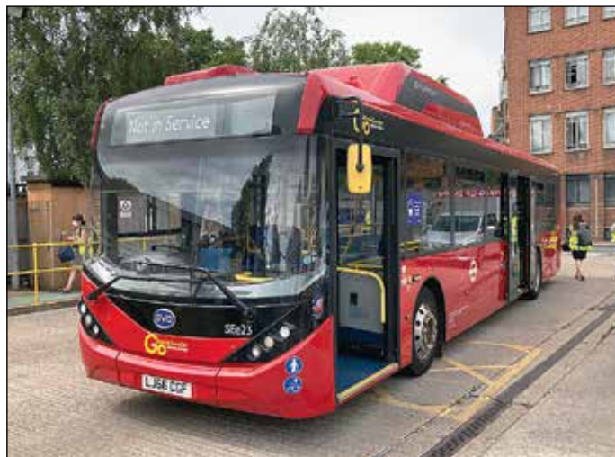
Enviro 200 EV-bussarna beställdes hos BYD, med karosser byggda i Falkirk i Skottland av företaget Alexander Dennis Limited (ADL). Chassin och andra komponenter kommer således från Kina. Bussarna är 12,029 m långa, 2,470 m breda och 3,385 m höga med en hjulbas på 6,1 m. Främre och bakre överhäng är 2,689 m respektive 3,24 m
