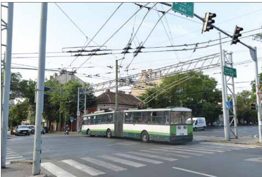
En Škoda Tr 15 passerar den mest komplicerade ledningskonstruktionen i Szeged, här på linje 8 mot Klinikåk.
