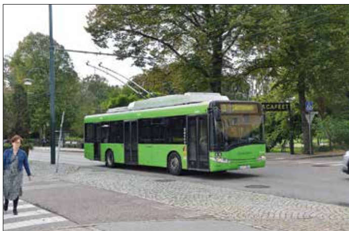
Trådbussen Else-len gick också i trafik under jubileumsdagen. Denna trådbuss levererades 2010 för att det skulle vara möjligt att utöka trafiken till fyra omlopp. Till skillnad från övriga trådbussar har Else-len en dieselmotor som hjälp för förflyttning till och från depån.
