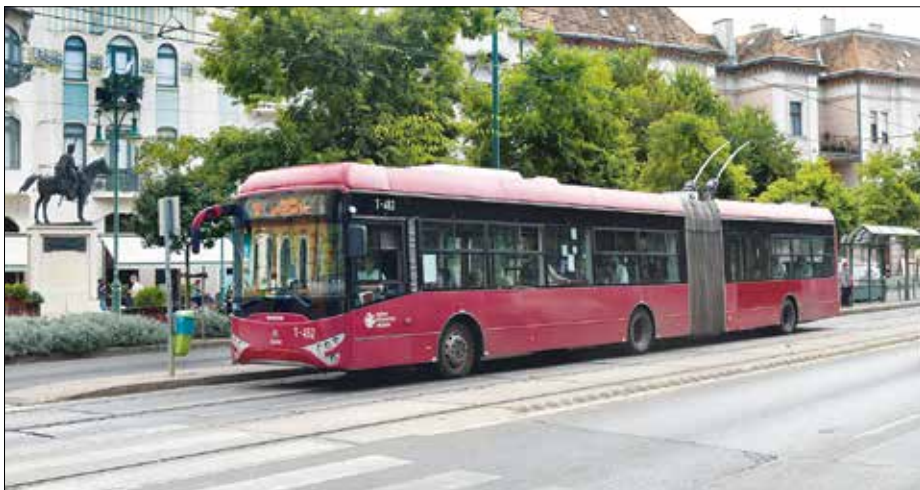
Den till Szeged senast levererade trådbussmodellen är Ikarus-Škoda Tr 187.2, här nr T-462. Ingen vacker färg, och man ser tydligt hur matt den har blivit. Det har suttit en reklamaffisch framför bussens sista axel. Där har den ursprungliga färgen glansen kvar.
