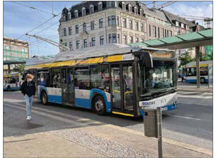
Ett smakprov av framtiden: Solaris generation 4 som batteritrådbuss i Solingen 22 maj 2022. Bussen har samma utseende som de kommande trådbussarna till Landskrona men har elektrisk utrustning från Kiepe Electric. Landskronabussarna får utrustning från Škoda.
