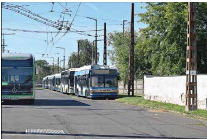
Bild från ena halvan av vagnhallsområdet i Debrecen. Trådbussar är uppställda i långa rader under dagen. Den första till höger är en MAZ. Till vänster står en ny batteribuss på laddning. De syns lätt tack vare de gröna registreringskyltarna. Som framgår av bilderna i artikeln har trådbussar i Ungern normalt inga registreringskyltar.
