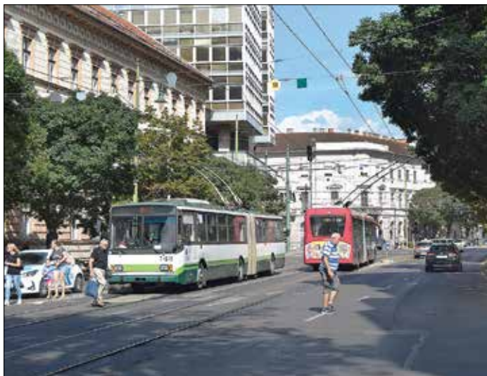
På huvudgatan Tisza Lajos körút i Szeged går spårvagnar och trådbussar i samma körfält. Kontaktledningarna har respektfullt avstånd till varandra. Detta syns på att strömvagnarna är långt åt sidan.
