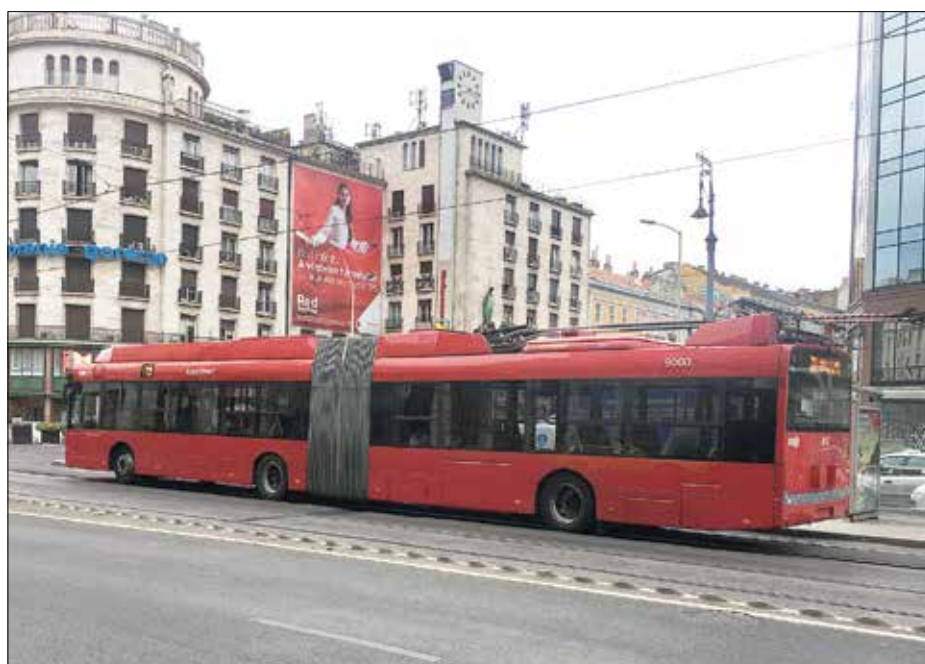
Trådbuss Škoda Tr27 Solaris nr 9000 i batteridrift i spårvägsspåren i gatan Muzeum körút. Bussen tillhör en serie om 16 stycken som levererades under 2015. Batteritrådbussar (IMC) kan köra längre sträckor utan kontaktledning och därmed minska behovet av sådan infrastruktur.
