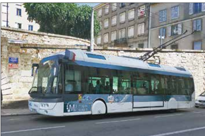
Den vanligaste trådbussmodellen i Limoges är Cristalis ETB 12, som levererades från 2007 i 27 exemplar. Tyvärr är dessa futuristiska trådbussar inte särskilt driftsäkra, tillika mycket bullriga.
