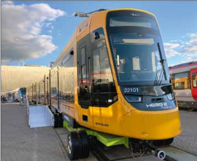
Stadler visade den nya spårvagnsmodellen TINA. En av kunderna är HEAG Mobilo i Darmstadt i Tyskland som har beställt 14+11 vagnar. Vagntypen kan byggas med 70–100 procent lågt golv, efter kundönskan.
