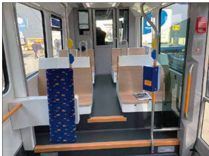
Škoda Forcity Smart RNV har två steg upp till passagerarutrymmen över vagnsändarnas boggier. Inte helt optimalt för en spårvagn i utpräglad stadstrafik. Men RNV har långa regionala linjer där passagerarcirkulation inte alltid är påtaglig vid längre avstånd mellan hållplatser.
