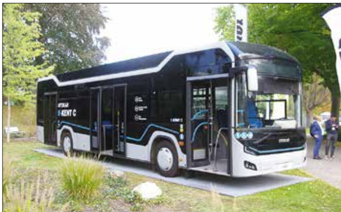
Den turkiska tillverkaren Otokar visade batteribussen e-Kent C-buss som är avsedd att laddas i depån. Bussen är utrustad med tio NMC litiumjonbatterier.
