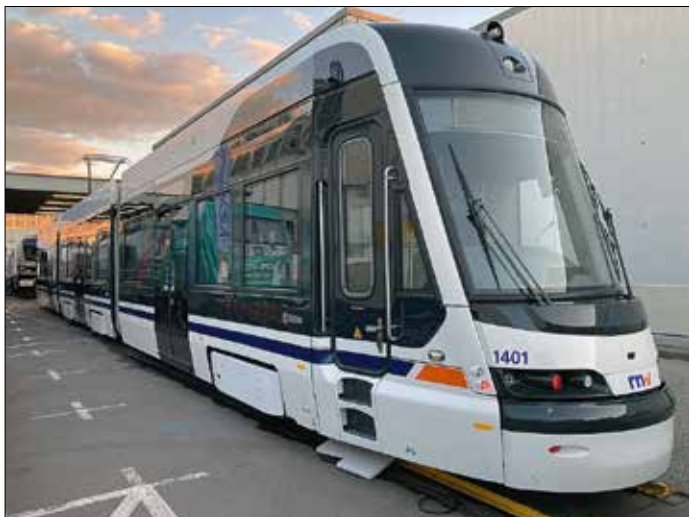
Škoda vann den stora upphandlingen hos Rhein-Neckar-Verkehr GmbH, RNV. Ordern omfattar 80 vagnar av typ Forcity Smart. Den utställda spårvagnen är en tvåriktningsvagn med längd 30,5 meter och bredd 2,4 meter. Foto, samtliga: Patrick Laval
