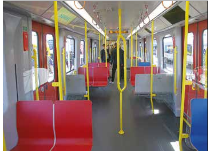
Klassisk tunnelvagnsinteriör, fast i starkare färger. X-Wagen som visas i Berlin har en förarhytt, som inte behövs i helautomatisk drift och därför kan tas bort så att resenärerna får mer plats ombord! De fyra mittvagnarna är motoriserade.
