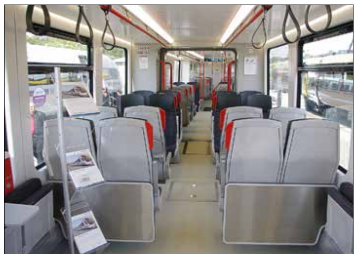
Inredningen i Stadler Citylink rymmer 252 passagerare, av vilka 126 får sitta. Denna tredelade 40 meter långa vagn påminner interiört mer om ett pendeltåg än om en spårsvagn, trots vagnskorgens bredd om 2,65 meter. Vagnen har gott om sittplatser i fullformat, och även ett antal fällsitsar vid flexutrymmen.
