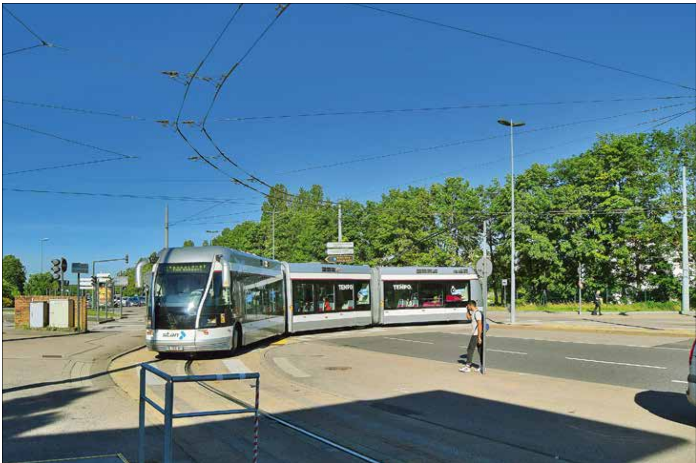
TVR-fordon i vändslungan vid CHU Brabois i Vandœuvre. Man kan se spårbildningen i betongen efter de stora gummihjulen. Vid spårstyrning rullar samtliga däck alltid i exakt samma spår. Endast betong är motståndskraftigt nog för att något så när stå emot deformationspåverkan. Den lätt roströda tonen i bussbanan härrör från järnpartiklar som frisätts genom det kraftiga slitaget av styrspar och styrhjul, särskilt i skarpa kurvor.
