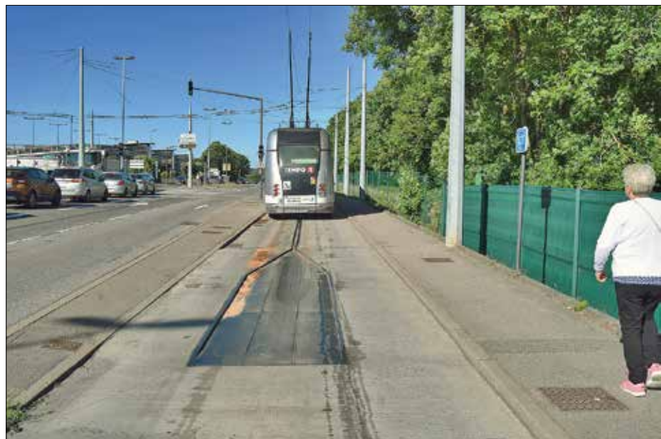
Efter att ha passerat den långa stigningen upp till ändhållplatsen vid sjukhuset CHU Brabois ansluts TVR-fordonen till styrrälen med hjälp av den horisontella trattliknade anordningen som syns på bilden. Styrhjulen (två per hjulpar, sammanlagt åtta stycken) fälls ned och pressas av tryckcylindrar fjädrande mot styrrälen. De påverkar mekaniskt gummihjulen så att de styrs rätt i kurvor. Vid handstyrd färd, utan rälstyrning, vrids gummihjulen vid kurvkörning genom påverkan av vagnskorgarnas inbördes positioner, jämför styrd tredje axel på en konventionell led buss.
