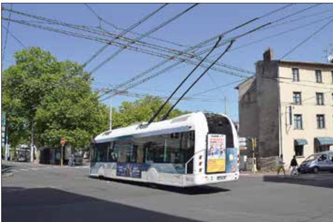
Det finns många i det närmaste rätvinkliga korsningspunkter mellan trådbusslinjerna i centrum av Limoges, utan möjlighet att vika av in på korsande sträckningar.
