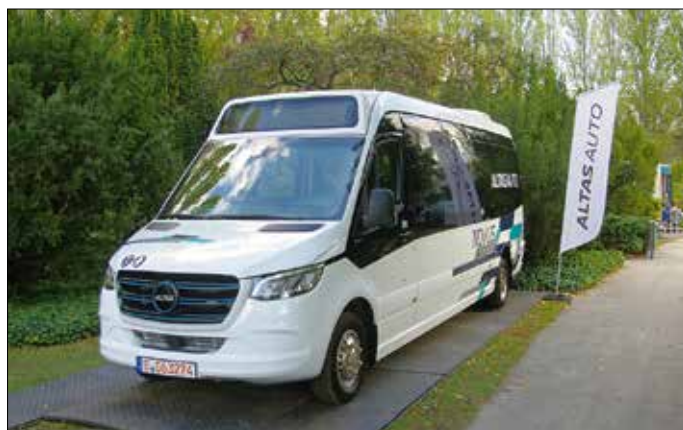
Baserad på Mercedes Sprinter har Novus Cityline Electric från litauiska tillverkaren Altas Auto en särskilt tyst drivlina och är utrustad med en 150 kW elmotor.
