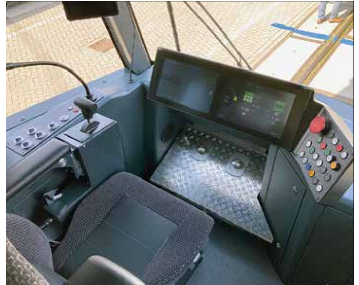
Förarplatsen i Stadler TINA för Darmstadt. Vagnen är utrustad med ett förarassistanssystem baserat på lidar, radar och kameror. Maximal hastighet är 70 km/h.
