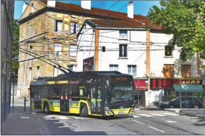
De 23 nya Solaris 12 Škoda Electric är så kallade batteritrådbussar, vilket innebär att de kan köras på batteri nästan långa sträckor, för att sedan laddas vid färd under kontaktledning.
