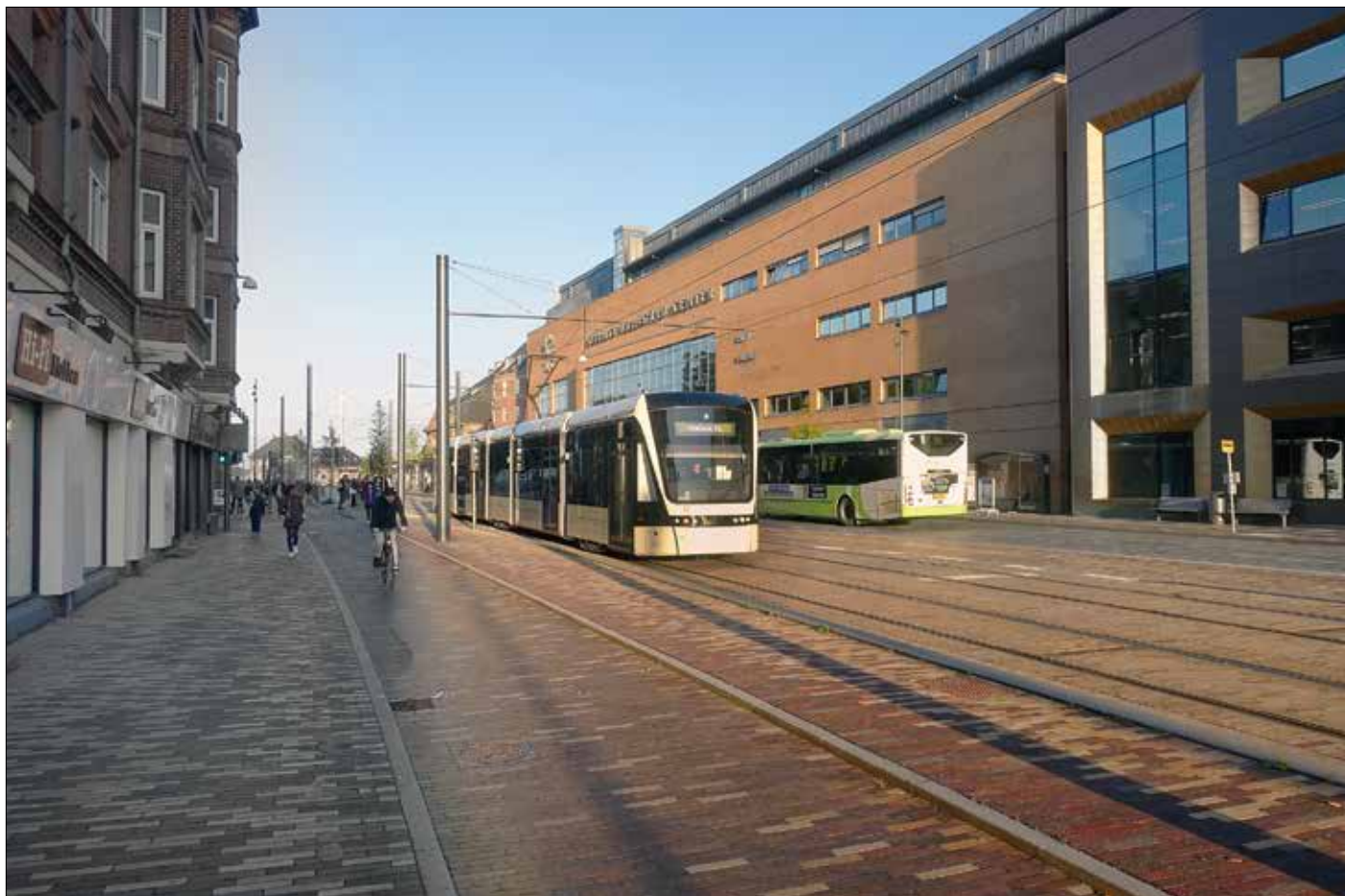
I den låga kvällssolen rullar en spårvagn förbi Odense Banegårdscenter i riktning mot Hjallesse Station. Detta är en av sammanlagt 16 Stadler Variobahn, ca 30 meter långa och 2,65 meter breda.
