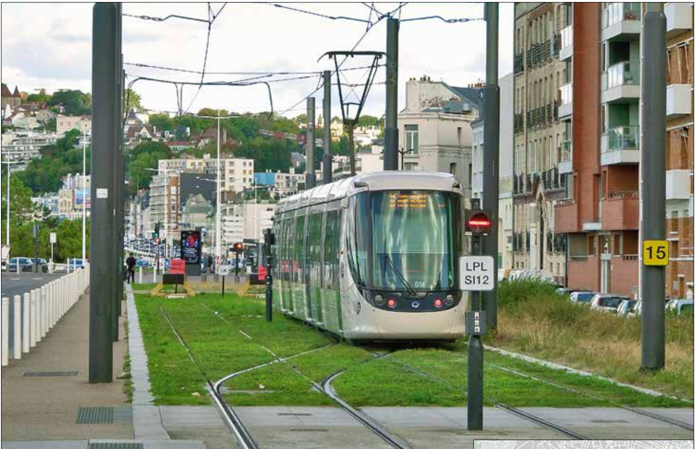
En spårvagn under vändning vid ändhållplatsen La Plage på spårvägen i Le Havre. Det finns övergångsväxlar på var sida om hållplatsområdet, den första som motväxel, den andra som medväxel, sett i färdriktningen vid normal högertrafik.
