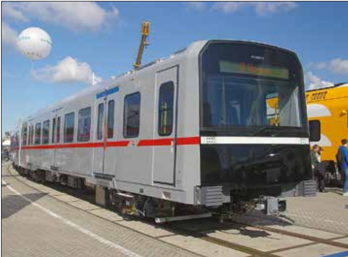
På utställningsspåren kunde man besöka två vagnsdelar av Wiener Liniens nya X-Wagen, en tunnelvagnsmodell som tillverkas av Siemens i Wien. Ett fullängdståg om sex vagnar är 111,25 meter långt och uppger rymma 928 passagerare. Högsta hastighet är 80 km/h.
