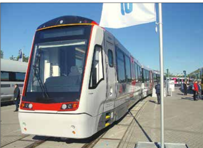
Stadlers duospårsvagn Citylink för Transport for Wales , TfW, är snarast ett lättare pendeltåg med högt golv (915 mm). Det kan strömmatas antingen från kontaktledning (25 kV 50 Hz) eller från batteri ombord. Vagnen är 40 meter lång, 2,65 meter bred och har 100 km/h som högsta tillåtna hastighet. Passagerartrafiken inleddes 2023.
