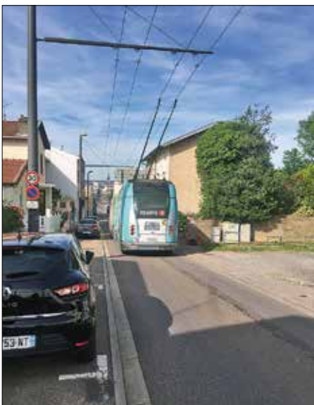
Den långa backen upp till Vandœuvre lutar 13 procent på den brantaste passagen. Här används inte styrskena, det är delvis "enkelspår" eftersom det är mycket trångt. TVR-fordon kör på bilden i riktning mot centrum.
