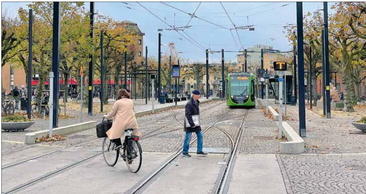
Ändhållplatsen vid Clemenstorget i centrala Lund, intill järnvägsstationen. Notera den öppna lösningen, utan staket eller andra barriärer, dock med fysisk gestaltning som tydligt visar vilket område av markytan som trafikeras med spårvagnar. Foto: PG Andersson
