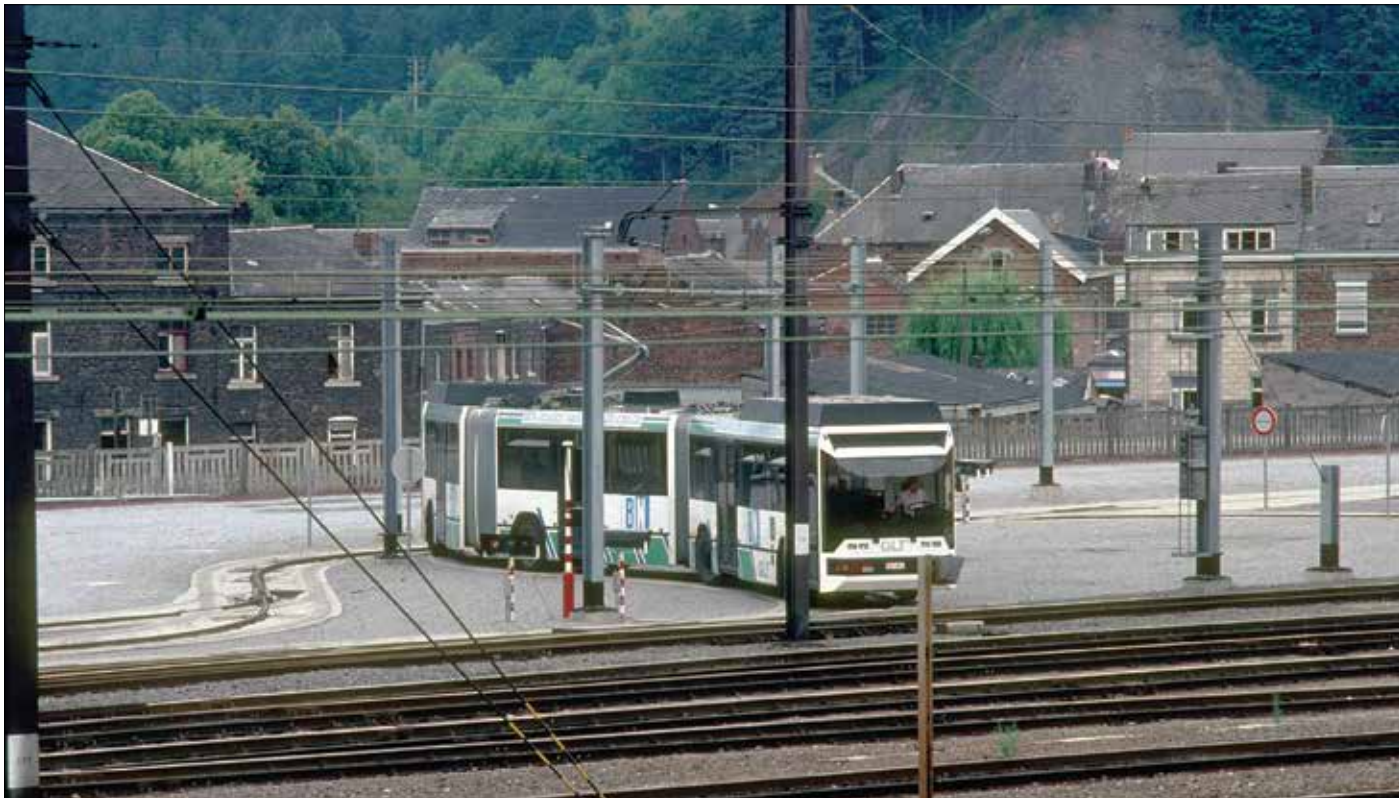
I Jemelle fanns en skarp S-kurva, kanske byggd för att visa att bussen verkligen kan följa i kurvor utan att svepa. Detta är möjligt då samtliga axlar är styrda vid spårdrift. Bilden tagen 23 juli 1989. Provbanan trafikerades till slutet av 1990-talet, dokumenterat så sent som 1997 då ett nytt låg-golvsfordon testades.
