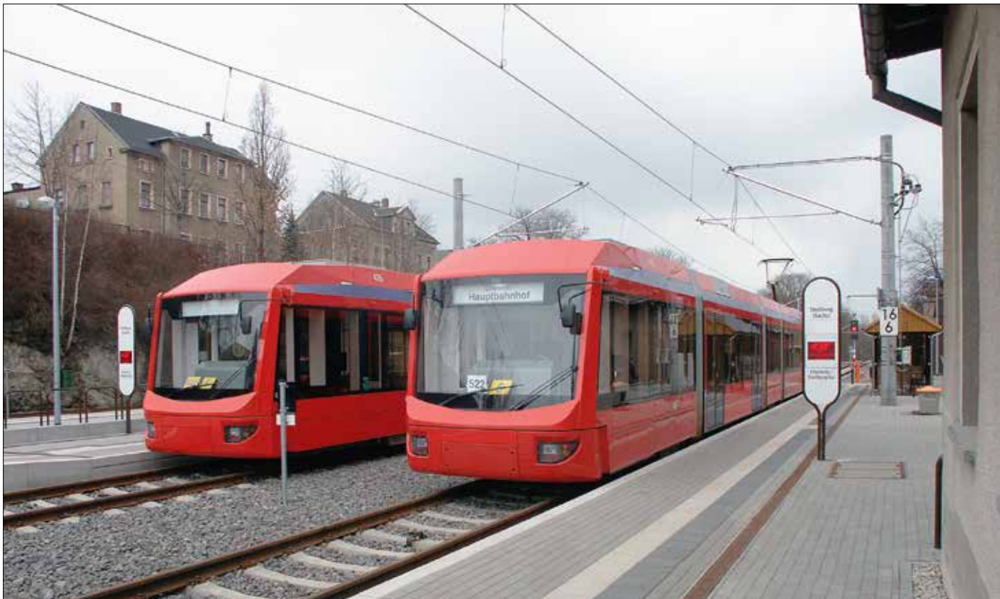
Spårvagnar på järnvägar som elektrifierats med 750V DC finns sedan 2002 även i Chemnitz med omgivning, två Variobahn står här vid ändstationen Stollberg på den först öppnade linjen. Stadsnätet i Chemnitz matas med 600V DC. Det finns även dieselektriska duospårvagnar i trafik i regionen.
