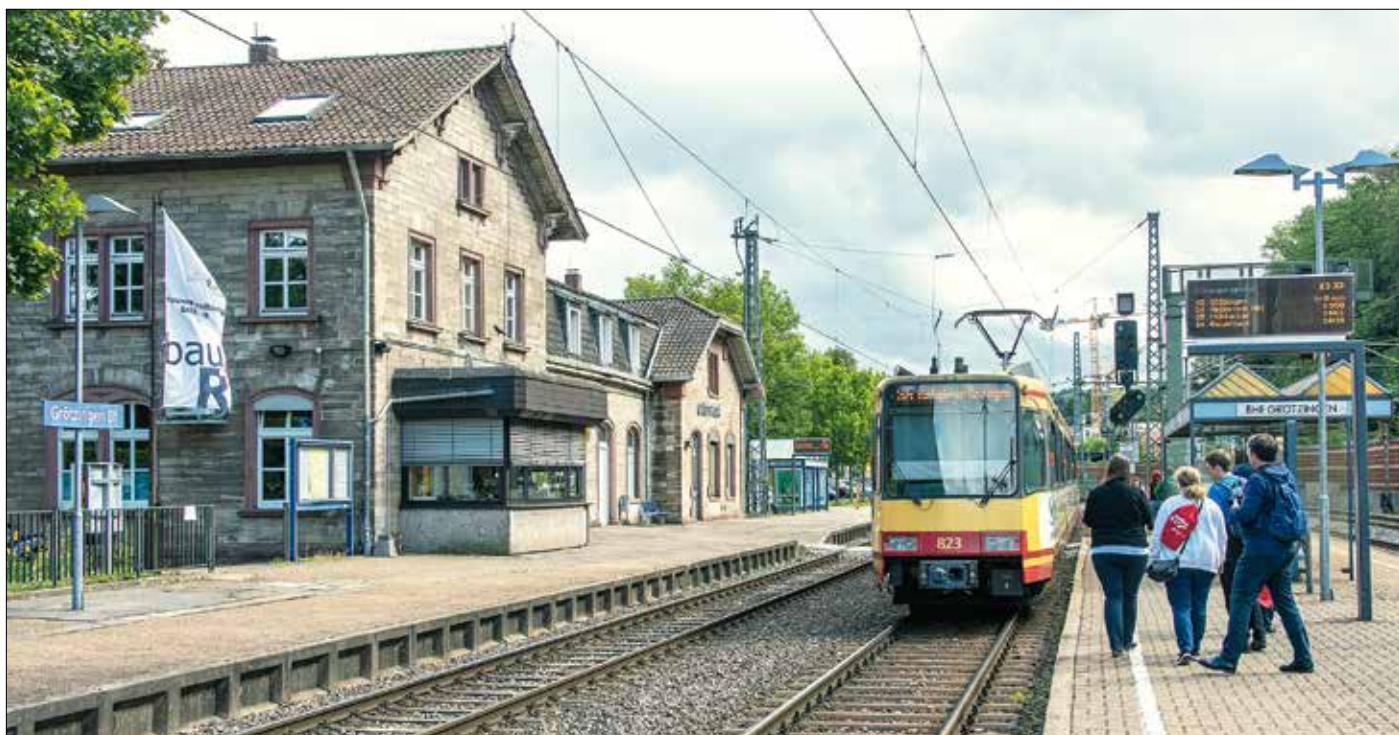
Det var i Karlsruhe med omgivningar som trafiken med särskilt anpassade spårvagnar på regionens många lågt trafikerade järnvägslinjer inleddes runt 1990. Begreppet "Karlsruher Modell" myntades och spreds till andra städer och länder. Fordonen kallas ibland "Tram-train", i Sverige ofta "duospårvagn". På bilden en tvåsystemsvagn av typ GT8-100C/2S från 1994. Inom några år måste dessa och liknade vagnar ersättas.
