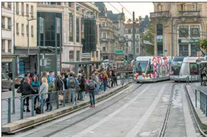
Ett ökande problem med TVR-fordonen är alltför låg kapacitet. Som vägfordon kan de inte förlängas utöver nuvarande längd om 25 meter. Fler vagnar kan inte sättas in, ty det finns inga fler.
