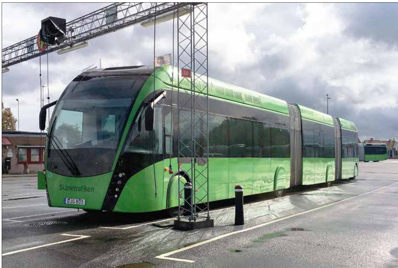
Vid besöket i Malmö visades den första generationens "BRT-bussar" med två leder och "falsk" förarhytt i bakänden. Någon provtur blev det dock inte. Dessa bussar är gashybrider, tillverkade av Van Hool, modell Exquicity.
