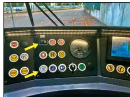
Figur 4. Förarmiljö i den nya spårvagnstypen M33 med reglagen för automatiskt förval markerade.
