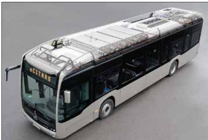
Illustration som visar bland annat batteriernas placering på busstak. Bild: Daimler Buses
