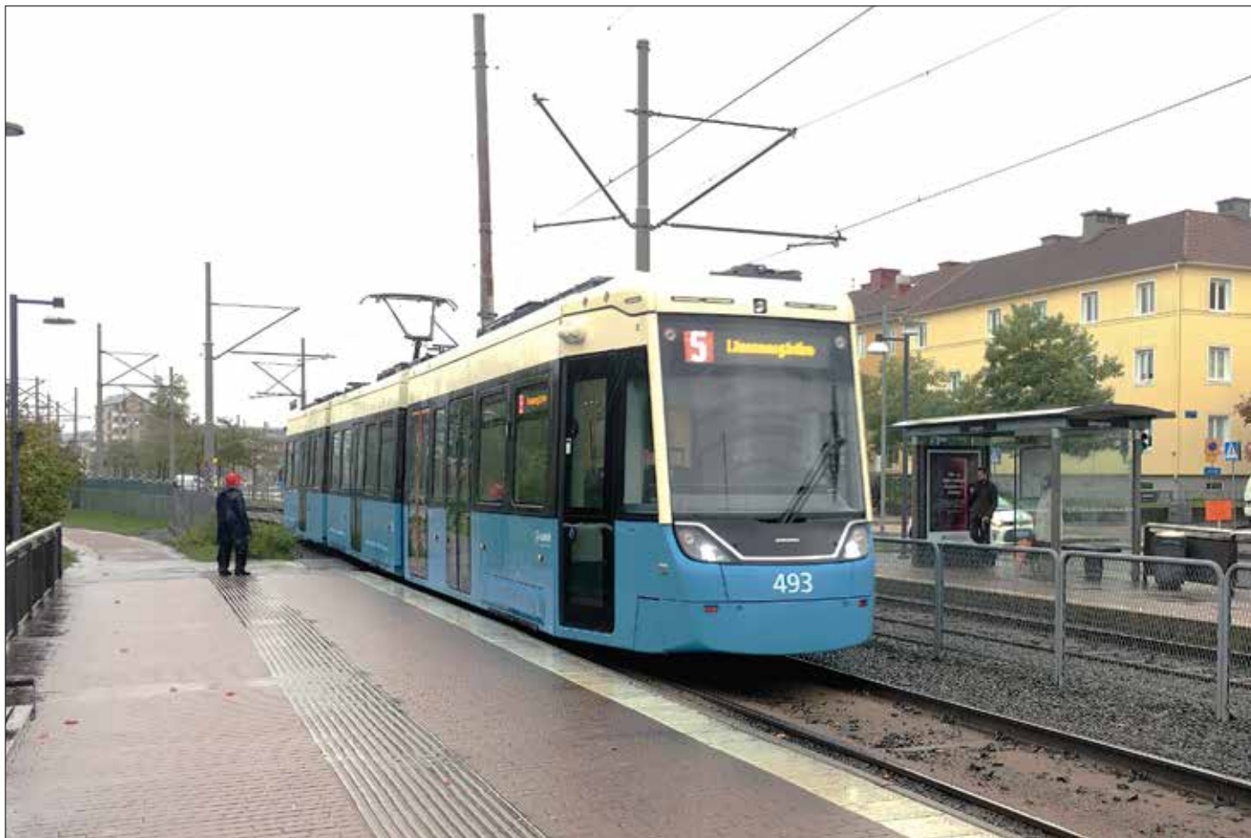
Till Göteborg pågår nu leverans av nya spårvagnar av modell M33. Sammanlagt 40 vagnar i 33 meters längd har beställts av vilka 30 stycken blir i enriktungs- och tio stycken i tvåriktungsutförande. Nyligen beställdes ytterligare 40 vagnar i 45 meters längd. Foto, samtliga: Helge Bay
