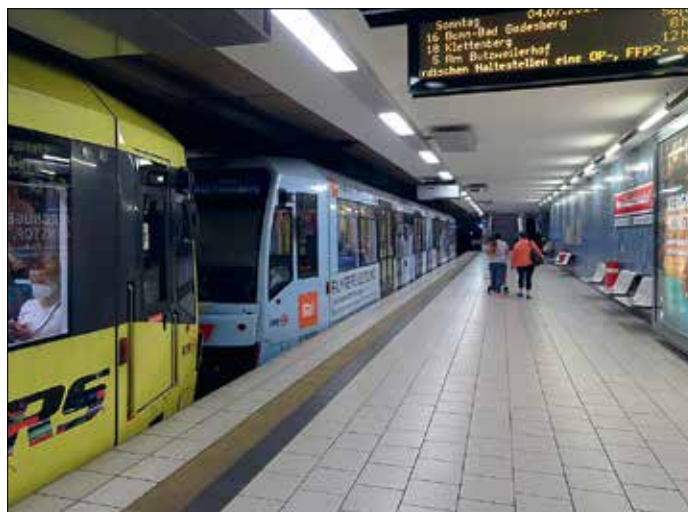
Multipelkopplade höggolvsvagnar av typ K5000 vid stationen Dom Hauptbahnhof, på linje 16 mot Bonn och Bad Godesberg.
