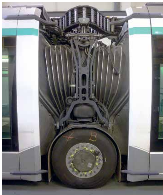
Linje T6, vars sträckning omfattar långa och branta lutningar, fick en nyutvecklad, sexdelad 46 meter lång version av Translohr, med navmotorer även i hjulen i mellansegmenten (i ledpartierna), här med demonterade täckplåtar. Kortare vagnversioner har motorer endast i ändmodulerna.
