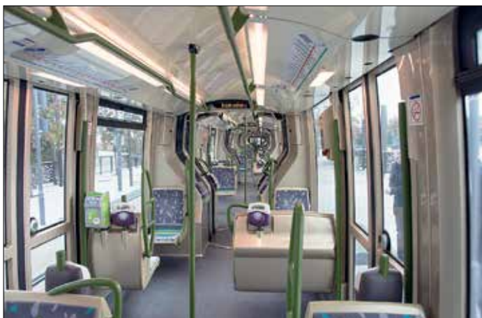
Translohr-fordonen är endast 2,20 meter breda, vilket ger 1+2-sittning. Dessutom är ledpassagerna tämligen trånga. De korta fordonen på linje T5 är underdimensionerade för trafikuppgiften. Barnvagnar får i praktiken mindre plats än på bussarna!
