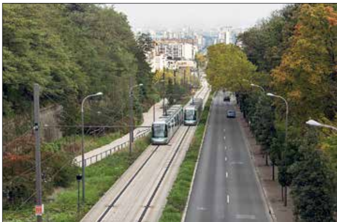
Linje T6 går från tunnelbanestationen Châtillon-Montrouge mot sydväst, till Robert Wagner (2014) och sedan till Viroflay Rive-Droite (2016). Linjen har långa och kraftiga lutningar, vilket motiverade gum-mihjulstekniken.
