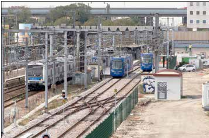
Duospårsvagnslinje T4 togs i trafik 2006, några veckor före T3. T4 skulle vara Frankrikes svar på Karlsruhe-modellen, men blev istället ett komplicerat mellanting, duospårsvagn på en ombyggd järnväg som behållit 25 kV växelström i kontaktledningen.
