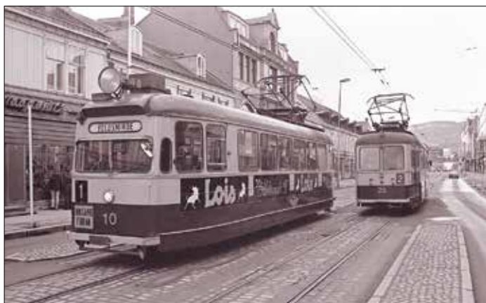
Vagnsserien nr 10–32 levererades 1957–58 av Strømmen och NEBB. Vagnstypen gick i trafik till 1984–85 och som reserver och i högttrafik fram till stadslinjernas nedläggning 1988. Notera den ovanliga kombinationen meterspår och 2,60 meters korgbredd. Foto: Thomas Johansson
