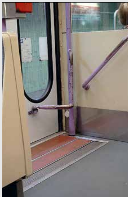
Höggolvsvagnarna kan utnyttja stationerna med låg plattform eftersom de har nedfällbara trappsteg, vilket fungerar för de flesta men tyvärr är besvärligt för dem som har ...
