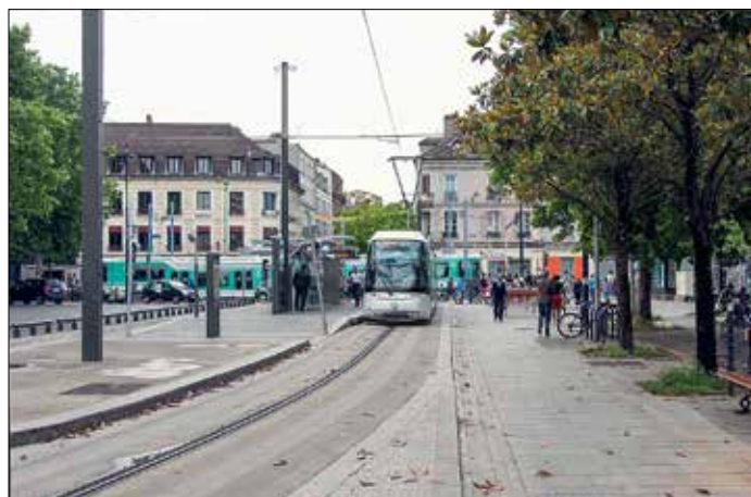
RATP har låtit bygga två helt självständiga linjer för 2,20 meter breda Translohr-fordon på gummihjul. Det rör sig bland annat om linje T5 mellan Saint-Denis och Sarcelles (2013), norr om Paris. Bilden visar ändhållplatsen i Saint-Denis med en vinkelrätt passerande TFS 2-vagn på linje T1 i bakgrunden.
