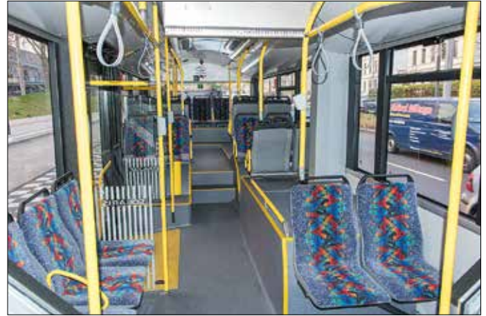
Batterierna i de nya batteritrådbussarna är placerade under golvet i bakvagnen. Därför blir golvnivån tämligen hög, med två steg.
