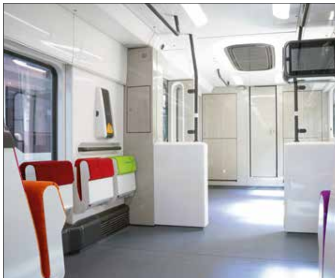
Avdelning espace UFR (rullstolsutrymme) i ändvagnarna, nära yttersta ingångsdörrarna. Två multifunktionella utrymmen som inretts för rullstolsburna resenärer och utrustats med larmknappar.
