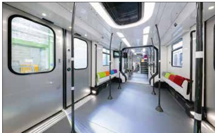
Mellan vagnarna finns breda dörrlösa öppningar med 1 300 mm fri bredd i golvnivå.
