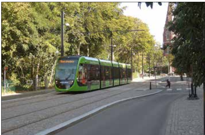
Den 18 september rullar Åsa-Hanna mot Clemenstorget i St Laurentiigatan. Det är den enda sträcka där underlaget är hårdgjort, i form av smågatsten. I övrigt dominerar grässpår.
