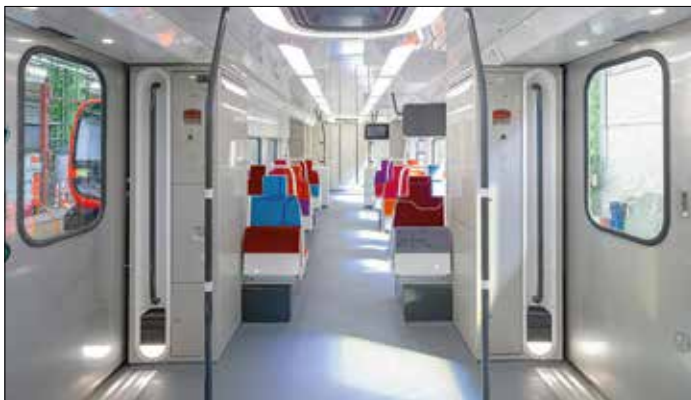
Avdelningen véhicule d'extrémité (ändfordon) är således ändvagnarna. De har inredning med hög kapacitet vilket innebär några få sittplatser, mest fällstolar.
