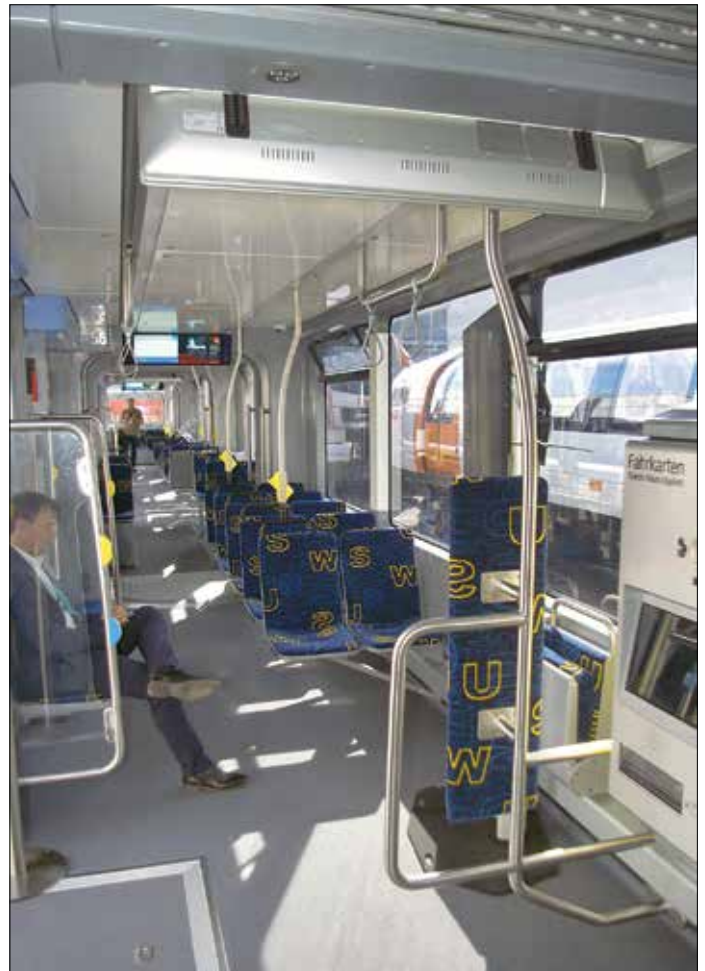
Siemens Avenio M för Ulm i enriktningsutförande har förutom förarhytten en "hjälpförarplats" i bakänden. Fyra dörrpar, två på varje hängande vagnsdel, och en enkeldörr vid var ände, ger en jämn fördelning längs vagnen, som är 31,47 m lång. Insteg och golv ligger 305 mm över rälsen. Golvet inte är helt plant utan stiger till 380 mm över boggierna, men "backen" är rätt svag.
