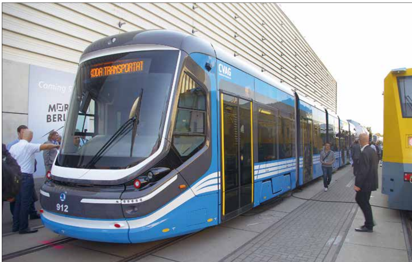
Škoda Transportation var för sjätte gången i rad på plats på Innotrans med sin For City-spårvagn, i år med en av de 14 For City Classic som beställts av CVAG i Chemnitz i Tyskland. Tvåriktningsfordonet (31,39 meter långt) är femdelat och vilar på tre motorboggier med en totaleffekt på 560 kW.
