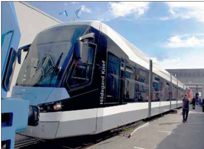
Siemens visade en av de 12 Avenio M som SWU i Ulm (meterspår) beställt för framtida linje 2. Avenio presenterades för tredje gången i år, fast nu i nytt femdelat utförande, på tre boggier, varav två motorboggier under änddelarna, 4x120 kW.
