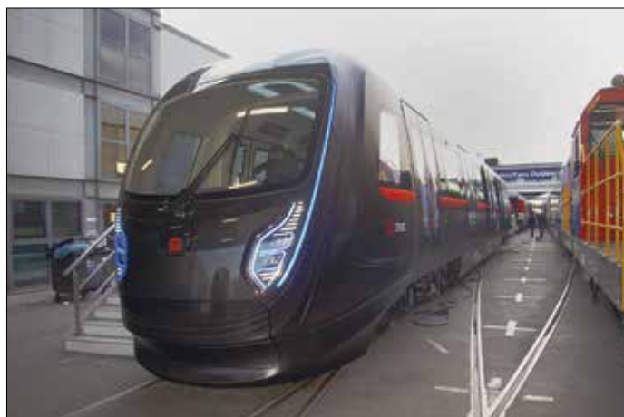
En annan märklig tunnelbanevagn är Cetrovo, vars korg och boggiramar tillverkats i CFRP (kolfiberarmerad polymer) och därför är 30 respektive 40 procent lättare än lättmetallkorgar och stålramar.
