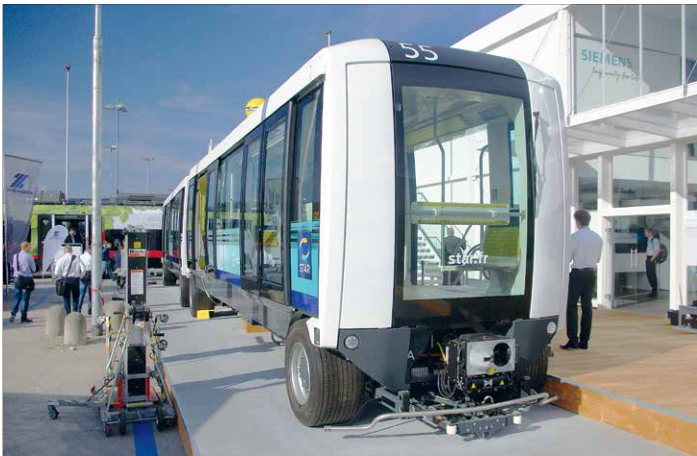
Siemens visade två tunnelbanevagnar, bland annat denna Cityval Rennes B, en vidareutveckling av helautomatiska VAL-vagnar på gummihjul. Vagnen kommer att sättas i trafik på den andra metrolinjen (B) i Rennes, Bretagnes huvudstad. Siemens hade att följa ambitiösa föreskrifter avseende färg och form som franska designbyrån RCP hade utvecklat på uppdrag av trafikhuvudmannen STAR.
