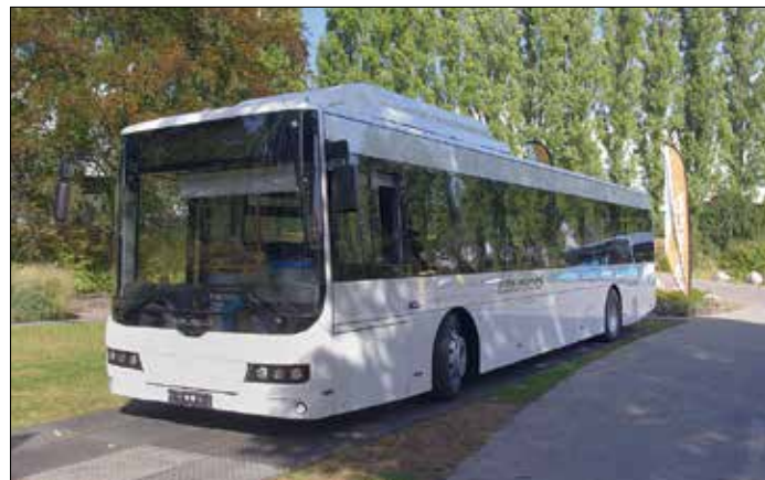
En annan till synes klassisk tolveters batteribuss på utställningen var Ebusco 2.2 i rostfri stål, med 300 kilometers uppgiven räckvidd.
