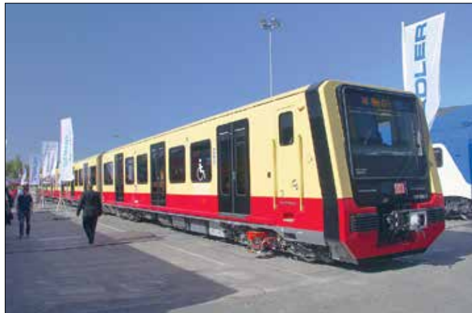
Nästa generations fordon för Berlins S-Bahn, BR 484, produceras av Stadler och Siemens i konsortium och har många drag av tunnelbane-tåg avseende dimensioner och acceleration med mera.
