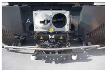
Kopplet på Cityval Rennes B, med texten "Schaku", således Scharfenbergkupplung. Under detta syns två snedställda styrhjul som griper om den centrala styrrälen. Tåget rullar på gummihjul. Här finns även elektrisk förbindelse mellan tåg och bana.
