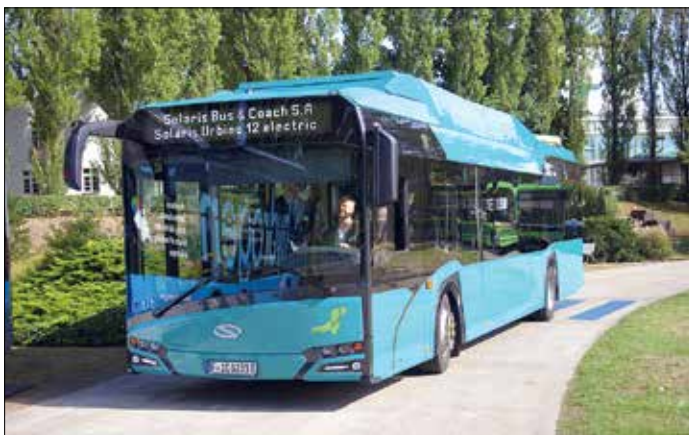
Solaris batteribuss Urbino 12 electric, med batterieffekt på 240 kWh, är en av fem som beställts för trafik i Frankfurt.
