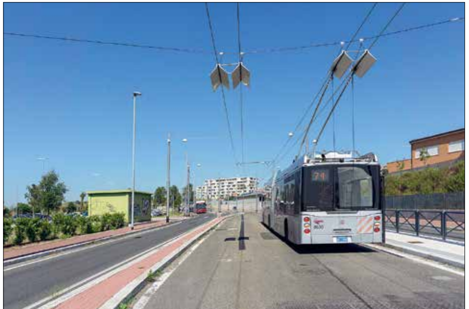
Ändhållplatsen för nya linje 74 vid via Brunetti. Bakom fotografens rygg vänder bussarna i dieseldrift. Notera "trattarna" i kontaktledningen där stömvagnarna återfår kontakt med ledningen. Ett mysterium är varför trattar har monterats i båda körriktningarna.
