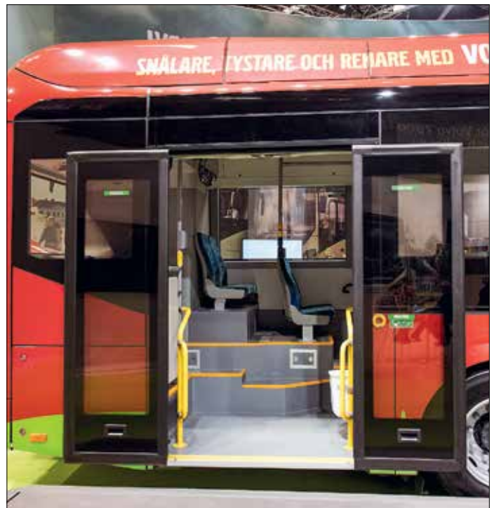
Lägre kapacitet i bussarna blir följderna av låga golv, rejält uppstickande hjulhus, delar av motorrummet inne i bussen, även andra lådor som tar plats och så vidare. Här krävs dessutom förmåga att klättra för att komma upp till sittplatserna.
