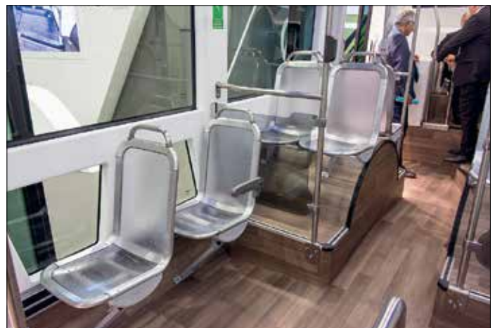
Konstig placering av sittplatser ovanpå höga hjulhus är numera standard i stadsbussar. Detta leder till begränsat antal sittplatser.
