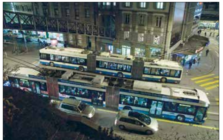
Två av trådbusslinjerna i Zürich körs sedan länge med dubbelledstrådbussar, tillverkade av Carrosserie Hess nära Bern. Tyst, snabbt och smidigt drar de 24 meter långa ekipagen iväg från hållplatserna.
