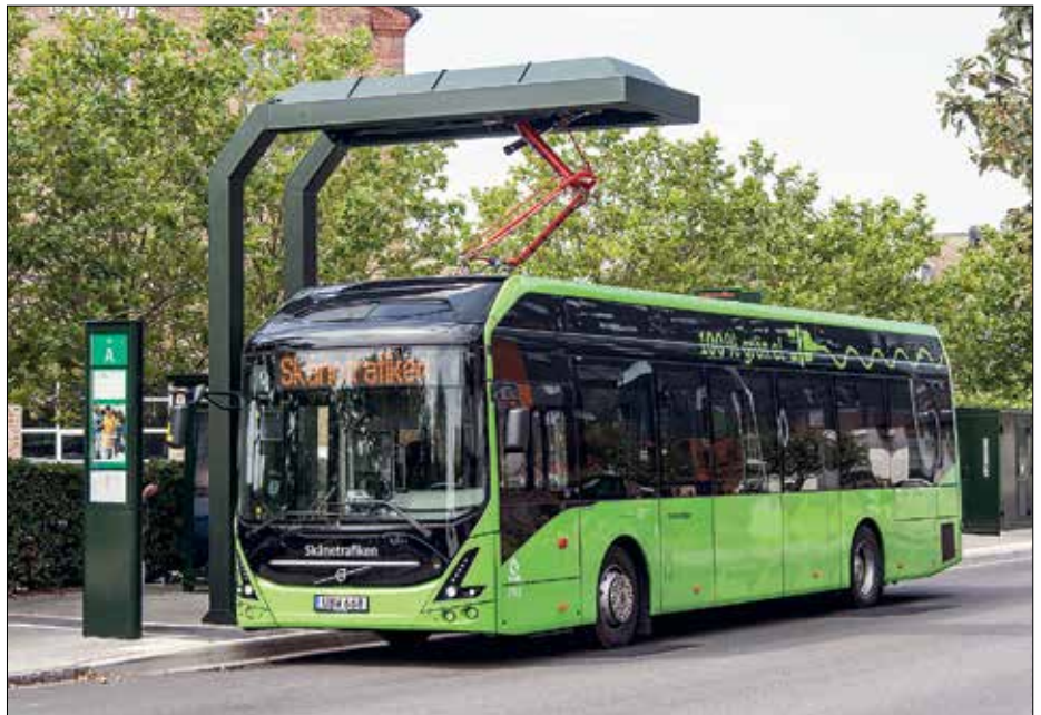
Batteribuss i Malmö laddar vid ändhållplatsen Ön.
