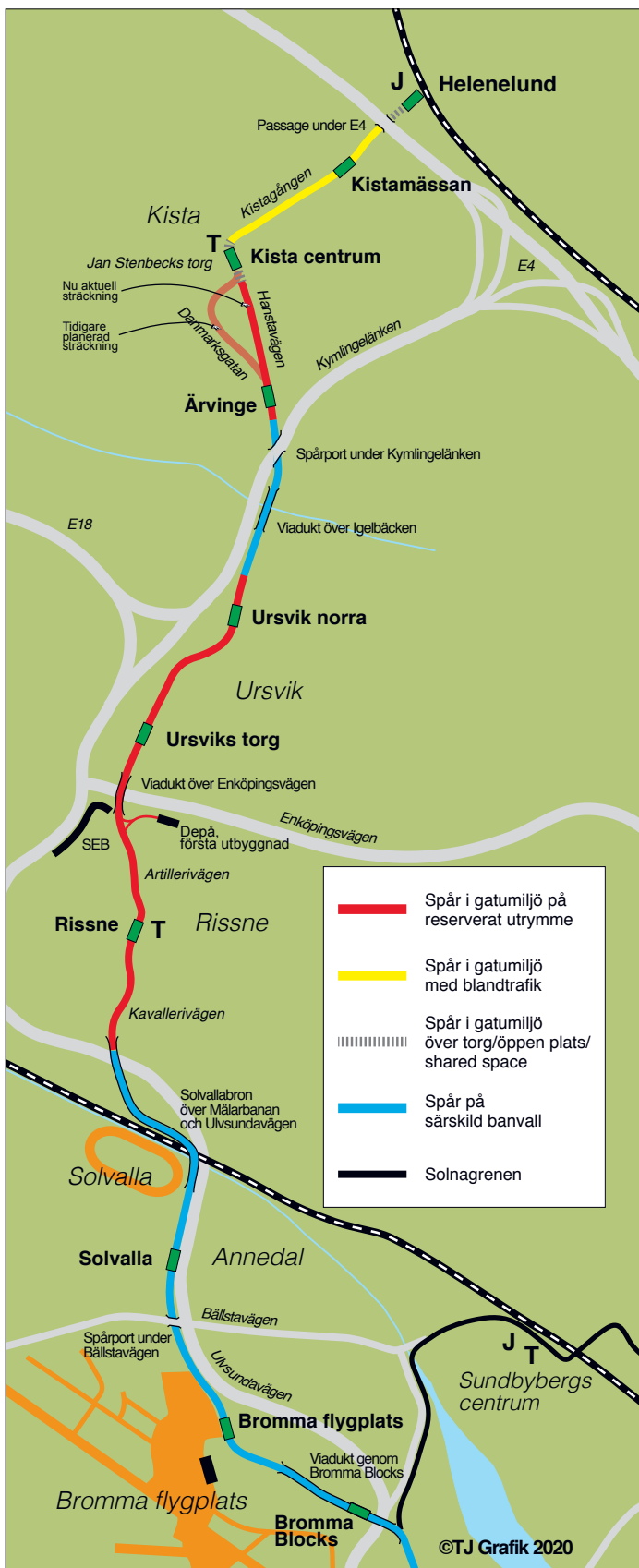
Karta över den omkring åtta kilometer långa Kistagrenen som viker av från Solnagrenen vid hållplats Norra Ulvsunda och går via bland annat Bromma flygplats, Solvalla, Rissne, Ursvik, Kista centrum till Helenehund. Karta visar även de olika anläggningstyper, "typologier", som är aktuella.
