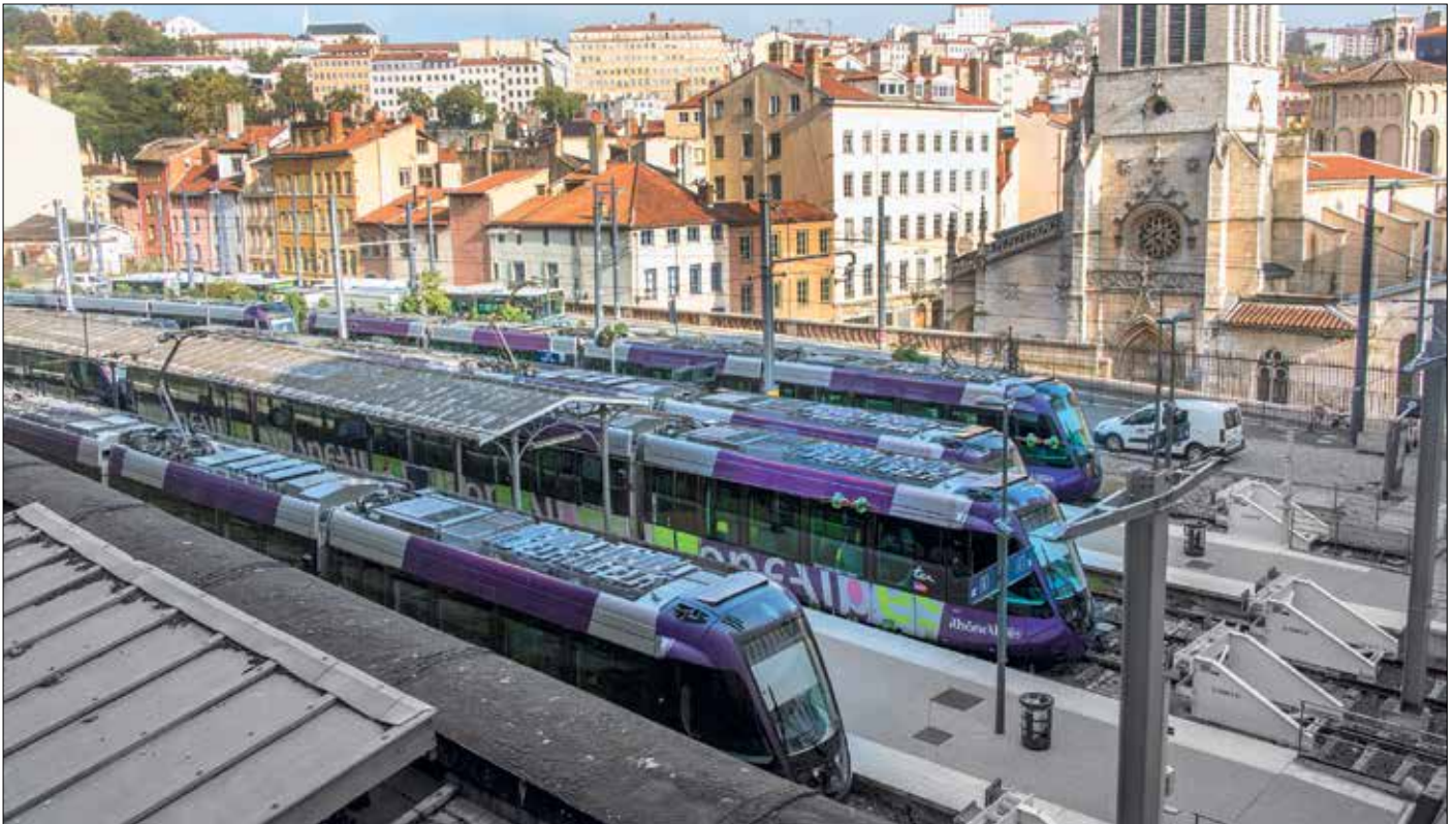
Tram-train de l'Ouest lyonnais är namnet på spårtrafiksystemet som utgår från järnvägsstationen Gare Saint-Paul i Lyon, där bilden är tagen, har en sammanlagd längd om 55 kilometer för tre linjegränar och betjänar 22 stationer. För trafiken finns 24 duospårvagnar av typ Alstom Dualis. Trafiken invigdes 2012.
