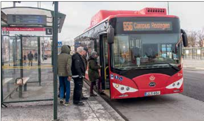
En av de fem batteribussarna som körs i SL-trafiken i Norrtälje. Tillverkad av företaget BYD i Kina, tjänstevikt 13,8 ton, totalvikt 18,6 ton, vilket innebär möjlig last om 4,8 ton, motsvarande 64 passagerare à 75 kg. Bussen är dock registrerad för 73 passagerare.
