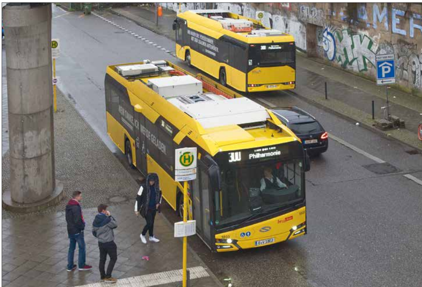
Två batteribussar på elbusslinje 300 i Berlin. Bussarna är tillverkade av Solaris och laddas i depån. Batteribusstrafiken i den tyska huvudstaden är ett prestigefyllt forsknings- och utvecklingsprojekt, med omfattande offentlig finansiering.
