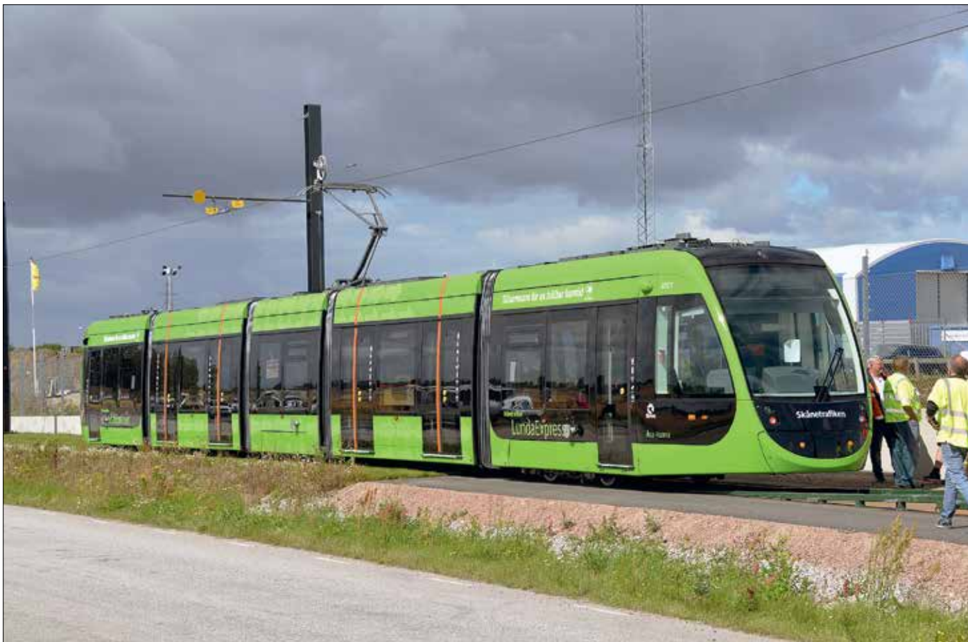
Åsa-Hanna är på spåret, kontaktledningens skyddsjordning är borttagen, spänning inkopplad och strömavtagaren uppfälld, varefter laddning av vagnens batterier påbörjas.
