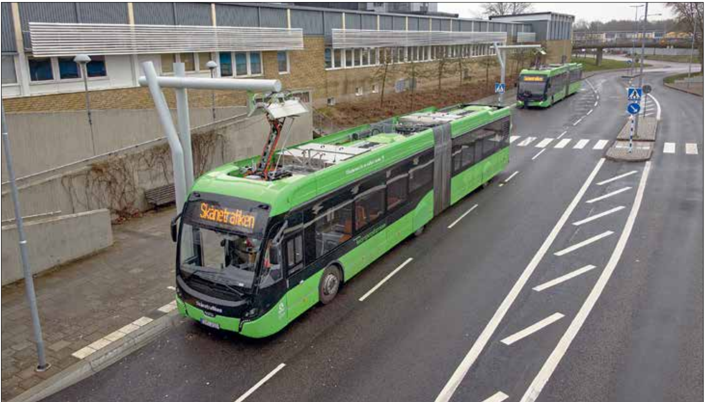
Ändhållplatsladdning av två batteri-ledbussar vid Dalhem i Helsingborg. Batteribusstrafiken på tidigare linje 1, numera Helsingborgsexpressen, startade för drygt ett år sedan.
