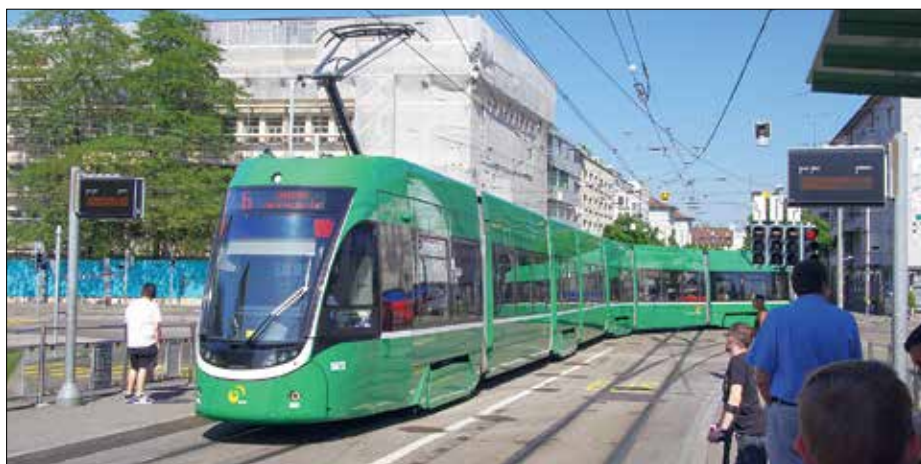
Bombardier Flexity 2 i Basel, marknadsförs även som Flexity Basel. Sammanlagt har 61 vagnar levererats från 2014: 17 stycken femdelade med 31,8 meters längd och 44 stycken sjudelade med 43,2 meters längd. Vagnsbredd är blygsamma 2,3 meter och de rullar förstås på meter-spår.
