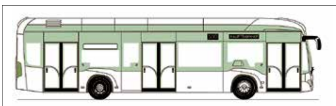
Den tredörrade versionen har dubbeldörr även bakom bakaxeln.
