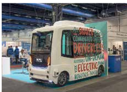
EasyMile EZ.10 är en självkörande minibuss med fyrhjulsstyrning och plats för 15 passagerare. Tjänstevikt 2,1 ton, 4,05 meter lång och 1,9 meter bred.
