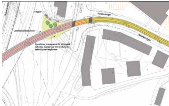
Anslutning av Solvallabron, till vänster, vid Rissneleden utformas som signalreglerad plankorsning. Kavallerivägen till höger får grässpår.
