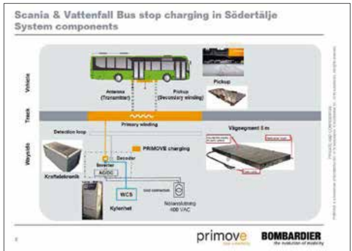
Principen för Primovesystemet så som det användes i Södertälje. Illustration ur rapporten från Energimyndigheten
