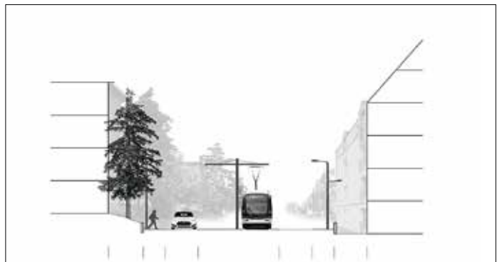
Här ett exempel på hur passagera illustrerats i examensarbetet. Varje passage mättes in för att kunna återges exakt i skala 1:100. Varje passage illustrerades även i gatusektion, för att skapa större förståelse hos läsaren. Här Rue du Poitou i Nantes.
