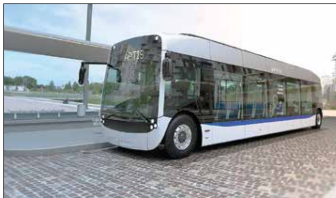
Alstom presenterade bilder och data om serieversionen av batteribussen Aptsis, se Modern Stadstrafik nr 3-2017. Serieversionen får andra strålkastare, plattare vindruta, ett tredje dörrpar och en tystare elmotor. Foto: Alstom
