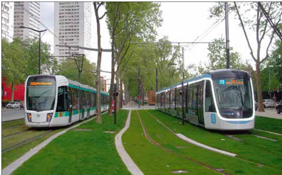
Vid ändhållplatsen Porte de Choisy, vid en av Paris tullar, finns anslutningar till spårvägslinje T3a och en gren av metrolinje 7. Linje T9 till höger och T3a till vänster. Notera skillnad i formspråk hos vagnar och kontaktledningsstolpar för T3 (2006) respektive T9 (2019).
