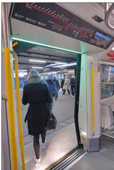
Till vänster: Ljusramp upptill vid dörrarna lyser grönt strax före öppning och i öppet läget. Strax före stängning och under stängning växlas till rött sken.
