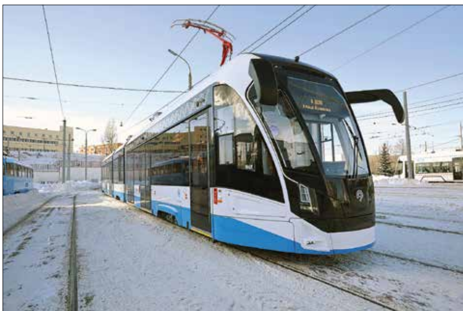
PK Transportnye Systemy levererar sammanlagt 204 vagnar av typen 71-931M till Moskva. Den senaste generationen har superkondensatorer för att minska energiförbrukningen, smalare växellådor så att interiören blir rymligare och förbättrat system för värme och kyla, samt förbättrad förarplats.
