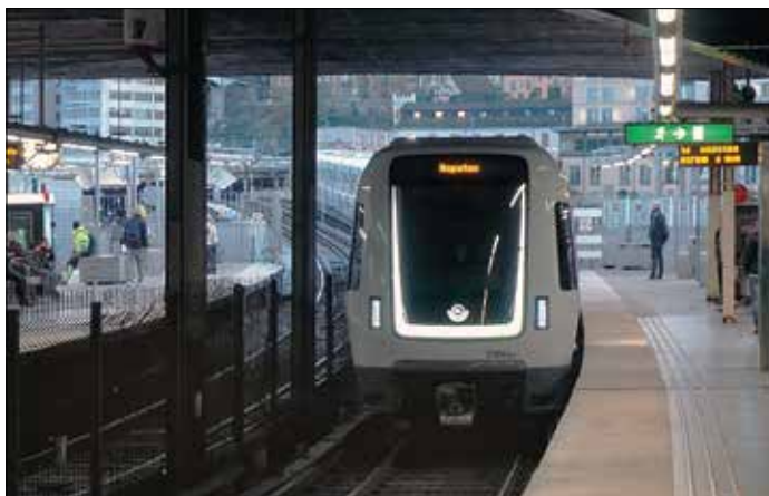
Runt gavelfönstren på C30 finns en ljusramp som visar vitt framåt och rött bakåt.
