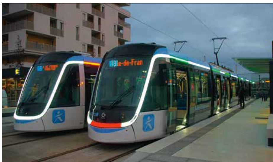
Ljuslinjen kan skifta färg: rött skiljer akterhytt från fronthytt, där linjen förblir vit. Vid hållplats blir vitt till grönt på plattformsidan, ovanför de åtta dubbeldörrarna på varje sida, eller rött när dörrarna stängs. Denna multiledspårvagnsmodell har således dubbeldörrar också närmast vagnsändarna!
