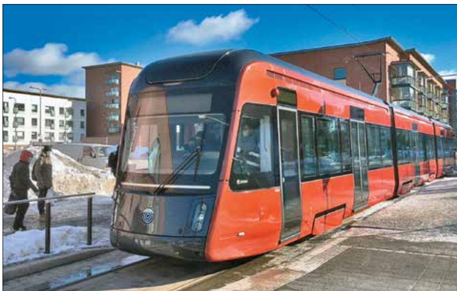
Provkörning med vagn TRO07, en av 19 spårvagnar som har levererats av Škoda Transtech. Spårvägen i Tammerfors byggs normalspårig (1 435 millimeter), till skillnad mot spårvägen i Helsingfors som har meterspår. Finska järnvägarna har spårvidden 1 524 millimeter.
