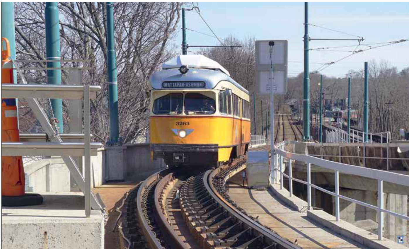
En PCC-vagn ankommer den norra ändhållplatsen i Ashmont, som är ändstation på en av den röda linjens södra grenar med konventionell tunnelbanetrafik. PCC-vagnen går i en kraftig stigning för att komma upp till den kombinerade av- och påstigningshållplatsen på T-banestationens övre plan. I markplanet, i bakgrunden till höger om spårvagnen i bilden, syns ett tunnelbanetag under vändning.
