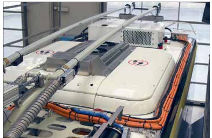
Strömavtagarna manövreras från förarplatsen och är en nykonstruktion från Kiepe Electric. Där återanslutning till trådnätet sker är riktanordningar, "trattar" monterade, vilka leder strömavtagarna rätt den sista dryga decimetern av uppfällningsförloppet.
