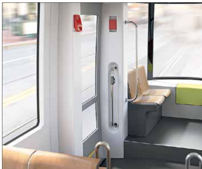
Längst bak är golvet upphöjt, med en avdelning med sidåkarplatser. Sista dörren är en enkeldörr. Bild:VBZ
