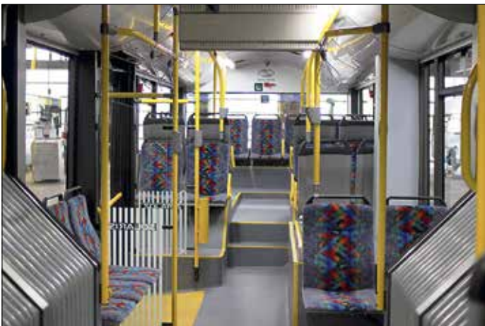
Batterierna, som består av fyra sätser à 15 kW, är monterade baktill under golvet i ledbussen. Därför är golvet rejält upphöjt. Två steg leder upp till den högre golvnivån. Passagerarutrymmet är här arrangerat i så kallad konferenssittning.
