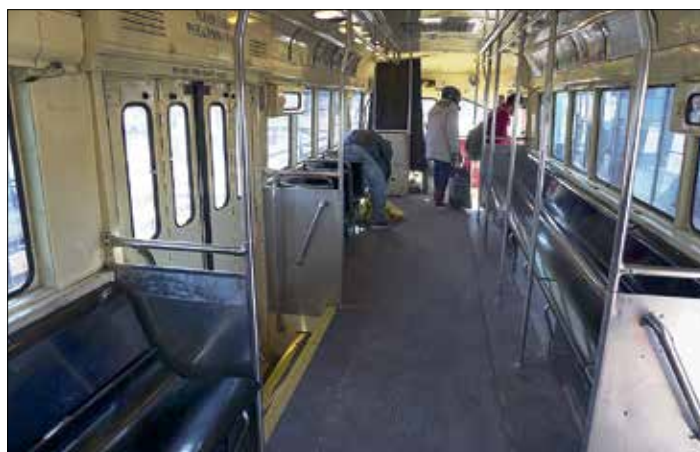
Interiör i en PCC-vagn. Notera dörrarna på bägge sidor. Bostons PCC-vagnar hade, trots att de alla var enriktningvagnar, dörrar på bägge sidor för att kunna gå i spårvägsnätets tunnelstäckor (nu Gröna Linjen) med många mittplattformar. Metropol- och Capitolbusstilen känns igen.
