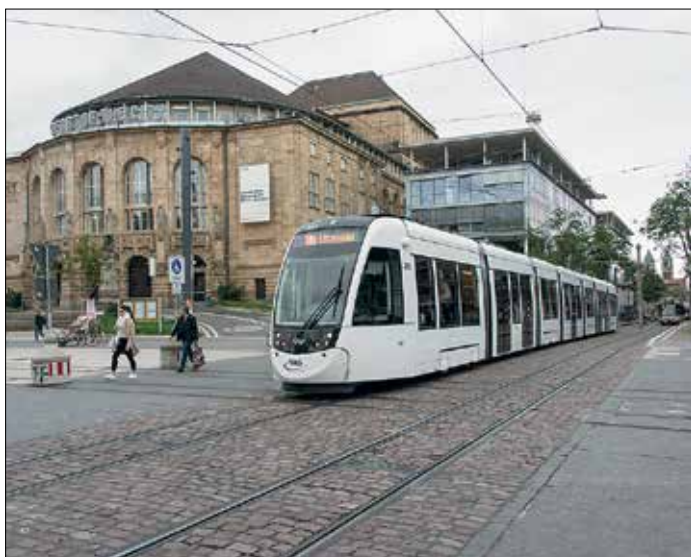
Ny CAF Urbos-spårvagn i Freiburg i Tyskland passerar Rotteckring med nylagda korsande spårvägsspår, men ännu utan kontaktledning. Ordern omfattar sammanlagt 12 stycken 42-metersvagnar, i bredd 2,3 meter.
