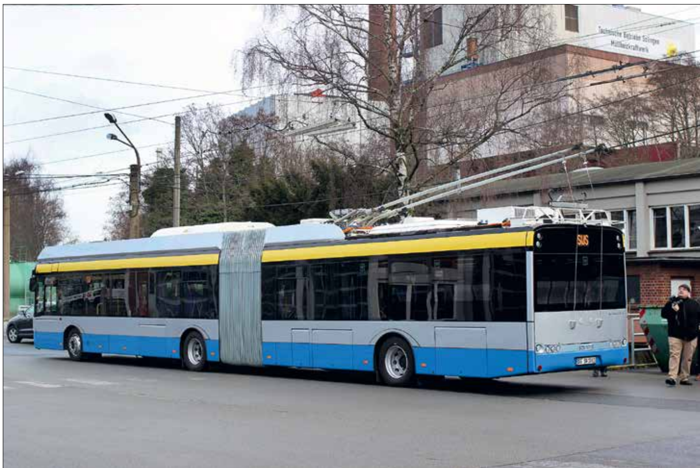
Snabbsänkning av strömavtagarna demonstreras vid förevisningen av den nya bussen. Det finns två drivmotorer på vardera 160 kW, sammanlagt 320 kW. Motorerna driver axel 2 och 3. Prislappen för en batteritrådbuss i detta utförande visar 900 000 euro. Bussen väger 19,4 ton i tjänstevikt och kan ta 115 passagerare, totalvikt 28 ton.
