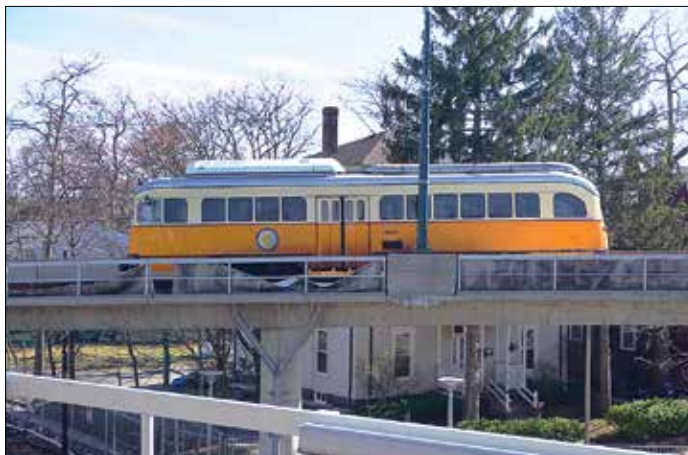
Avgång från ändhållplatsen i Ashmont. Notera dörren på vagnens vänstersida. Upphöjningen på vagnens framsida är resultatet av en tidigare renovering; de gamla PCC-vagnarna fick då luftkonditionering vilket kan vara bra med tanke på Bostons varma somrar.
