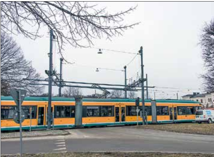
Norrköpings spårvagnar har sedan 2007 en anordning som är tämligen unik i spårvägsvärlden: en kontaktledningslyft, placerad i Drottninggatan just före kurvan vid centralstationen. Här i nedfällt läge.
