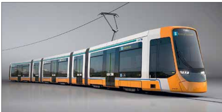
Darmstadt får inom kort leverans av denna spårvagnsmodell som är en uppdaterad version av Stadlers Tramlinkfamilj. Notera tre vagnskorgar, vardera på två boggier. Vagnskorgarna sammanfogas med korta hängande led. Originellt! Bild: Heag Mobil
