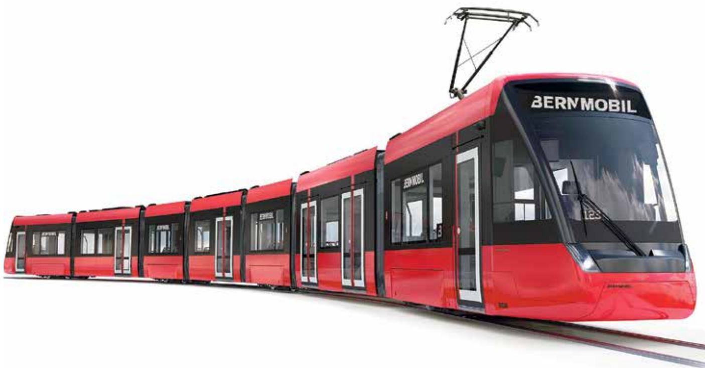
Stadler Rail ska leverera 20 meterspåriga tväriktnings- och sju enriktningssvagnar av modell Tramlink till den schweiziska huvudstaden Bern. Vagnarna blir 42,5 meter långa och 2,30 meter breda. De får sex motorer à 105 kW och ska klara kurvor ned till 16,5 meters radie. Bild: Bernmobil
