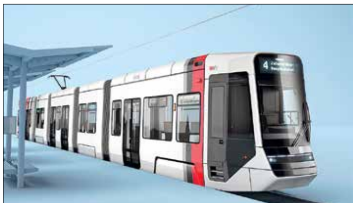
Detta är HeiterBlicks nya utseende på spårvagnarna som ska levereras till Würzburg. De har 70 procent lågt golv och är en låggolvsvariant av Vamosmodellen. Bild: HeiterBlick
