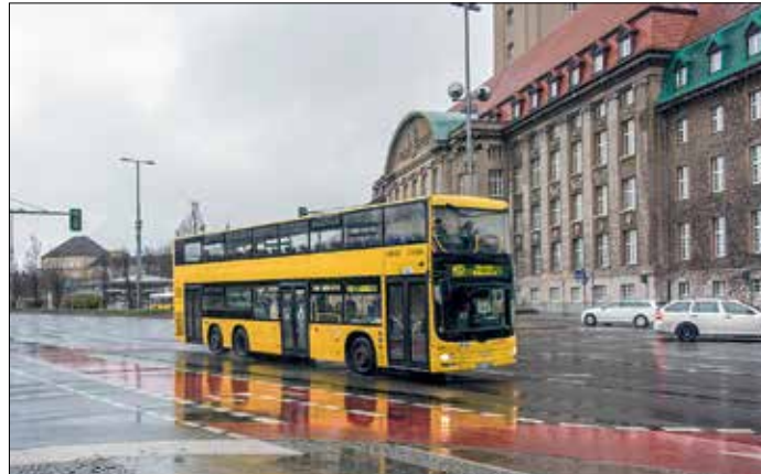
I utredningen diskuteras möjligheten att introducera dubbeldäckade hybridtrådbussar. Kanske måste då kontaktledningen monteras högre över körbanan än vid enbart enkeldäckade bussar.
