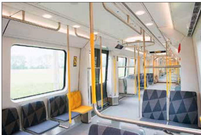
I tunnelvagnsprojektet, C30, har Idesign utvecklat bland annat interiör med färgsättning och stolar med ny textil. Markbeläggningen på Sergels torg ("Plattan") är inspiration till mönstret på stolarna.
