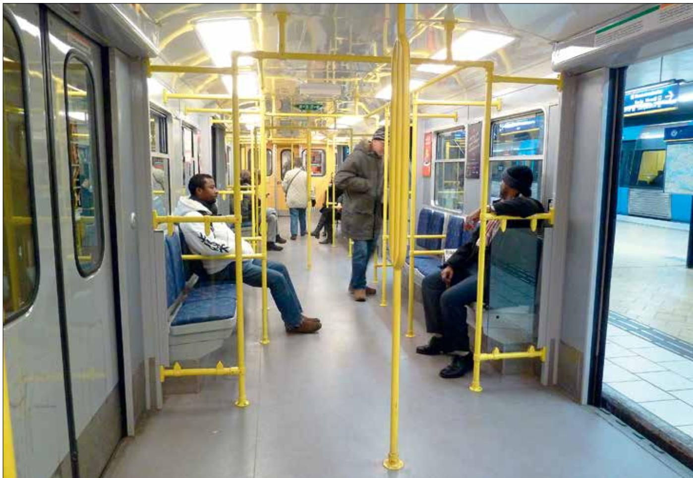
Ståplatsvagnar i Stockholms tunnelbana. Det är stor risk att sittande får stående på tårna. Men det är gott om hållstöttor, notera särskilt den utgrenade mittstången på plattformen närmast.
