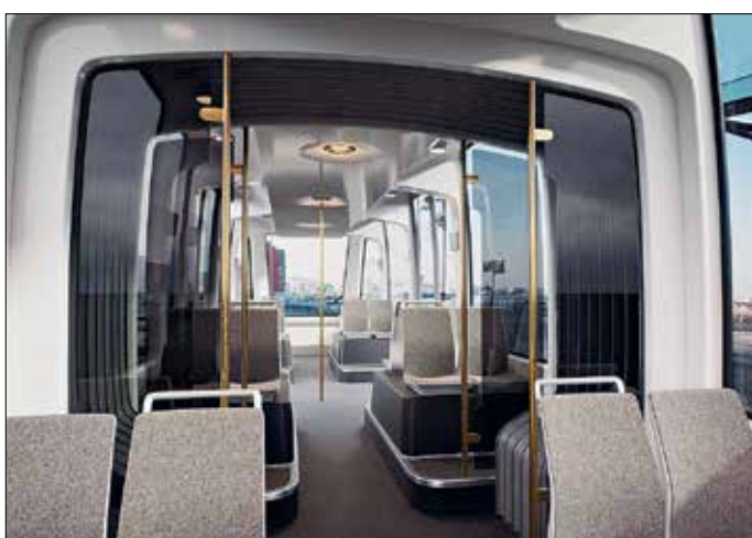
För interiörer i spårvagnsprojektet studeras effekter av olika stolstyger, diverse belysningstyper och varierande kontrastfärger. Också stolar med olika ryggstödshöjder kan bedömas.
