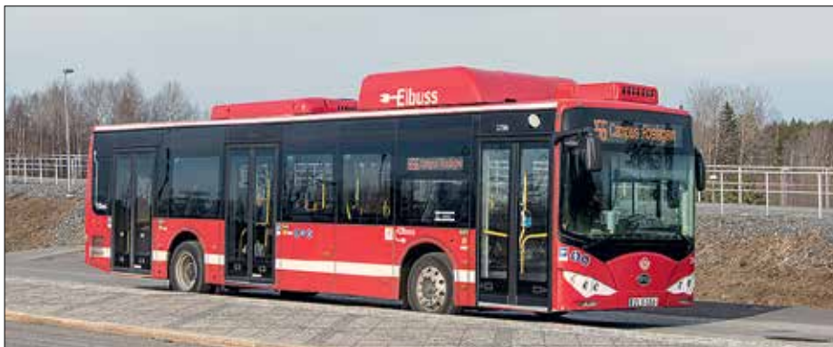
Aktuell för tio av innerstadens "röda" linjer: depåladdad batteribuss, här i SL-trafik i Norrtälje. Bussens tjänstevikt är 13,8 ton.
