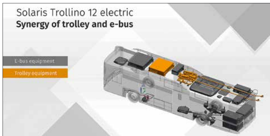
Principen för uppbyggnad av batteritrådbussar, grått visar utrustningen som ingår i en batteribuss, orange det som tillkommer för att kunna ladda under färd.
