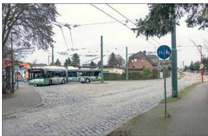
Ändhållplatsen för linje 862 i Ostend har en äkta vändslinga. Övriga ändhållplatser på trådbusslinjerna har utdragna slingor runt stora kvarter. Gatstenen gör gatan mycket ojämn och resan synnerligen skumpig.
