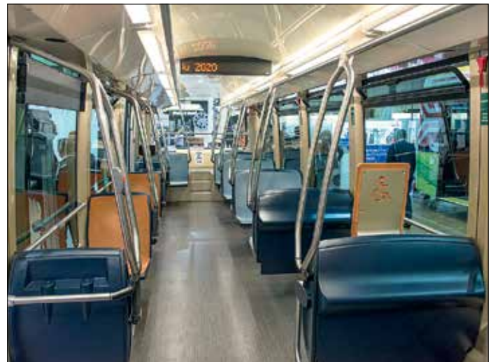
Interiör i Aptis. Första leveranser sker nu till Strasbourg. Det går att få bussen med tre dubbeldörrar. Lågt golv utom längst bak där några steg leder upp till plattformen.
