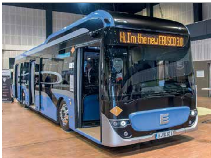
Alldeles nya Ebusco 3.0 väger endast 8,5 ton för tolv meters längd. Kunskap från flygindustrin (Fokker) har utnyttjats beträffande komposittekniken. Batterierna är integrerade i golvet.
