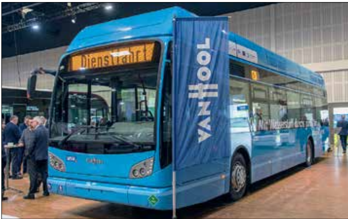
I den kuperade staden Wuppertal skulle det inte fungera med batteribussar. I stället kommer nu 30 bränslecellsbusar från Van Hool i trafik.
