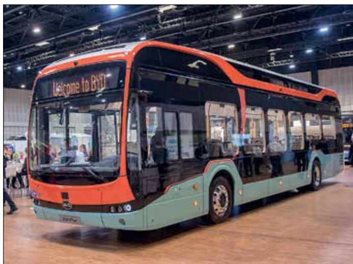
Kinesiska BYD (Build Your Dreams) visade en av de senaste batteribussmodellerna. Bussarna har litiumjärnfosfatbatterier med högt energiinnehåll för att klara en hel dags linjetrafik.
