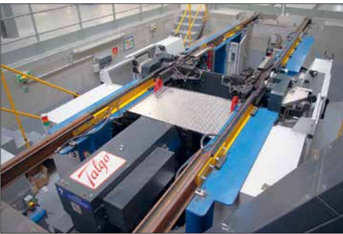
Hjulsvårerna från Talgo som vagnarna besöker var 15 000:e kilometer.
