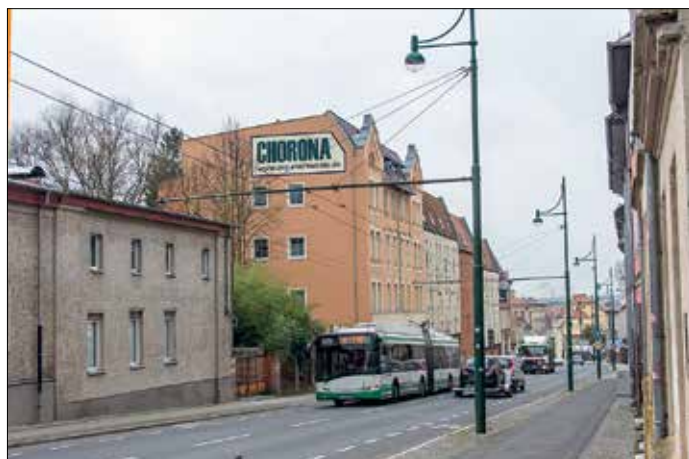
Vägen från centrum i riktning Ostend och Südend är tämligen brant och har trådbussledning. Det passar bra för kommande batteritrådbusslinje 910 som här kan köra med matning från tråd.
