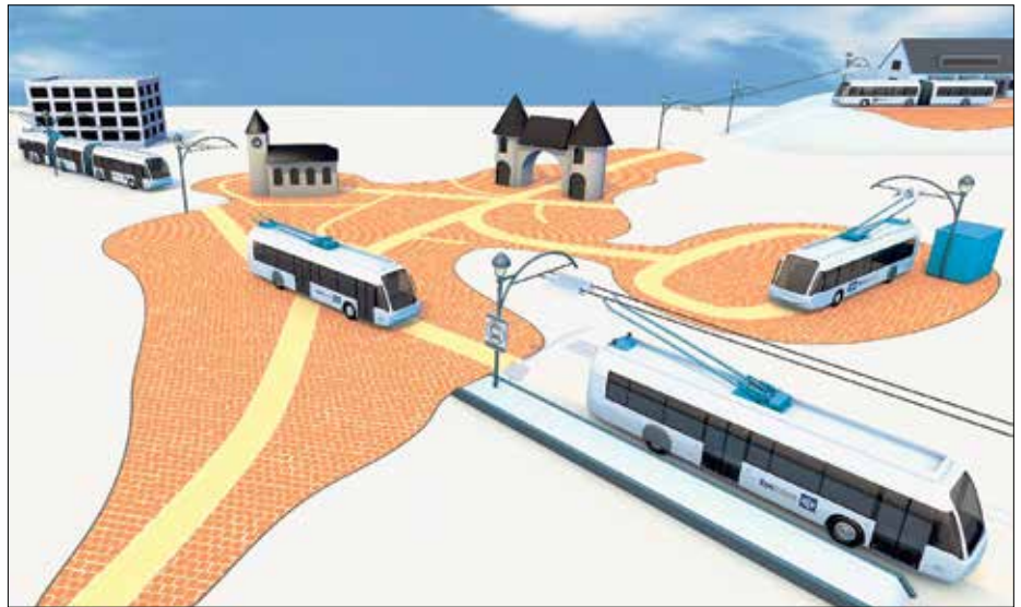
Med IMC kan man utelämnat kontaktledning där den inte behövs, eller av estetiska skäl bedöms vara olämplig. Illustration: Kiepe Electric/Knorr-Bremse
