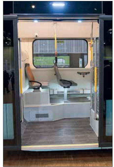
BYD:s batteribuss kräver ett jättekliv upp till sittplatserna på vänster sida längst bak. Batterier ockuperar utrymmet längst bak.
