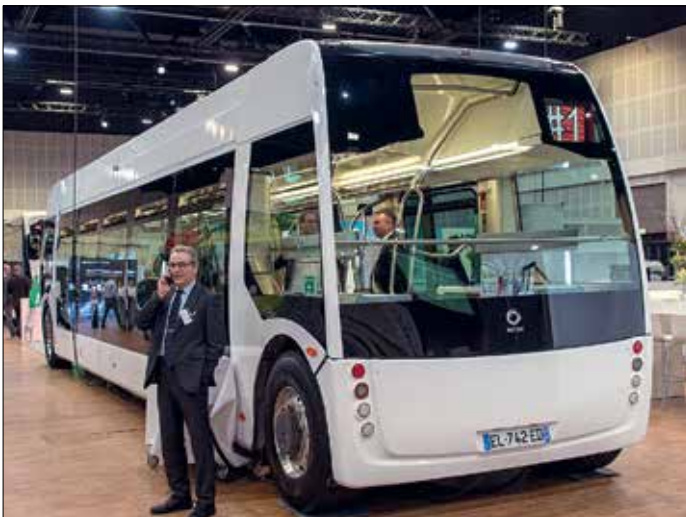
Alstoms batteribuss Aptis har fyrhjulsstyrning med ett hjul varje hörn. Påminner om principen för "Travolator" från DAB-Silkeborg från 1990-talet. Det kan vara svårt att skilja mellan bussens för och akter.
