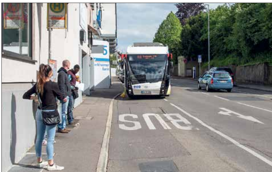
... därefter körs en slinga i grannorten Berkheim, i batteridrift. Återfärden till Esslingen, i oavbruten nedförbacke, sker också i batteridrift. Någon kilometer före ändhållplatsen vid stationen ansluts åter till kontaktledningen.
