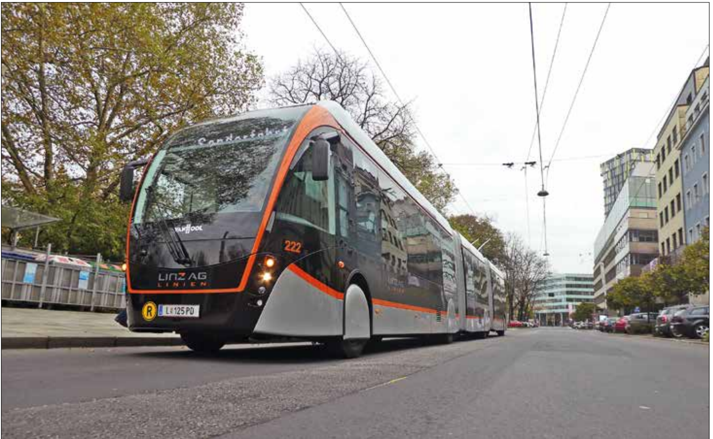
Exquicity för Linz är helelektrisk med batteri (20 kWh) för rangering på depån och körning i trafik på en 2,4 km lång, ännu oelektrifierad sträcka. Här ser vi bussen i en stilstudie i centrala Linz.
