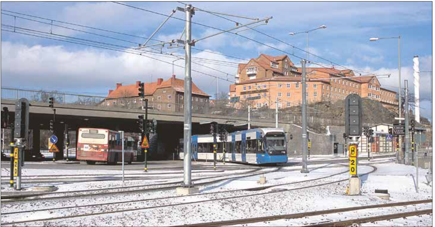
Nära spårporten under Södertäljevägen finns skyltar som anger att spårvagnarna på Tvärbanan lämnar signalreglerad sträcka och på den följande gatusträckan ska framföras med siktkörning.
