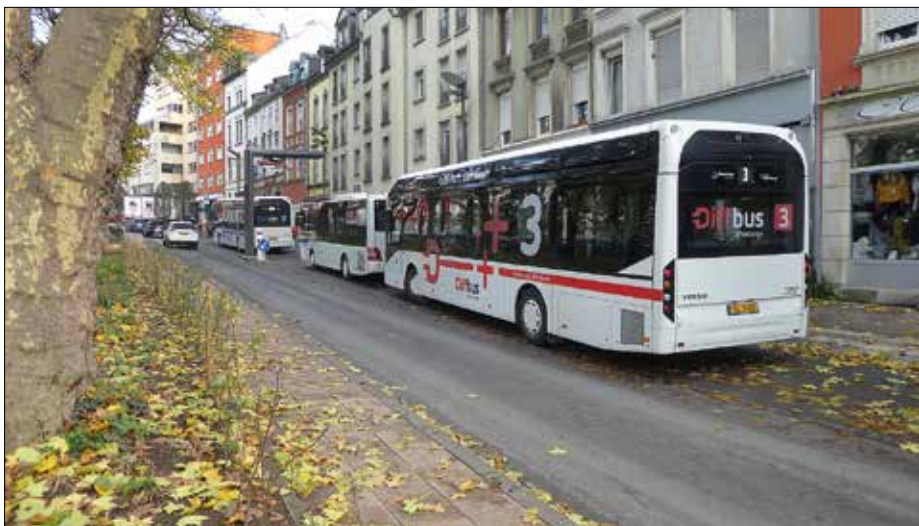
Köbildning vid laddstationen Parc Gerlache som fick till följd att bussen på linje 3, närmast, inte kunde ladda före avgång.
