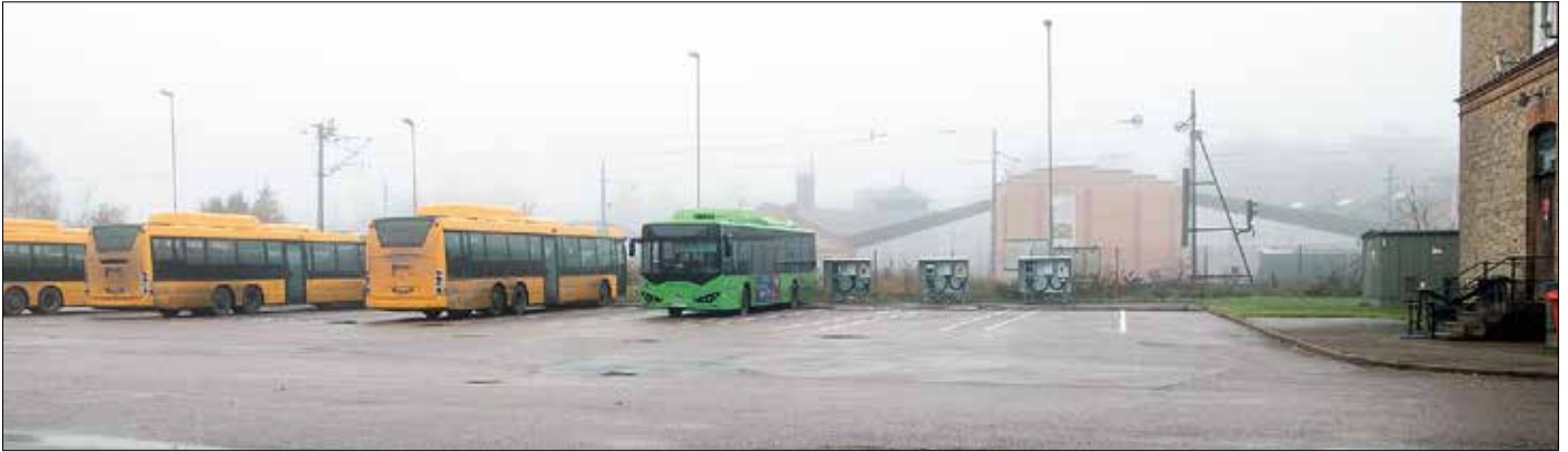
Batteribussarna laddas nattetid i depån invid järnvägsstationen i Ängelholm. Varje buss laddas dock även dagtid i depån mellan 2,5 och 3,5 timmar.
