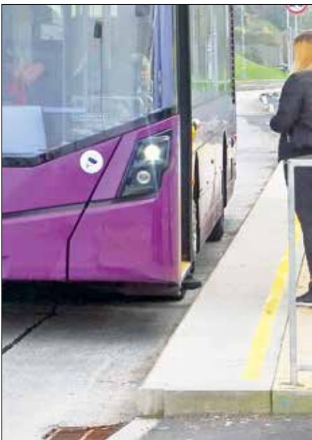
Styrrullarna kommer till nytta även vid angöring av hållplats. Här, efter hållplatsen Tyldesley, lämnar linje V2 bussbanan.
