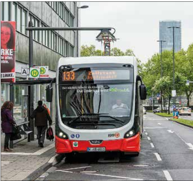
Batteribuss med uppfälld laddarm, här vid ändhållplatsen nära centralstationen.
