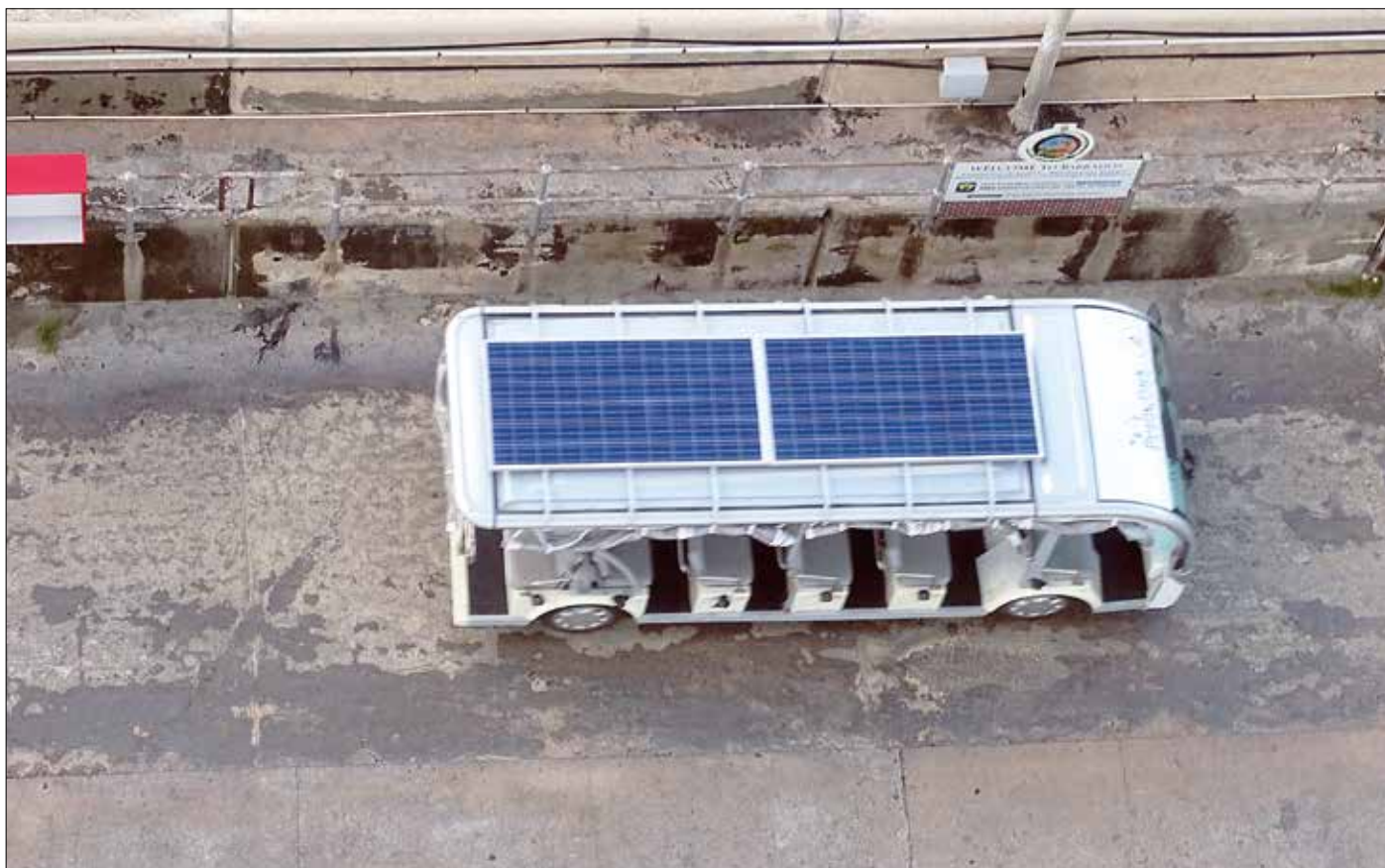
En av batteribussarna på kajen i Bridgetown, med solpaneler på taket. Mulet vid fototillfället i oftast soliga Karibien.
