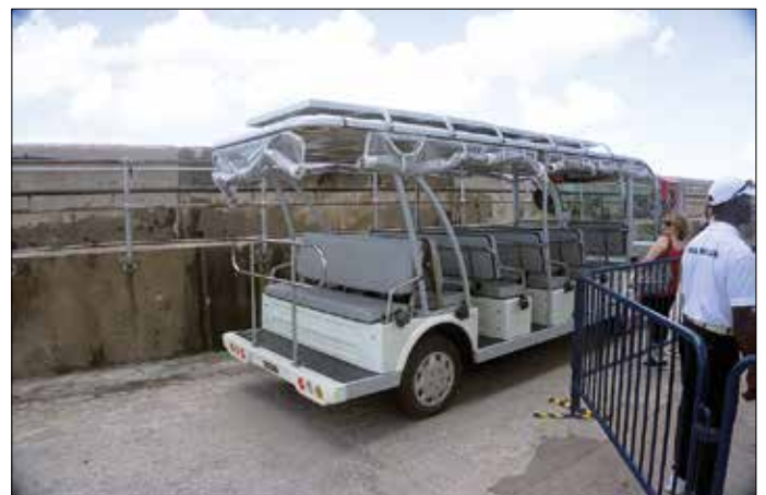
Batteribuss framkörd för att lasta kryssningspassagerare. Man kan ana solpanelerna på busstaket.
