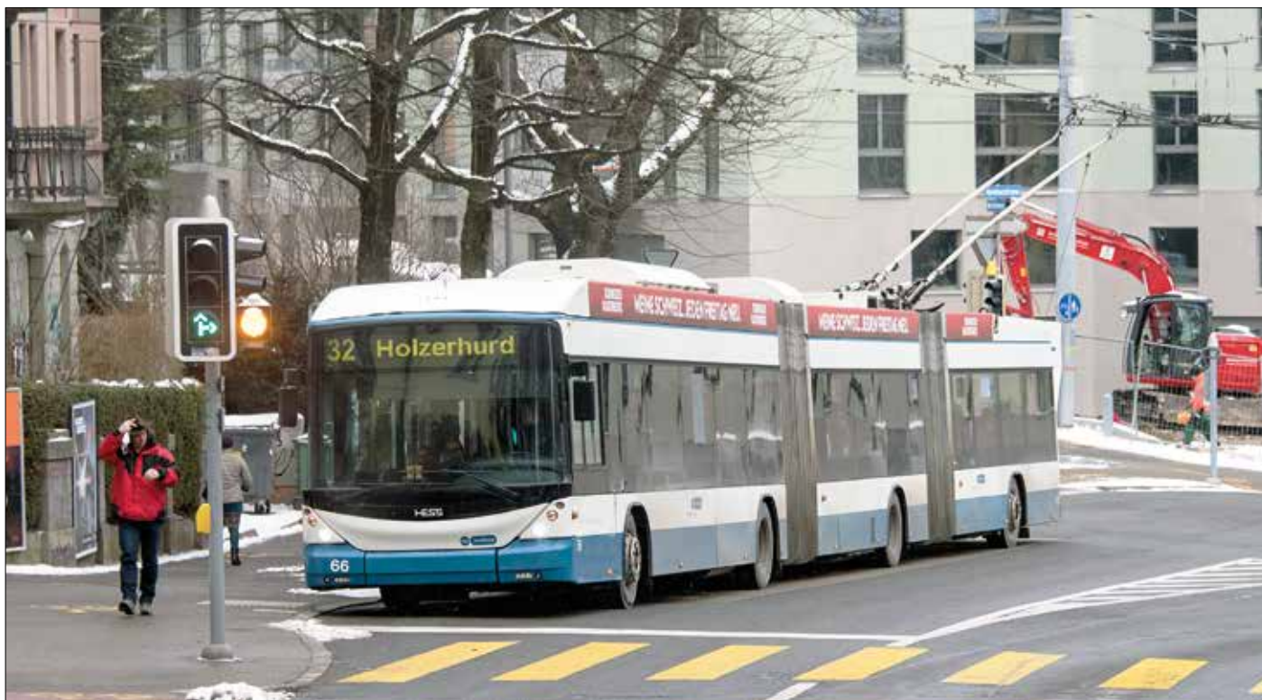
För närvarande finns 70 trådbussar för trafik i Zürich, alla är av typ Swisstrolley. Av dessa är 31 dubbelledbussar av denna modell. Också här sker drivning på axel 2 och 3, den fjärde axeln är styrd.
