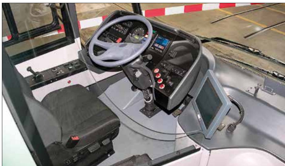
Förarplatsen i nya Swisstrolley Plus är utformad enligt riktlinjerna i de tyska föreskrifterna hos kollektivtrafikorganisationen VDV.
