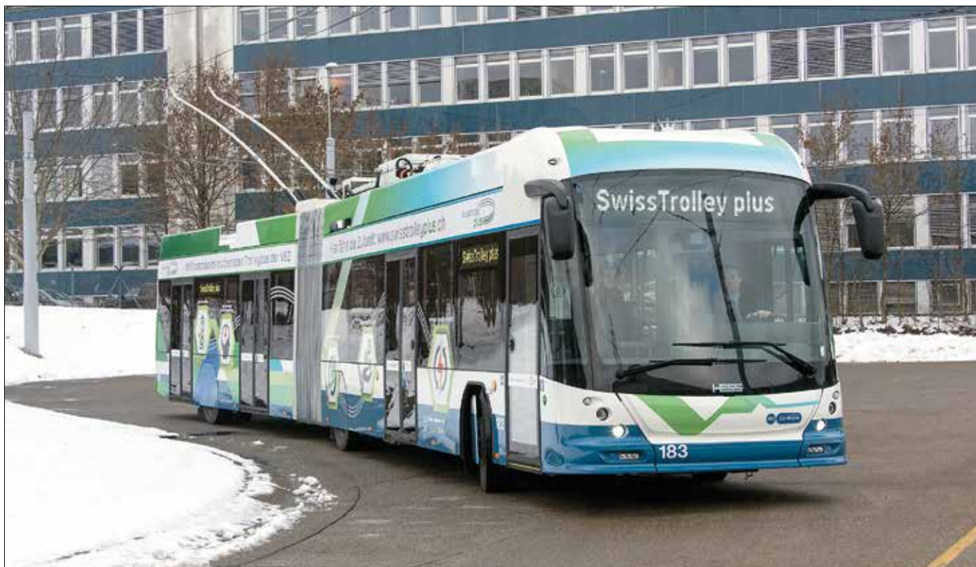
Swisstrolley plus är i grunden en klassisk 18,7 meter lång ledtrådbuss, byggd i aluminium enligt Carrosserie Hess koncept Co-Bolt, helt i låg-golvsutförande, med "fransk" front. Den elektriska utrustningen kommer från ABB.
